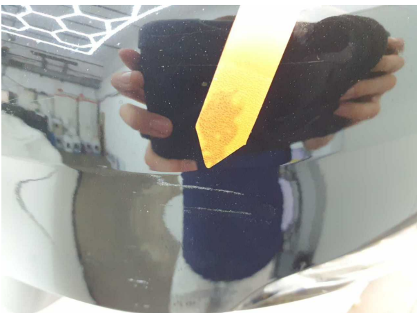
Beschädigung #3: Außenspiegel links: Abdeckkappe - Kratzer - Smart Repair
