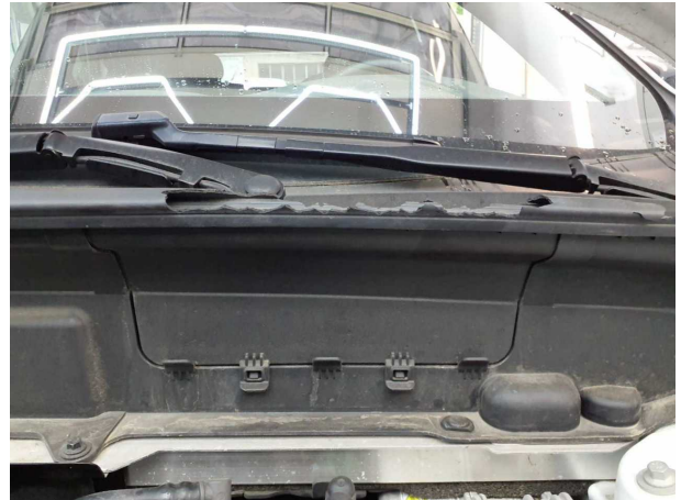
Beschädigung #4: Motor: Motorverkleidung (Dichtung) - beschädigt - erneuern
