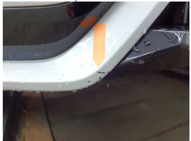
Beschädigung #9: Stossfänger vorn: Stossfänger vorn - Kratzer - Smart Repair
