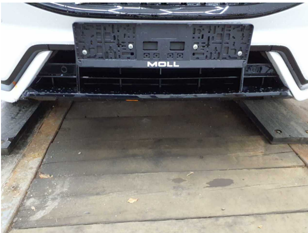
Beschädigung #11: Stossfänger vorn: Spoiler - Kratzer - Smart Repair
