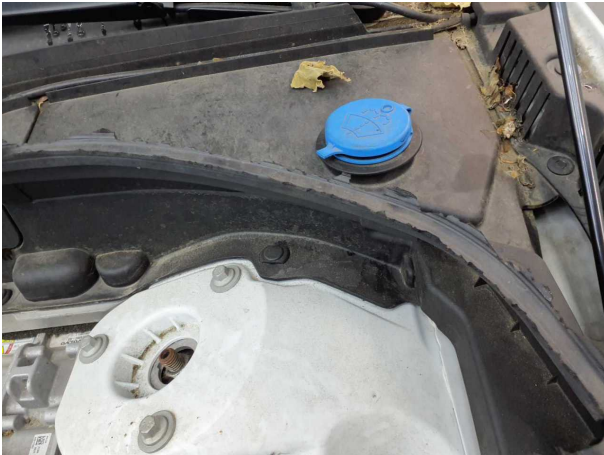
Beschädigung #4: Motor: Motorverkleidung (Dichtung) - beschädigt - erneuern
