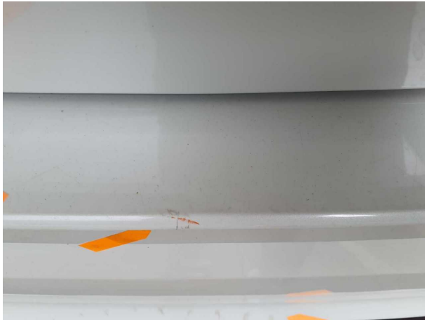
Beschädigung #7: Stossfänger hinten: Abdeckung Stossfänger hinten - Kratzer - Smart Repair
