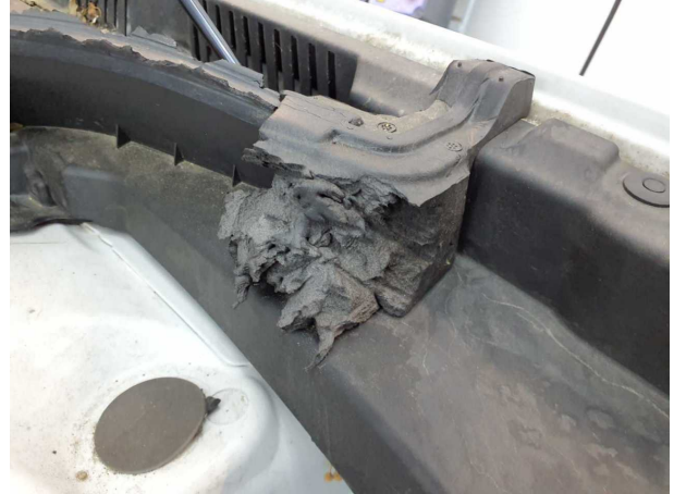
Beschädigung #1: Motor: Motorabdeckung (Füllstoff links) - beschädigt - erneuern
