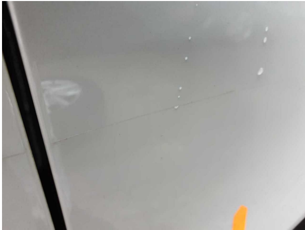
Beschädigung #5: Kotflügel rechts: Kotflügel rechts - Kratzer - Smart Repair
