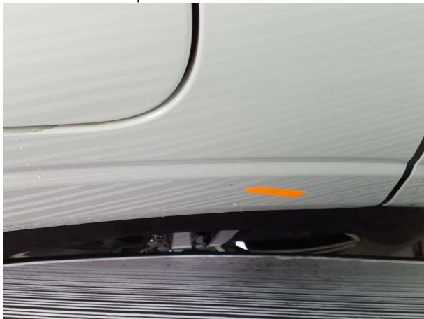
Beschädigung #8: Seitenwand rechts: Seitenwand - Delle / Lackschaden - Smart Repair
