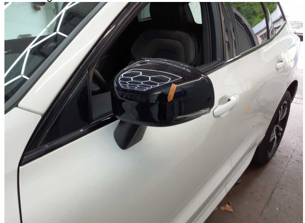
Beschädigung #3: Außenspiegel links: Abdeckkappe - Kratzer - Smart Repair
