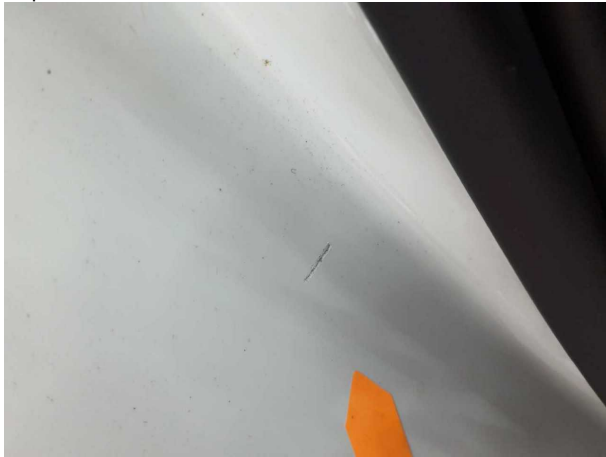
Beschädigung #6: Schweller rechts: Einstieg - Kratzer - Smart Repair
