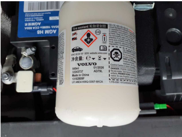
Beschädigung #2: Ausrüstung: Tirefit Füllmittel - abgelaufen - erneuern
