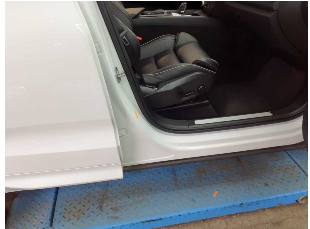
Beschädigung #6: Schweller rechts: Einstieg - Kratzer - Smart Repair
