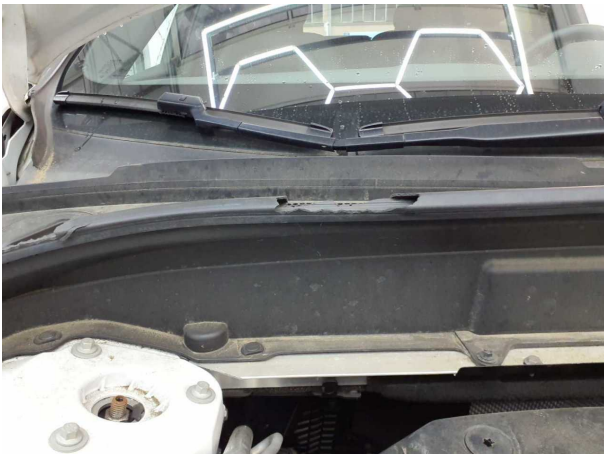
Beschädigung #4: Motor: Motorverkleidung (Dichtung) - beschädigt - erneuern
