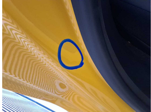
Beschädigung #1: Tür hinten rechts: Tür - Delle(n) - sanft instandsetzen
