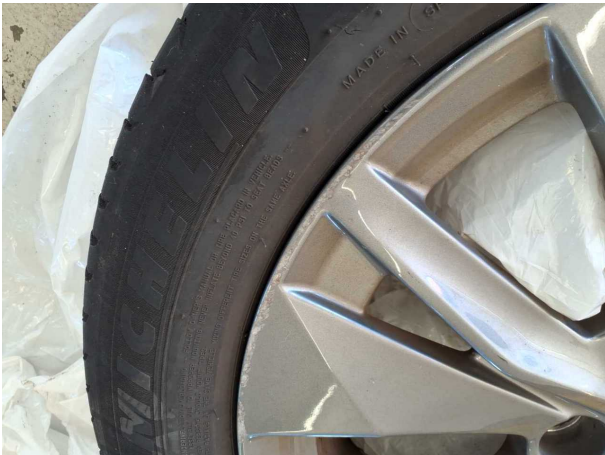
Beschädigung #2: 2.Radsatz: 1 Leichtmetallfelge - verkratzt / verschürft - Wertminderung
