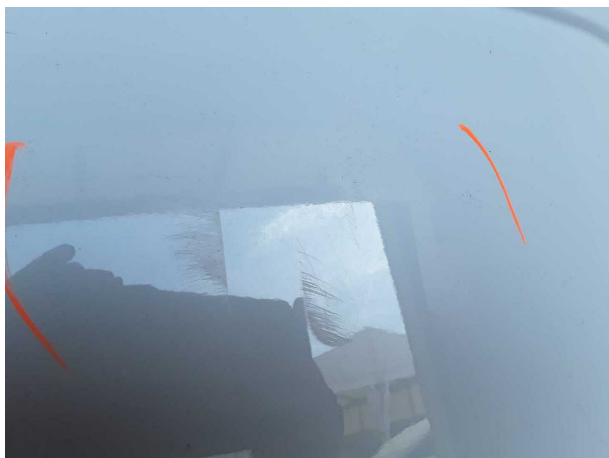
Beschädigung #15: Heckklappe/-tür: Hecktür rechts (Innen) - Delle (... instandsetzen und lackieren
