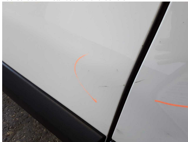
Beschädigung #16: Schiebetür rechts: Schiebetür - Delle / Lackschaden - instandsetzen und lackieren
