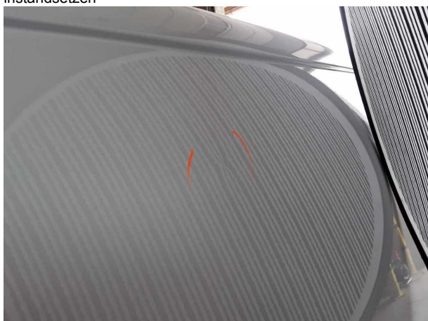
Beschädigung #1: Seitenwand links: Seitenwand - Delle(n) - sanft instandsetzen
