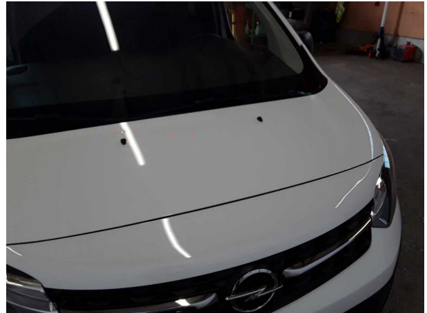
Beschädigung #4: Motorhaube: Motorhaube - Delle(n) - sanft instandsetzen
