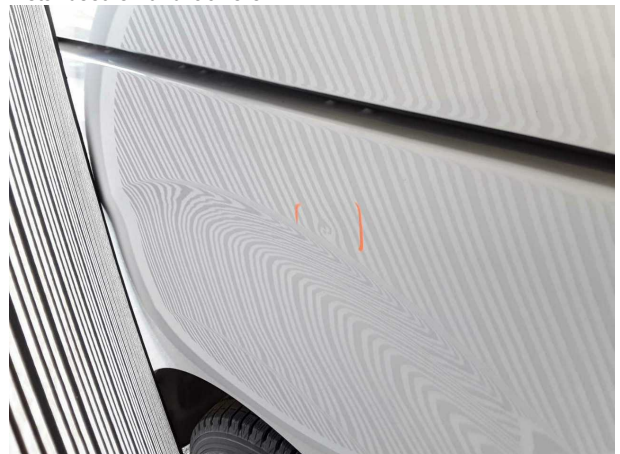
Beschädigung #18: Seitenwand rechts: Seitenwand - Delle / Lackschaden - instandsetzen und lackieren
