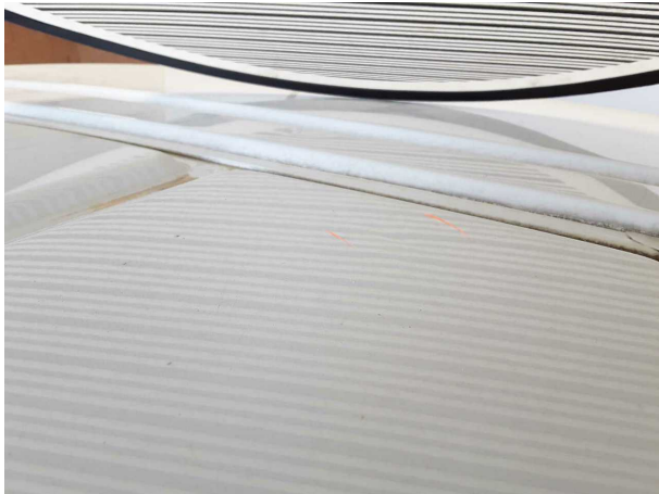
Beschädigung #3: Fahrzeugdach: Dach (Beulen) - Delle(n) - sanft instandsetzen
