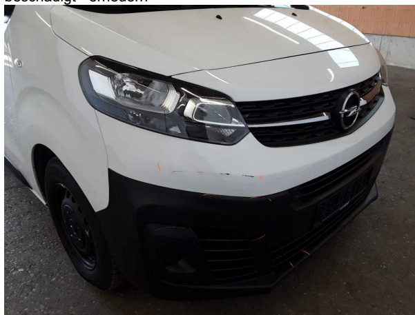
Beschädigung #11: Stossfänger vorn: Stossfänger vorn - verkratzt / verschürft - Smart Repair
