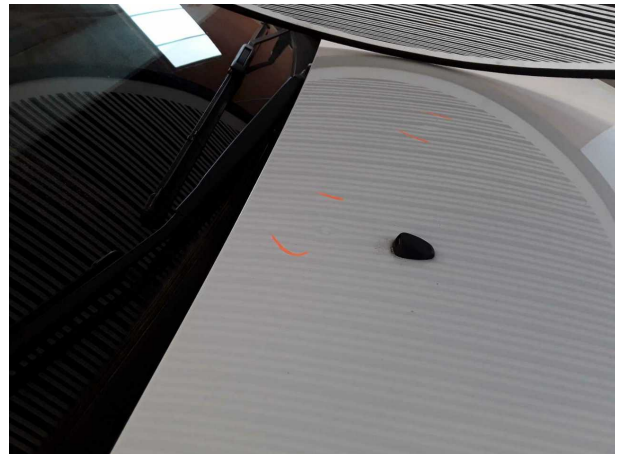
Beschädigung #4: Motorhaube: Motorhaube - Delle(n) - sanft instandsetzen
