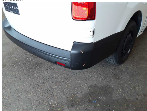
Beschädigung #7: Stossfänger hinten: Stossfänger hinten (unlackiert) - verkratzt / verschürft - Wertminderung
