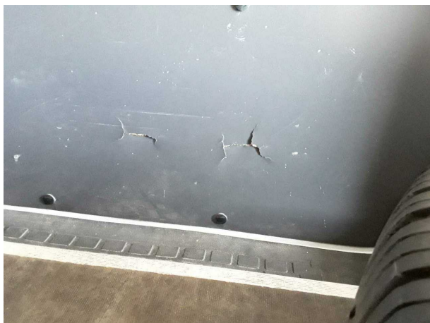
Beschädigung #9: Schiebetür rechts: Verkleidung - beschädigt - erneuern
