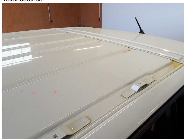
Beschädigung #3: Fahrzeugdach: Dach (Beulen) - Delle(n) - sanft instandsetzen
