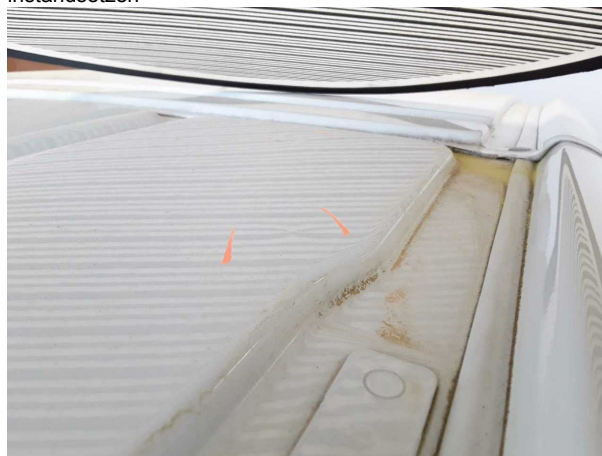
Beschädigung #3: Fahrzeugdach: Dach (Beulen) - Delle(n) - sanft instandsetzen
