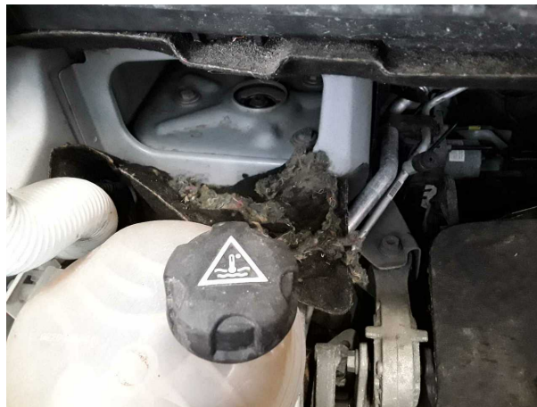
Beschädigung #6: Fahrerhaus: Dämmmatte - beschädigt - erneuern
