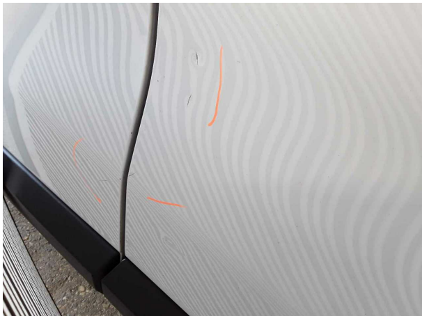
Beschädigung #17: Tür vorn rechts: Tür - Delle / Lackschaden - instandsetzen und lackieren
