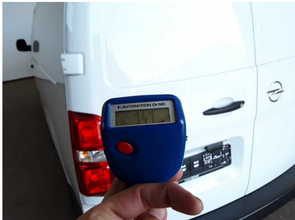
Nachlackierung 1: Heckklappe/-tür, Seitenwand links
