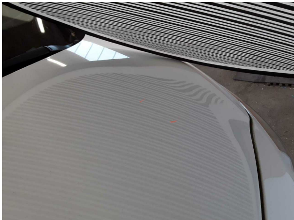
Beschädigung #4: Motorhaube: Motorhaube - Delle(n) - sanft instandsetzen
