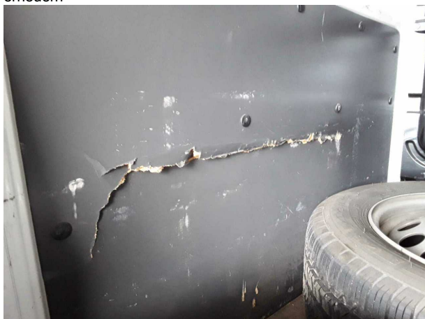
Beschädigung #10: Seitenwand links: Innenverkleidung - beschädigt - erneuern
