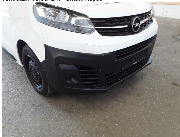
Beschädigung #12: Stossfänger vorn: Stossfänger vorn (unlackiert) (Verformt und verkratzt) - beschädigt - erneuern
