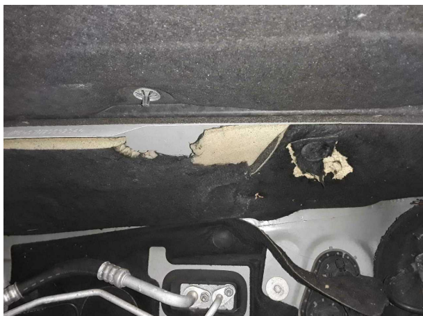
Beschädigung #6: Fahrerhaus: Dämmmatte - beschädigt - erneuern
