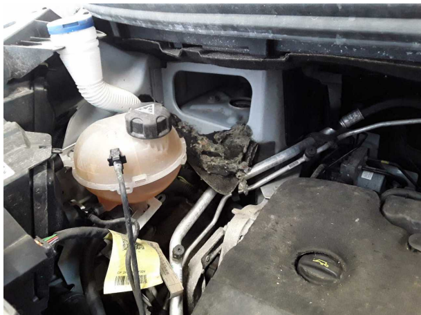
Beschädigung #6: Fahrerhaus: Dämmmatte - beschädigt - erneuern
