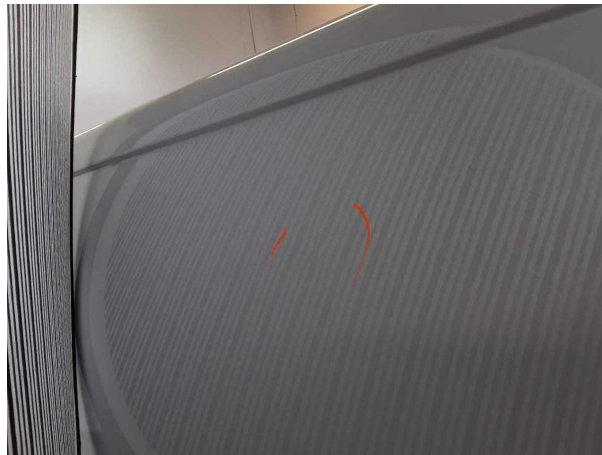
Beschädigung #1: Seitenwand links: Seitenwand - Delle(n) - sanft instandsetzen
