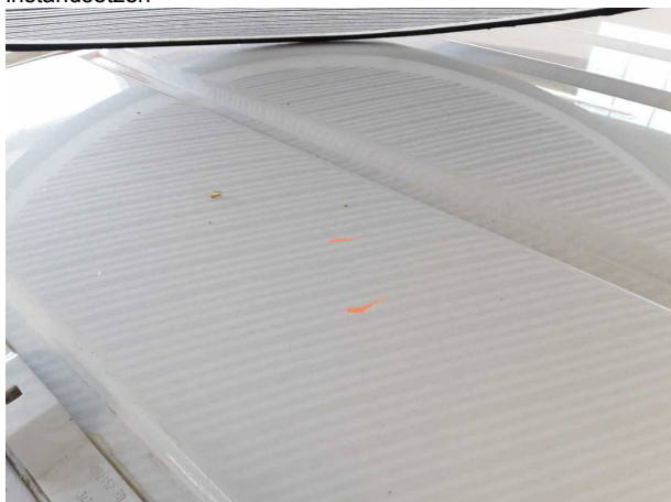
Beschädigung #3: Fahrzeugdach: Dach (Beulen) - Delle(n) - sanft instandsetzen
