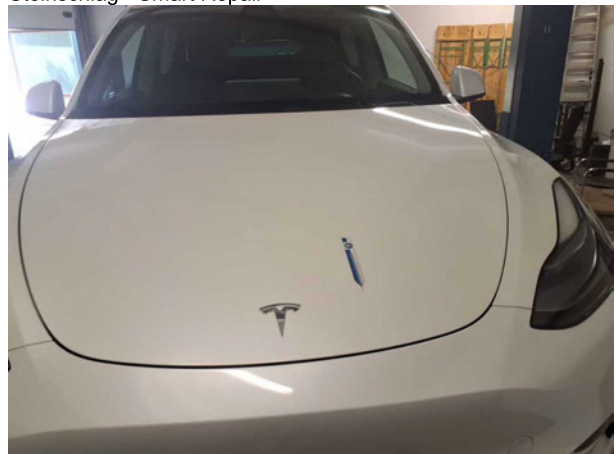
Beschädigung #3: Motorhaube: Motorhaube - Steinschlag - instandsetzen und lackieren
