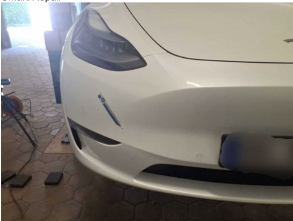
Beschädigung #2: Stossfänger vorn: Stossfänger vorn rechts - Steinschlag - Smart Repair
