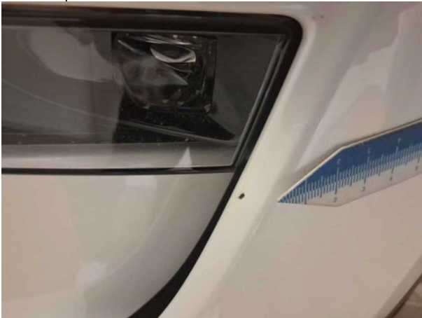
Beschädigung #1: Stossfänger vorn: Stossfänger vorn links - Kratzer - Smart Repair
