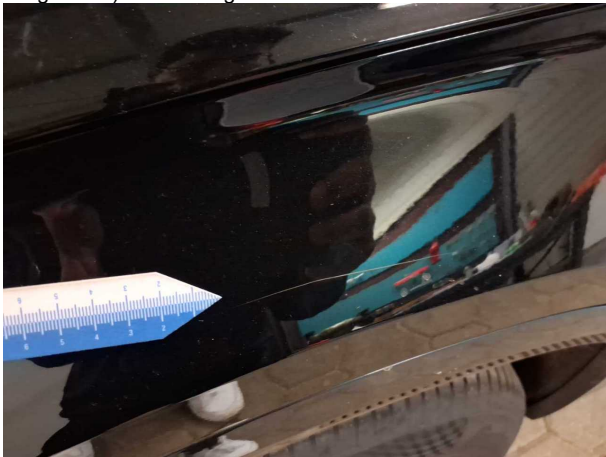
Beschädigung #3: Kotflügel links: Kotflügel links - Kratzer - lackieren
