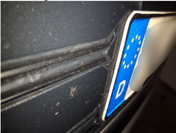
Beschädigung #2: Motorhaube: Kühlergrill (Kennzeichen wurde festgeklebt.) - beschädigt - instandsetzen und lackieren
