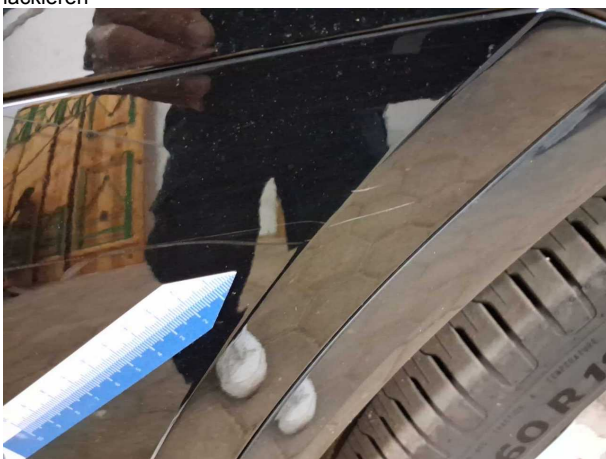
Beschädigung #4: Stossfänger vorn: Stossfänger vorn - Kratzer - lackieren
