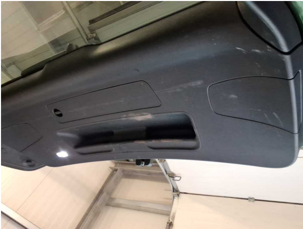
Beschädigung #1: Verkleidungen/Abdeckungen: Heckdeckel, Innenverkleidung - verkratzt / verschürft - erneuern
