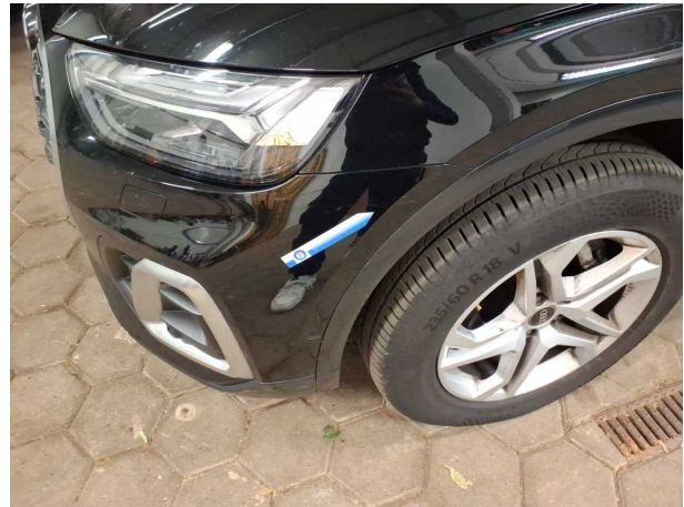
Beschädigung #4: Stossfänger vorn: Stossfänger vorn - Kratzer - lackieren
