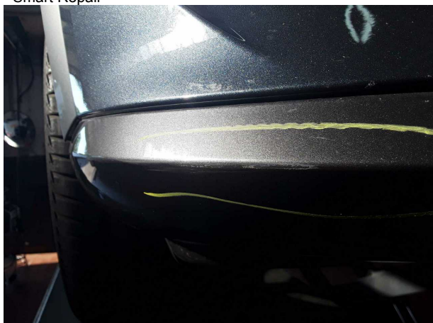
Beschädigung #1: Stossfänger vorn: Spoiler - verkratzt / versch... - Smart Repair
