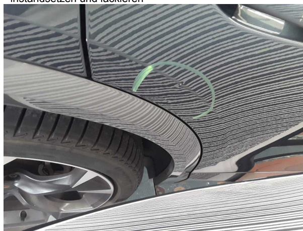
Beschädigung #3: Tür hinten rechts: Tür - Delle / Lackschad... - instandsetzen und lackieren
