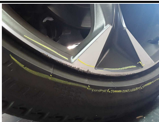
Beschädigung #4: Rad/Reifen: Leichtmetallfelge hinten links - verkratzt / verschürft - erneuern
