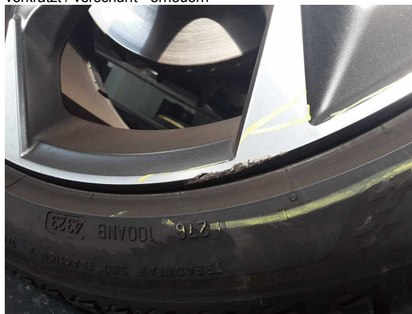
Beschädigung #6: Rad/Reifen: Leichtmetallfelge vorn rechts - verkratzt / verschürft - erneuern
