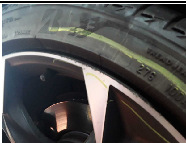
Beschädigung #5: Rad/Reifen: Leichtmetallfelge vorn links - verkratzt / verschürft - erneuern
