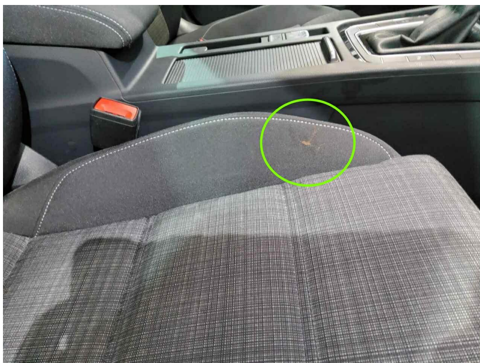
Bild 16 : Sitz vorne rechts Sitzbezug, verschmutzt, reinigen
