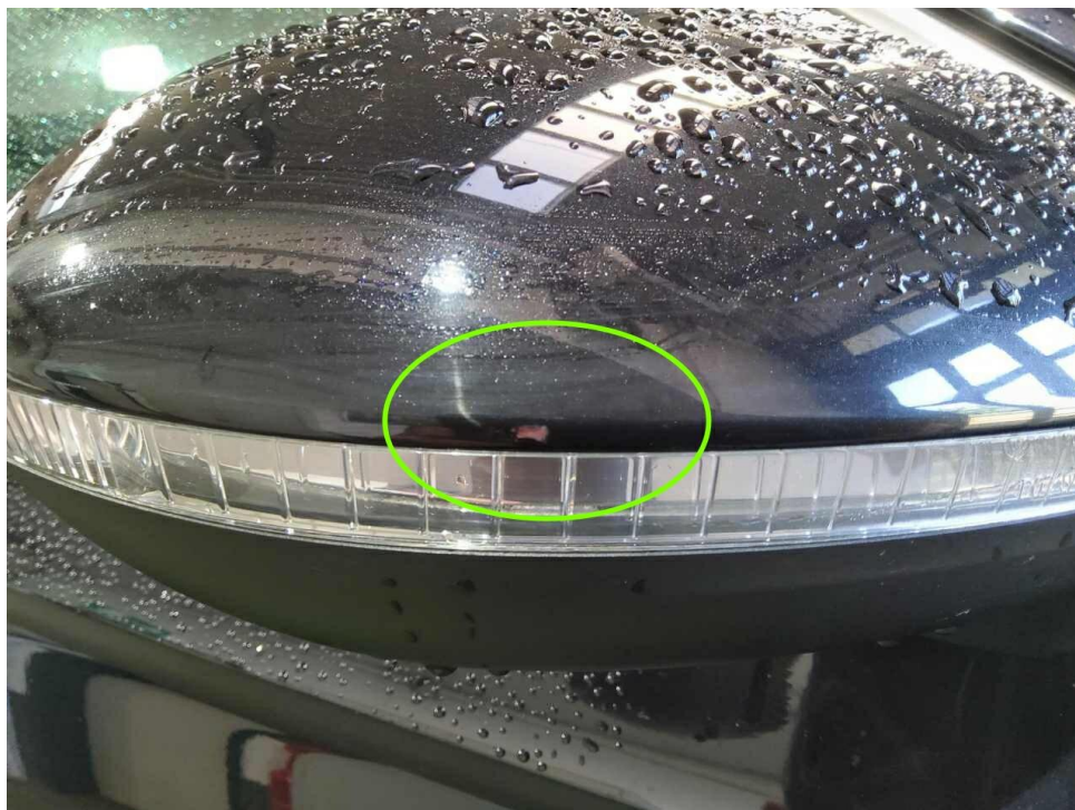
Bild 14 : Außenspiegel rechts Lackierung, verschrammt, lackieren
