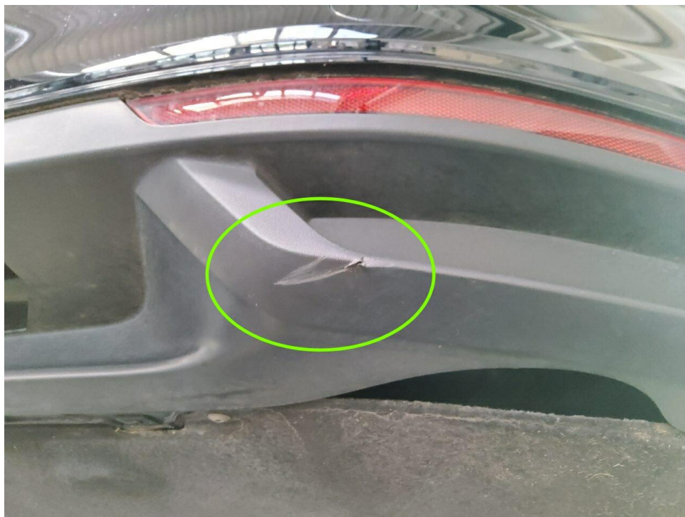
Bild 21 : Stoßfänger hinten unterhalb, verschrammt
