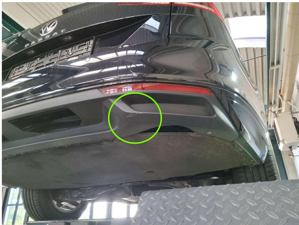
Bild 20 : Stoßfänger hinten unterhalb, verschrammt
