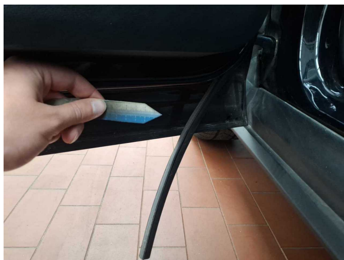
Damage 5: Cab: Door rubber seal - left side (Tür vorne links) - Loose - Replace
