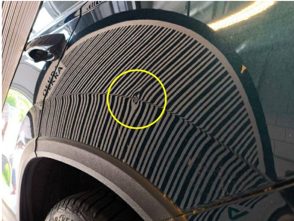
Bild 19 : Seitenteil hinten links, eingedellt, drücken
