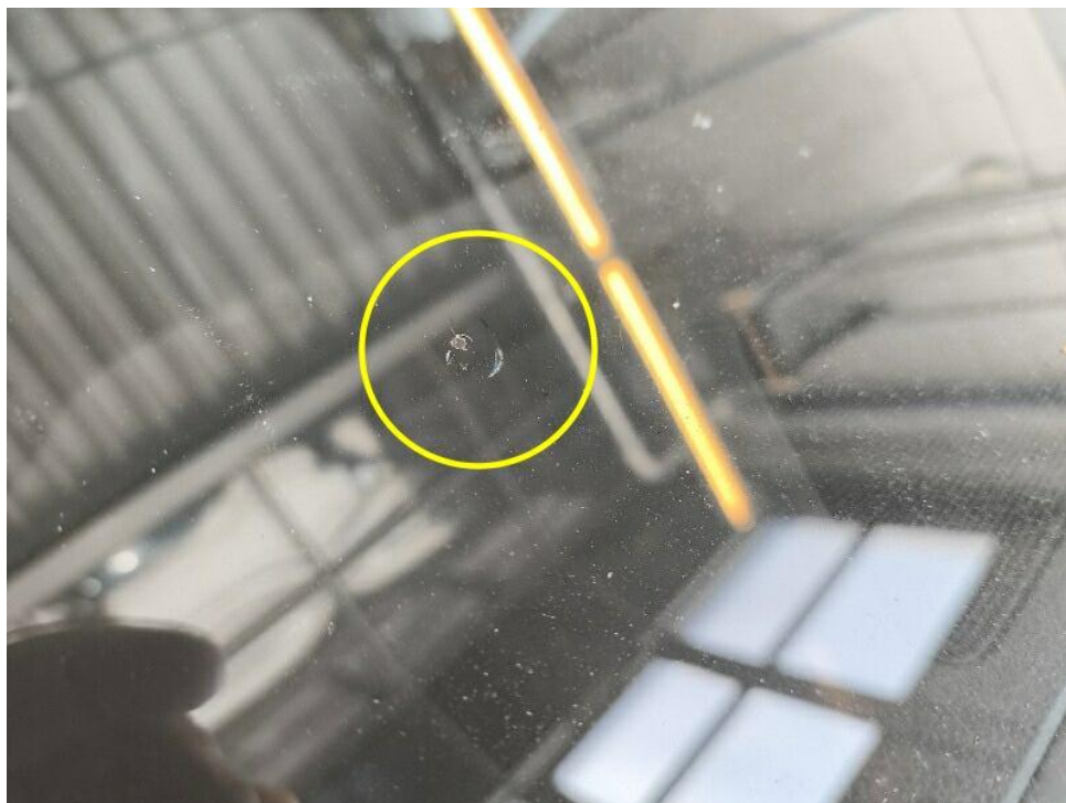
Bild 14 : T-Windschutzscheibe mit Steinschlag und Rissbildung
