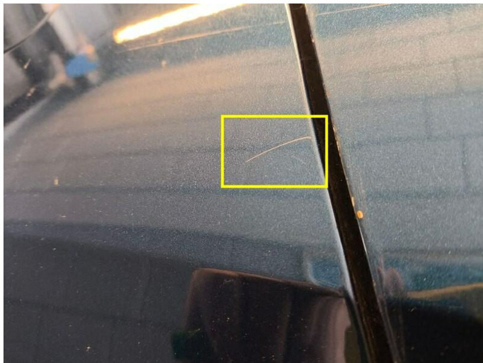
Bild 18 : Seitenteil hinten rechts Lackierung, zerkratzt, lackieren mit Lackaufbau
