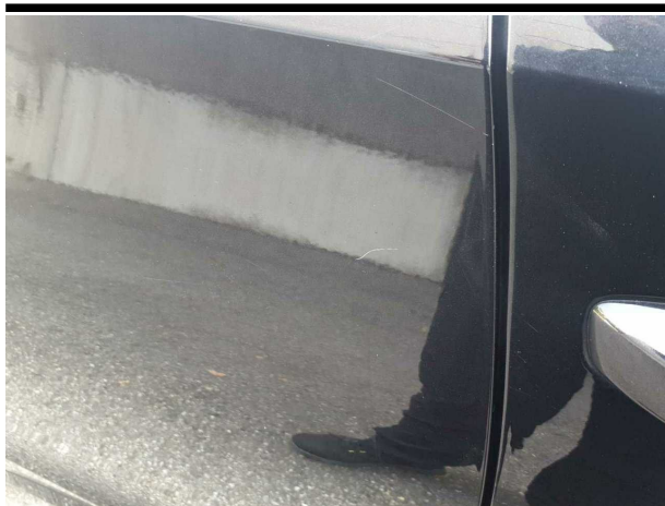
Beschädigung #6: Tür hinten rechts: Tür - verkratzt / verschürft - lackieren
