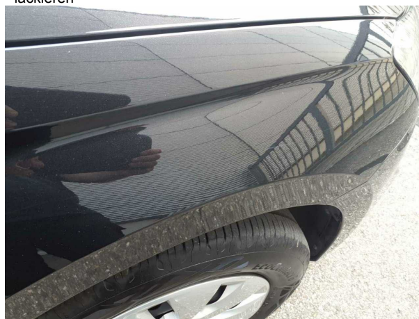
Beschädigung #8: Kotflügel rechts: Kotflügel rechts - verkratzt / verschürft - lackieren
