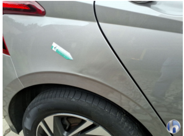
1. Seitenwand - Hinten - Rechts Verdellt - Instandsetzen und Lackieren
