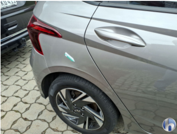
1. Seitenwand - Hinten - Rechts Verdellt - Instandsetzen und Lackieren
