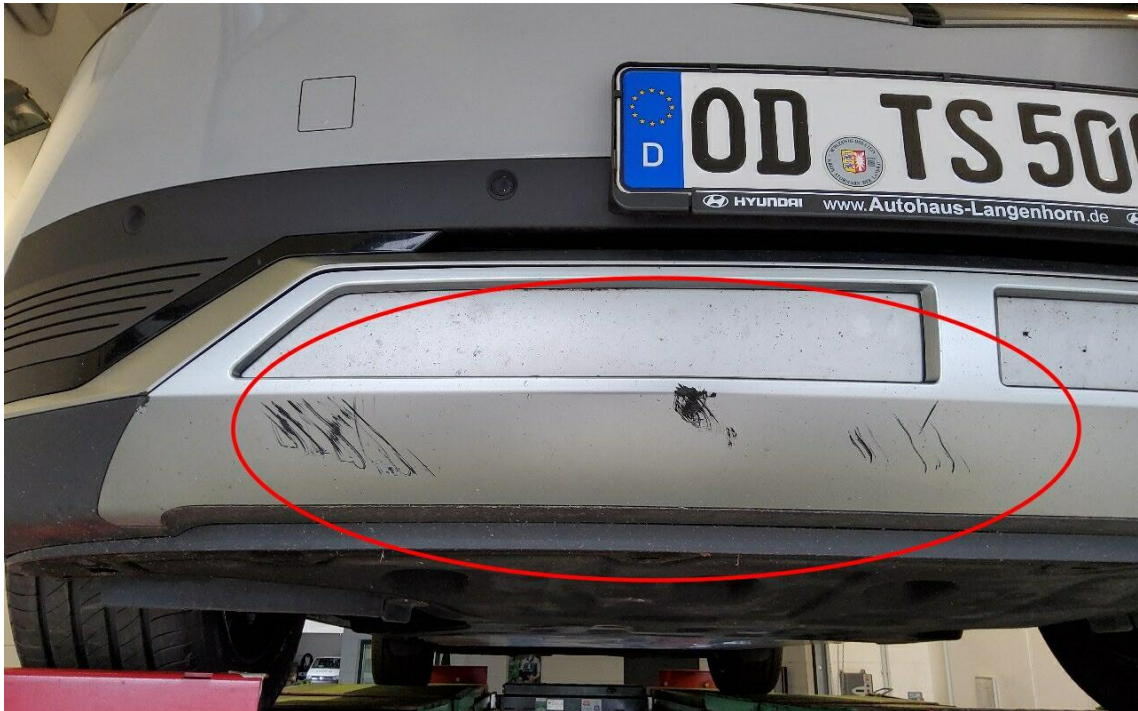
Bild 11 : Frontspoiler Lackierung, zerschrammt , lackieren mit Lackaufbau
