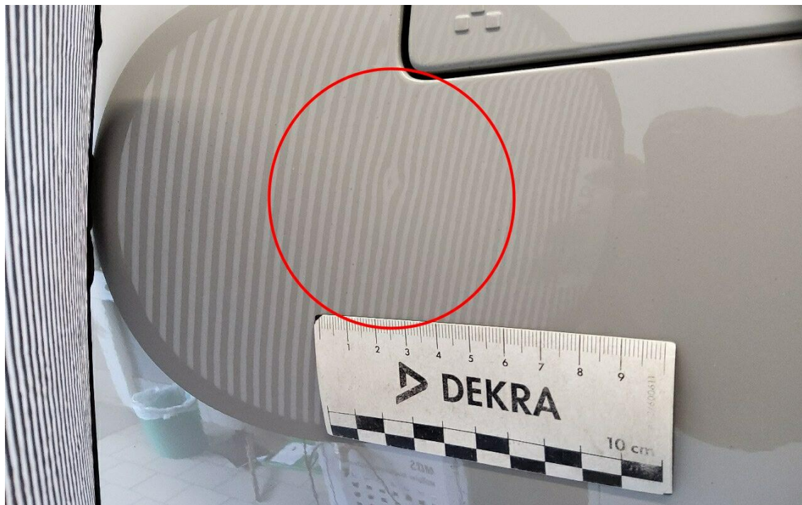
Bild 15 : Tür vorne links, eingedellt, drücken
