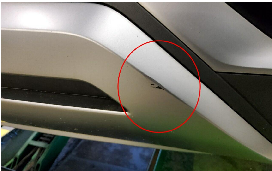
Bild 13 : Stoßfänger hinten Lackierung, verschrammt, smart repair
