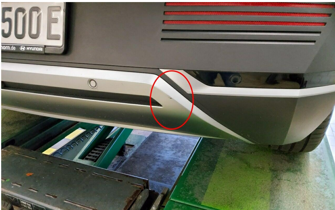
Bild 12 : Stoßfänger hinten Lackierung, verschrammt, smart repair
