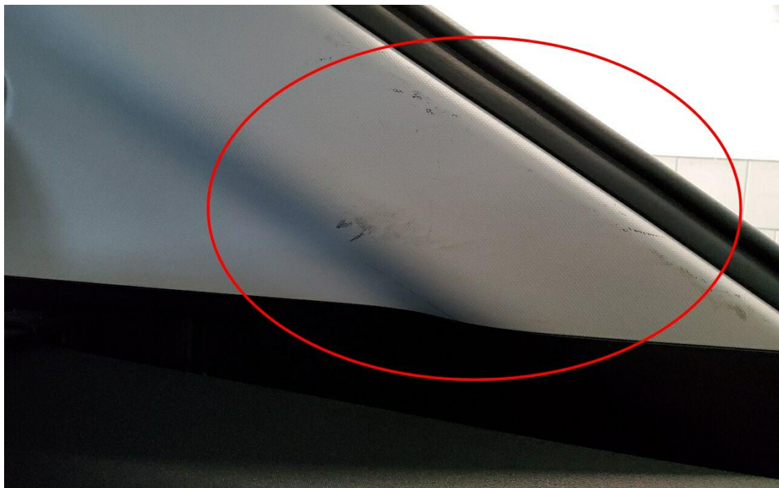
Bild 8 : Verkleidung D-Säule rechts, fleckig, reinigen
