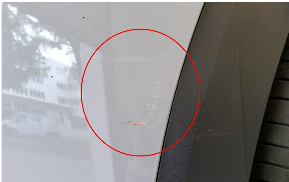
Bild 10 : Stoßfänger vorne Lackierung, verschrammt, polieren
