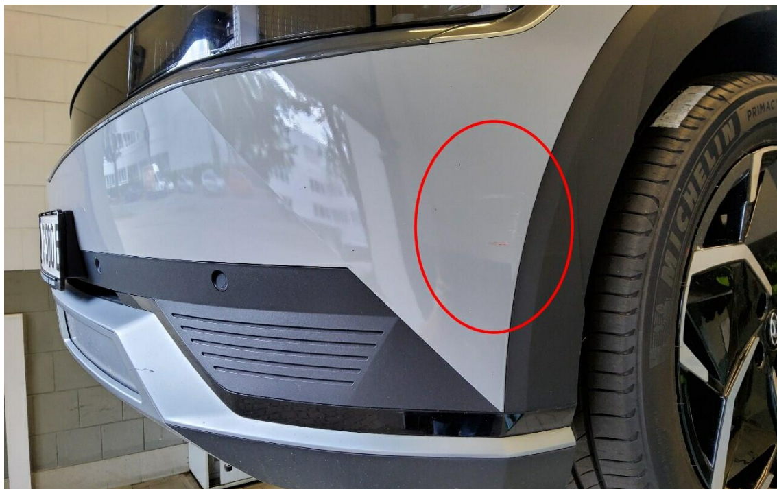
Bild 9 : Stoßfänger vorne Lackierung, verschrammt, polieren
