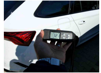
Lackstärke Seitenwand hinten rechts
