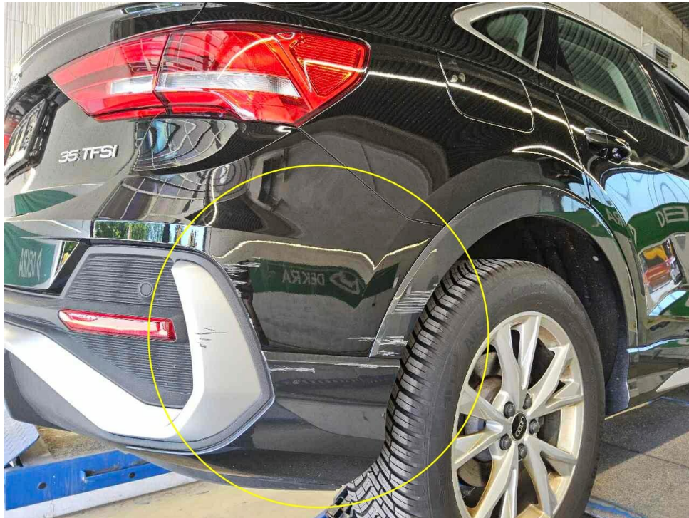
Bild 21 : Schaden hinten rechts, Stoßfänger hinten, Radlaufblende hinten rechts
