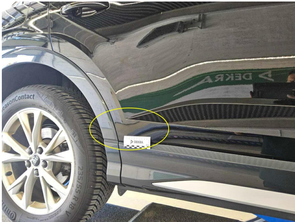
Bild 13 : Tür hinten rechts Lackierung, verschrammt, smart repair
