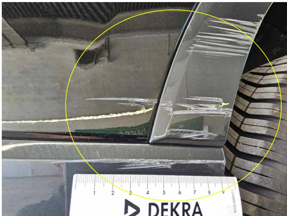
Bild 24 : Schaden hinten rechts, Stoßfänger hinten, Radlaufblende hinten rechts
