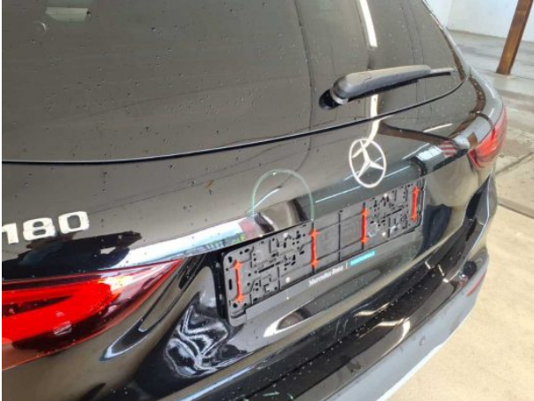
Beschädigung #1: Heckklappe/-tür: Heckklappe - Delle(n) - sanft instandsetzen
