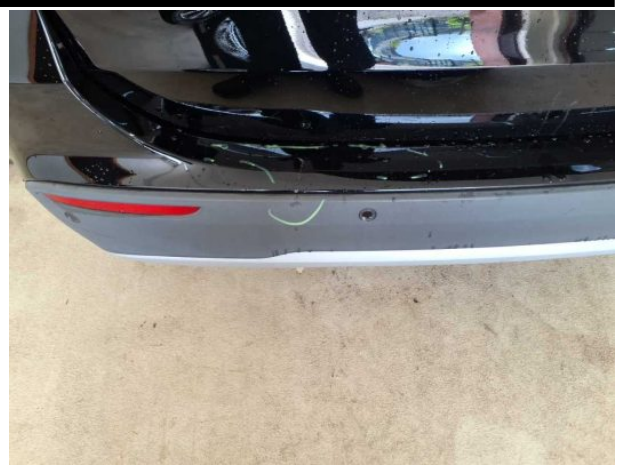
Beschädigung #4: Stossfänger hinten: Spoiler - verkratzt / verschürft - erneuern
