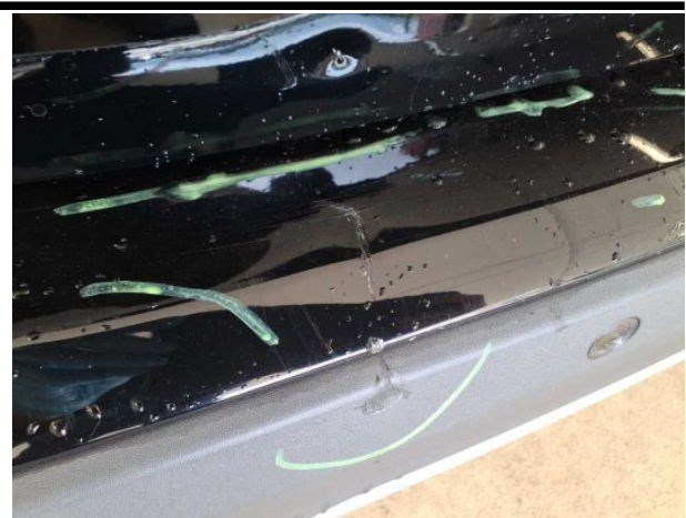
Beschädigung #7: Stossfänger hinten: Stossfänger hinten - verformt - erneuern
