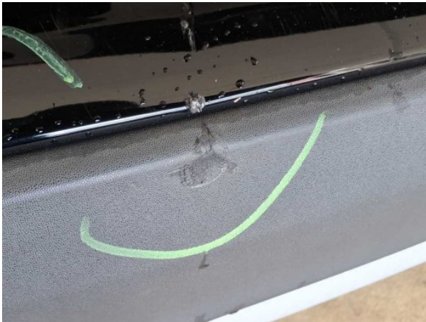
Beschädigung #4: Stossfänger hinten: Spoiler - verkratzt / verschürft - erneuern
