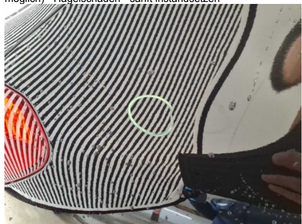
Beschädigung #8: Karosserie: Karosserie (Mehrkosten möglich) - Hagelschaden - sanft instandsetzen
