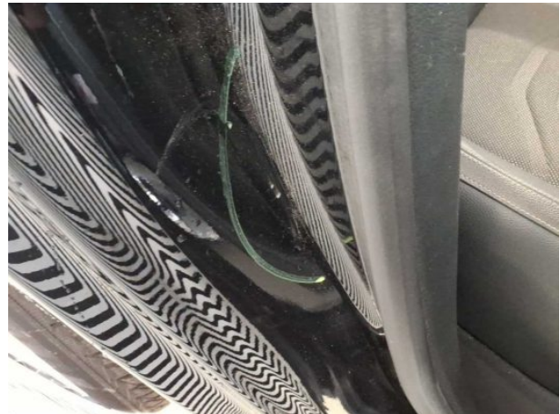
Beschädigung #2: Seitenwand rechts: Einstieg - verkratzt / verschürft - Smart Repair
