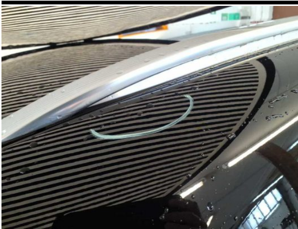
Beschädigung #8: Karosserie: Karosserie (Mehrkosten möglich) - Hagelschaden - sanft instandsetzen
