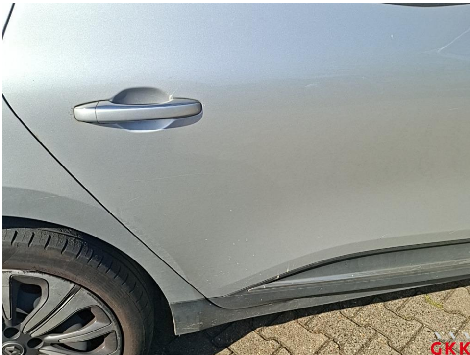
Bild 26. Tür hinten rechts, verkratzt, lackieren
