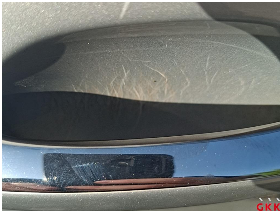
Bild 28. Tür hinten rechts, verkratzt, lackieren
