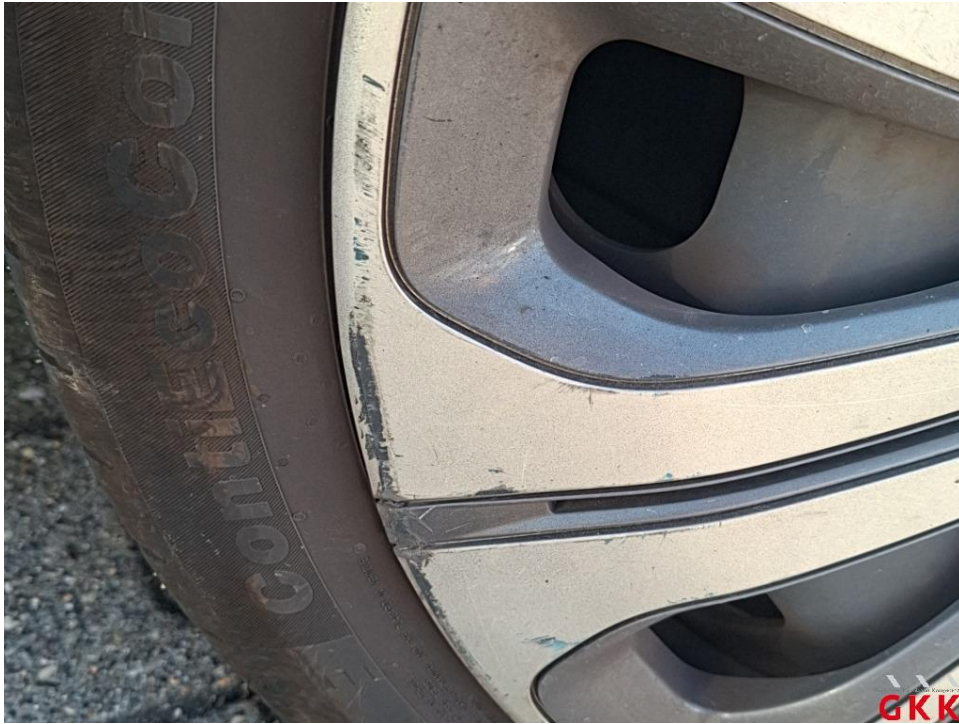
Bild 13. Radkappe(n), hinten links, verkratzt, ersetzen
