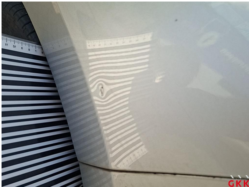
Bild 20. Seitenwand links, beschädigt, instand setzen - lackieren
