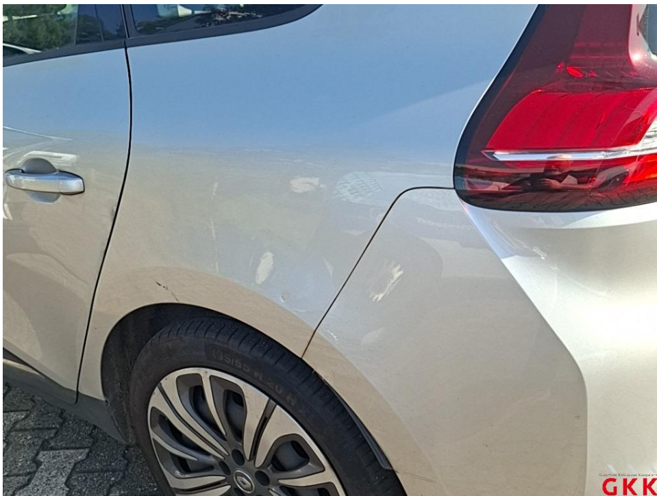
Bild 18. Seitenwand links, beschädigt, instand setzen - lackieren
