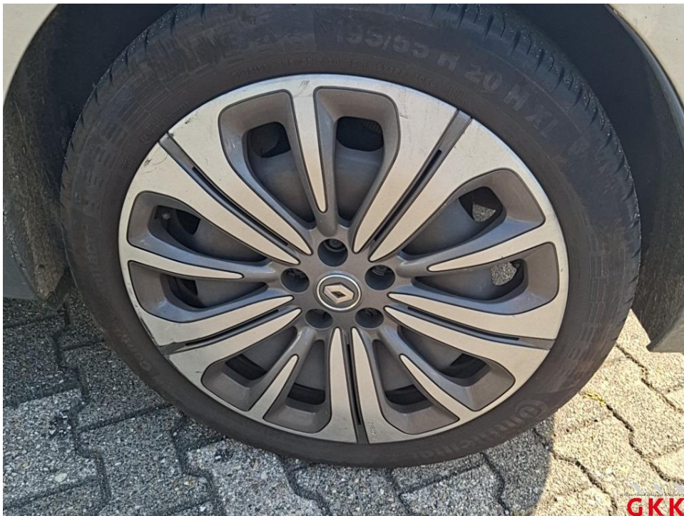
Bild 12. Radkappe(n), hinten links, verkratzt, ersetzen
