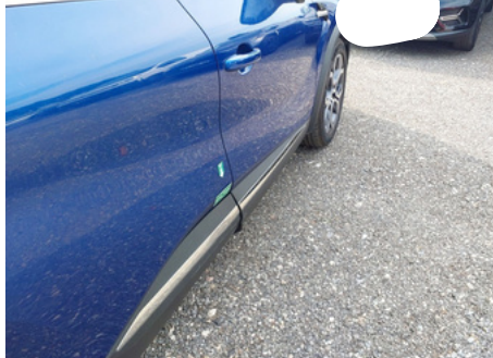
Porte / Arrière Droit / Enfoncement
