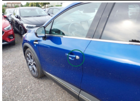
Enjoliveur de barillet / Avant Gauche / Manquant
