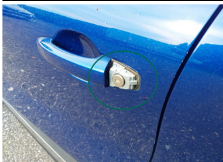
Enjoliveur de barillet / Avant Gauche / Manquant
