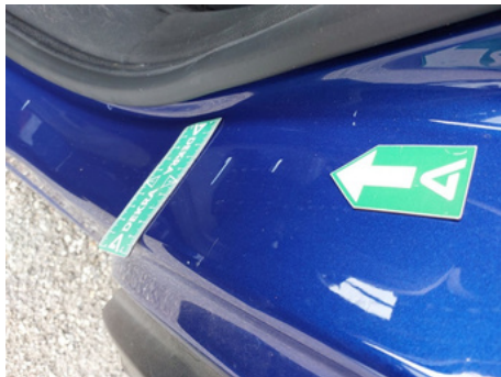
Entrée de porte / Arrière Gauche / Rayure
