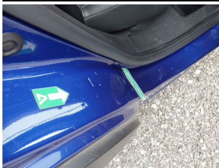
Entrée de porte / Arrière Droit / Enfoncement
