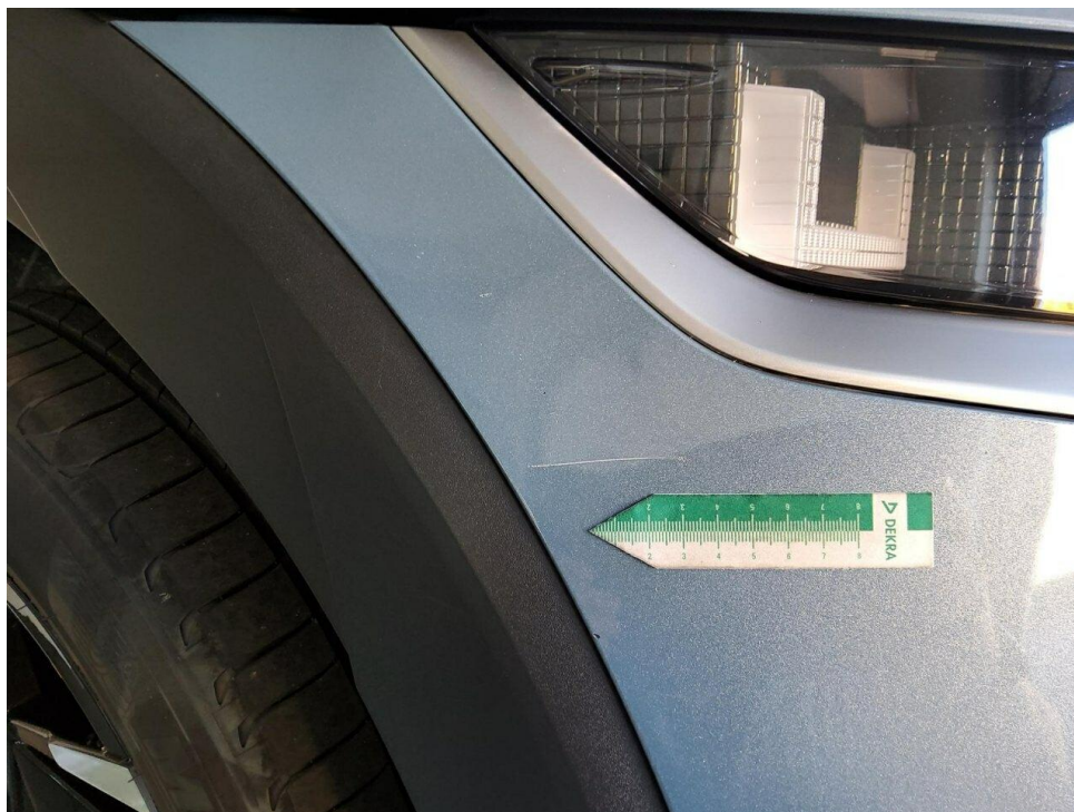
Bild 7 : Stoßfänger vorne Lackierung, zerkratzt, smart repair
