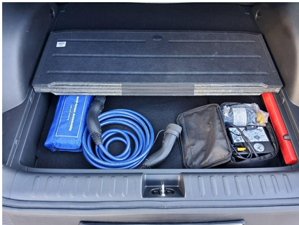
Bild 6 : Ladekabel beim E-Fahrzeug
