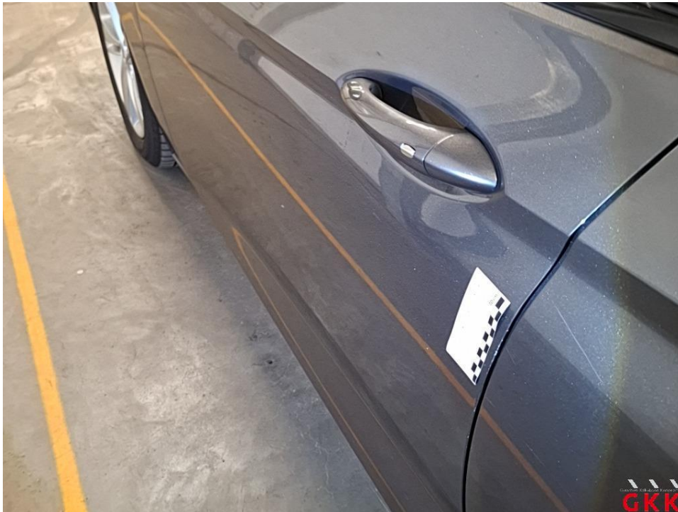
Bild 19 Tür vorne links, Kante, verkratzt, Smartrepair
