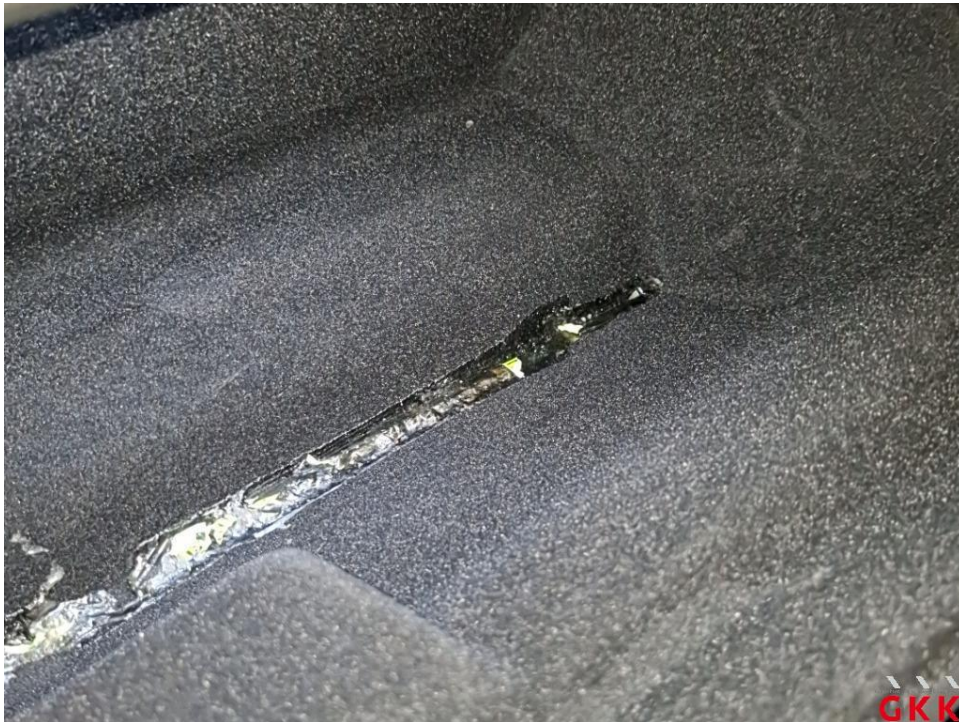
Bild 17 Handschuhfach, beschädigt, ersetzen
