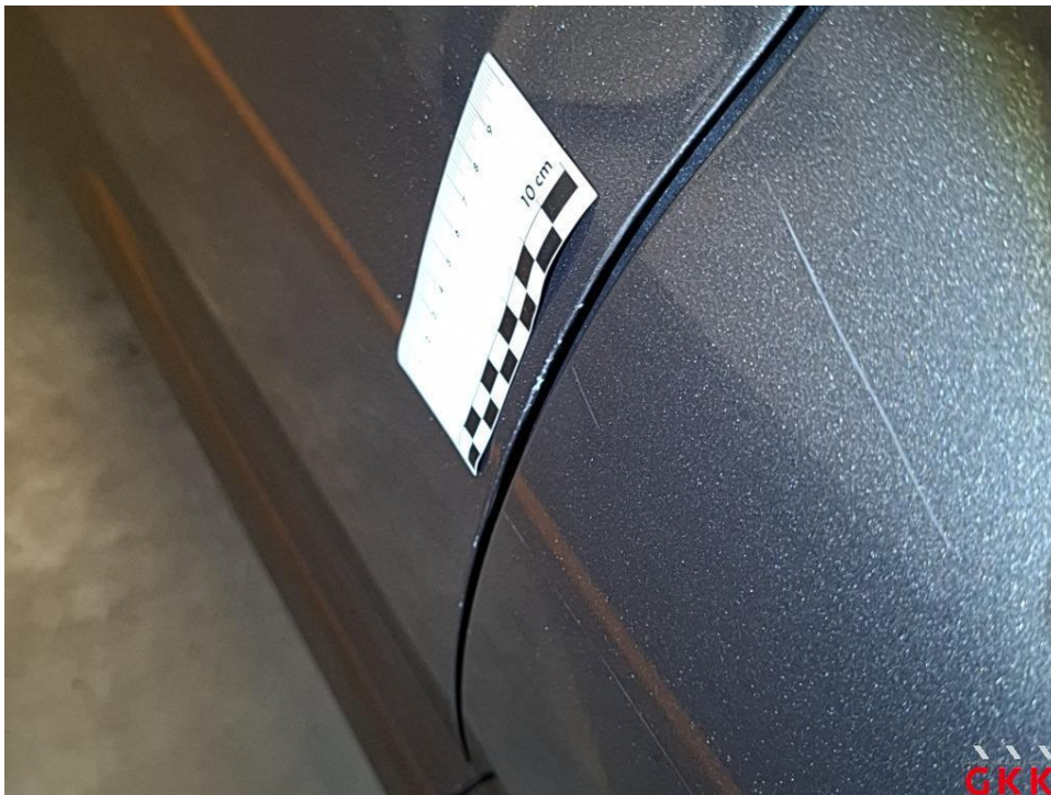
Bild 20 Tür vorne links, Kante, verkratzt, Smartrepair
