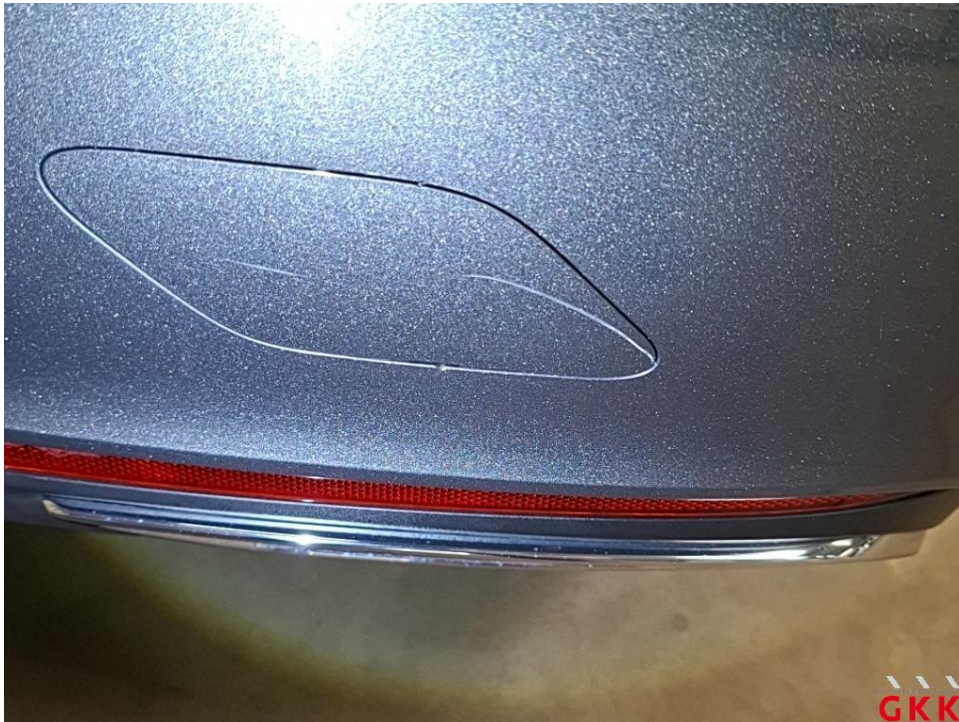
Bild 27 Stoßfänger hinten, Blende -lackiert-, verkratzt, ersetzen
