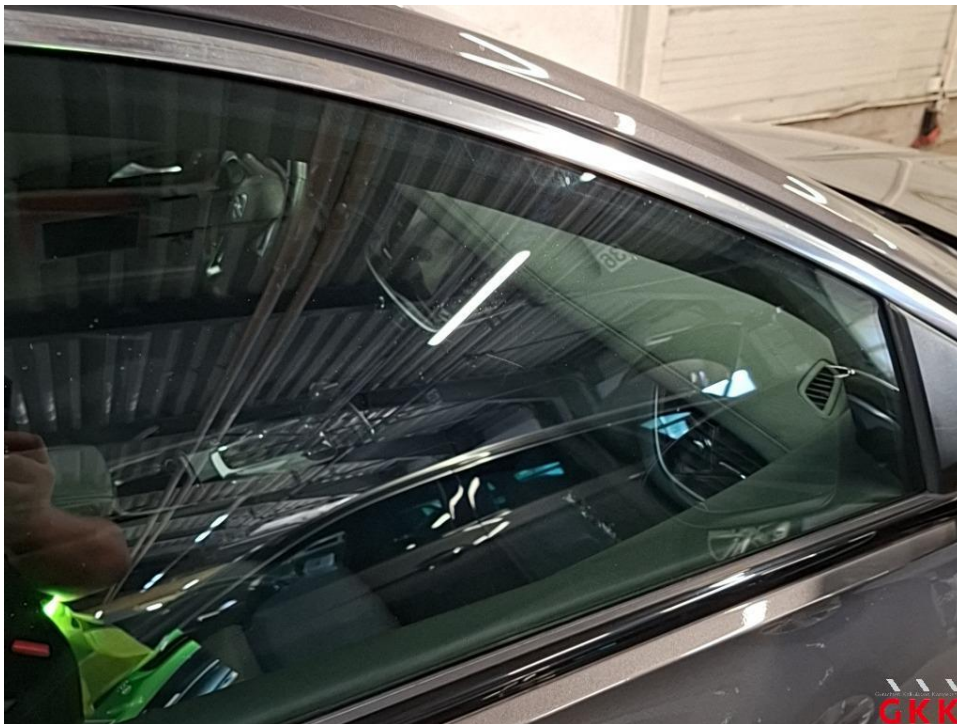
Bild 30 Tür vorne rechts, Scheibe, verkratzt, ersetzen
