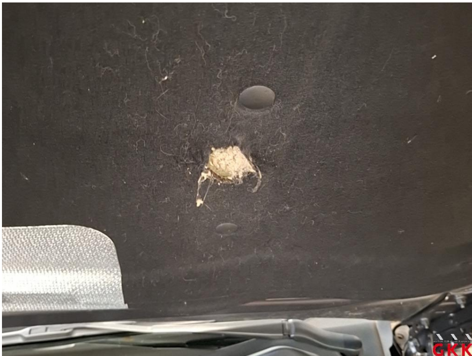
Bild 18 Motorhaube, Dämmmatte, beschädigt, ersetzen
