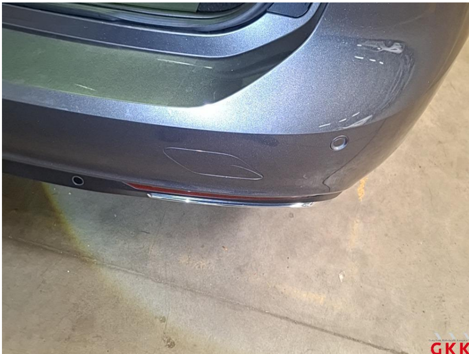
Bild 26 Stoßfänger hinten, Blende -lackiert-, verkratzt, ersetzen
