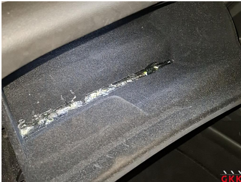
Bild 16 Handschuhfach, beschädigt, ersetzen
