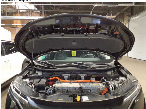
Beschädigung #3: Motorhaube: Dämmmatte - Marderschaden - erneuern
