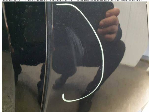
Beschädigung #6: Stossfänger vorn: Stossfänger vorn (inkl. Spoiler) - verkratzt / verschürft - instandsetzen und lackieren
