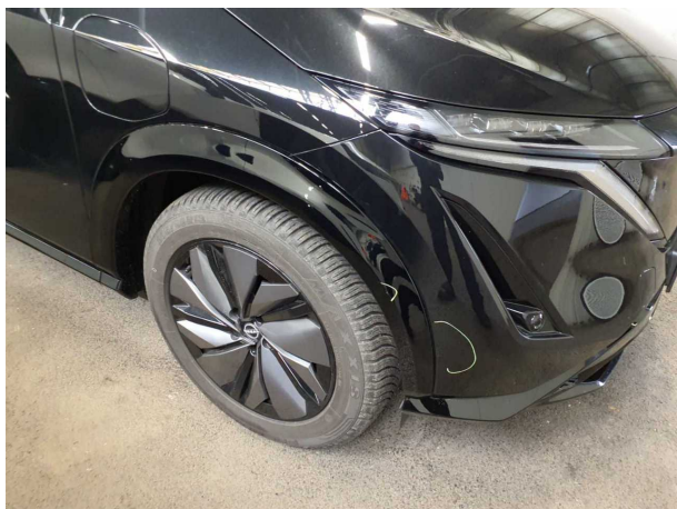
Beschädigung #4: Kotflügel rechts: Radhausverbreiterung - verkratzt / verschürft - Smart Repair
