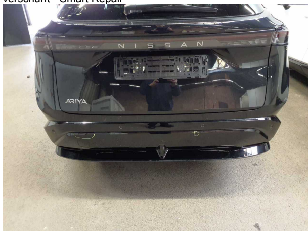
Beschädigung #5: Stossfänger hinten: Stossfänger hinten (unterhalb...) - verkratzt / verschürft - lackieren
