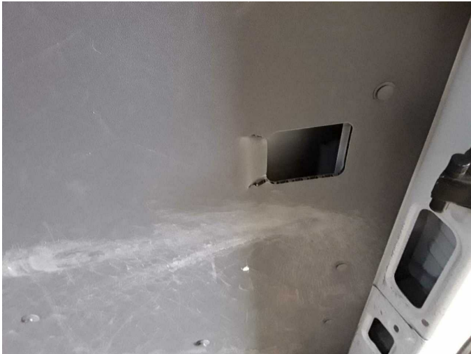
Damage 1: Interior: Interior (Laderaumverkleidungen) - Broken / torn - Replace
