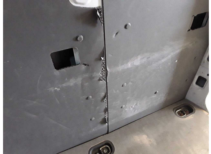
Damage 1: Interior: Interior (Laderaumverkleidungen) - Broken / torn - Replace
