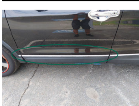
Türzarge / Vorne Links / Abgewetzt
