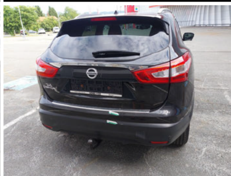
Stoßfänger / Hinten / Delle
