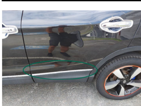
Türzarge / Hinten Links / Abgewetzt
