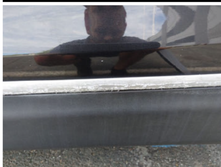
Türzarge / Vorne Links / Abgewetzt
