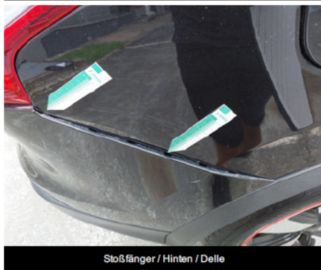
Stoßfänger / Hinten / Delle
