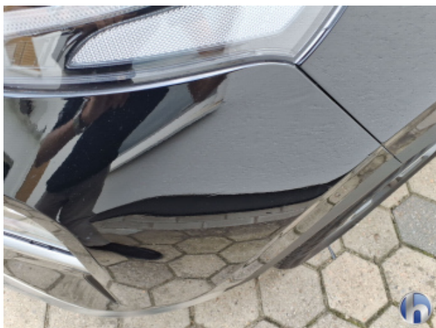
4. Stoßfänger Vorne Beschädigt - Lackieren
