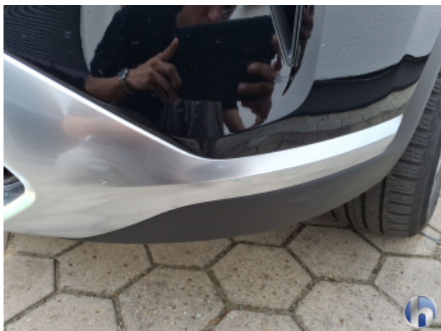
4. Stoßfänger Vorne Beschädigt - Lackieren
