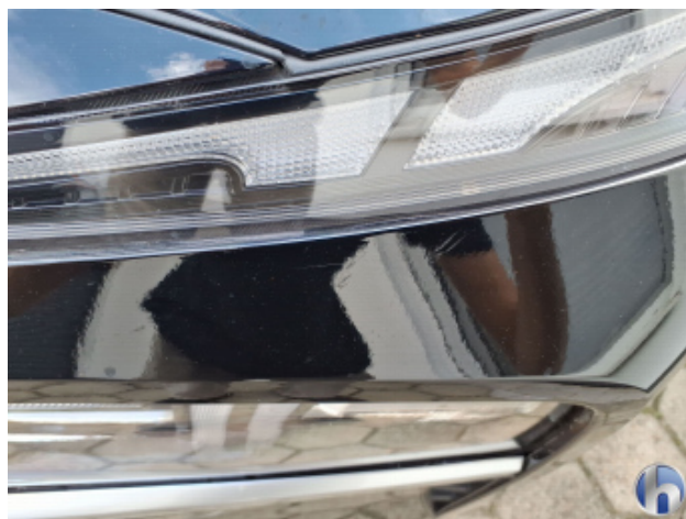
4. Stoßfänger Vorne Beschädigt - Lackieren
