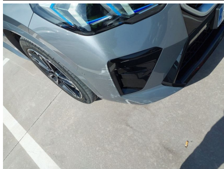
Moldura de paragolpes / Delantero Derecho / Rayado
