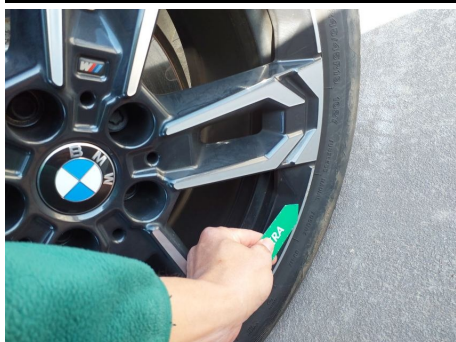
Llanta / Trasero Derecho / Rayado
