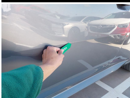
Puerta / Delantero Izquierdo / Abolladura
