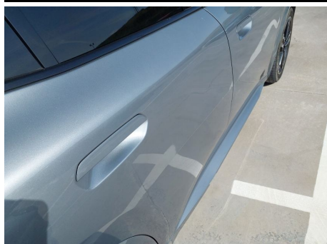
Puerta / Trasero Derecho / Abolladura
