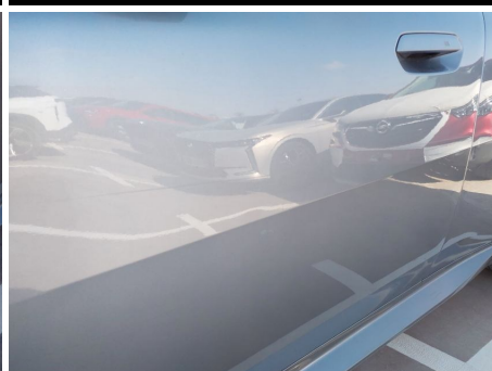
Puerta / Delantero Izquierdo / Abolladura
