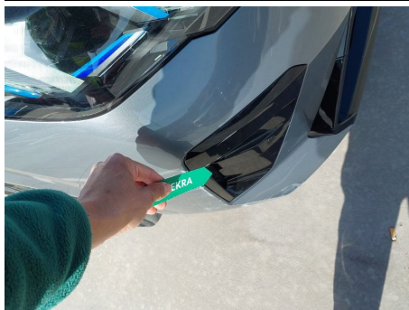
Moldura de paragolpes / Delantero Derecho / Rayado
