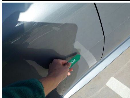
Puerta / Trasero Derecho / Abolladura
