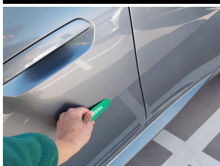
Puerta / Delantero Izquierdo / Abolladura
