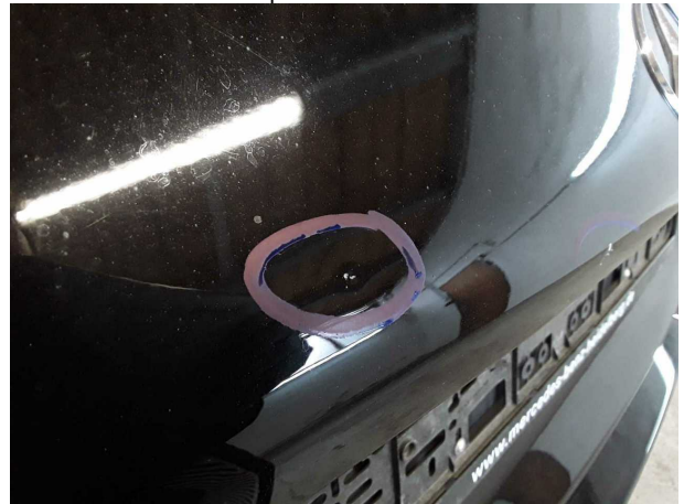
Beschädigung #6: Heckklappe/-tür: Heckklappe - Delle / Lackschaden - Smart Repair
