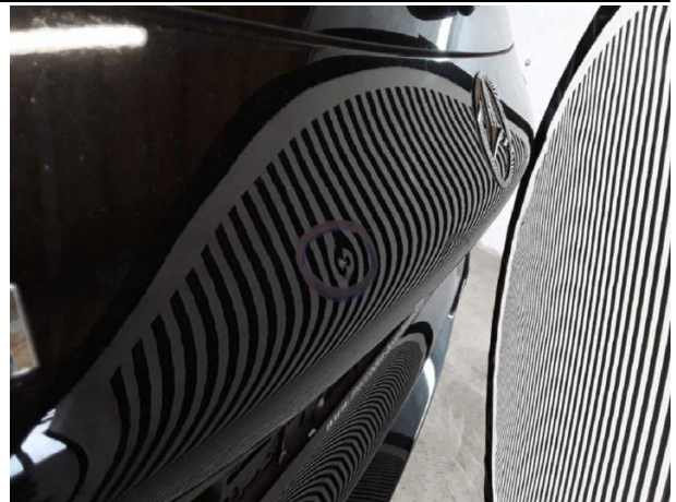
Beschädigung #6: Heckklappe/-tür: Heckklappe - Delle / Lackschaden - Smart Repair
