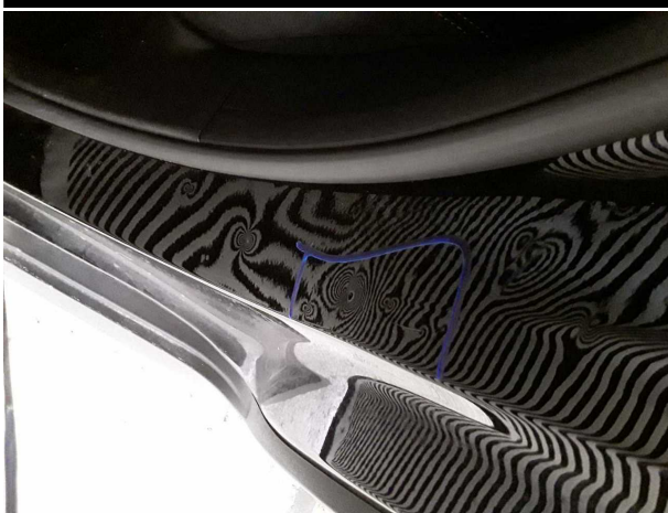
Beschädigung #8: Seitenwand links: Einstieg - Delle / Lackschaden - instandsetzen und lackieren
