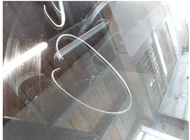
Beschädigung #9: Verglasung: Frontscheibe (Rissbildung) - Steinschlag - erneuern
