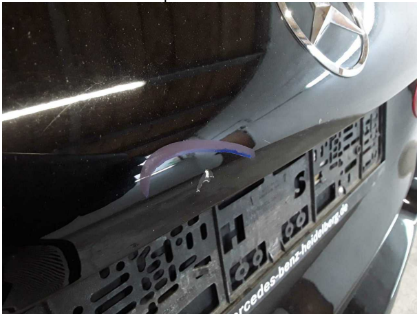
Beschädigung #6: Heckklappe/-tür: Heckklappe - Delle / Lackschaden - Smart Repair
