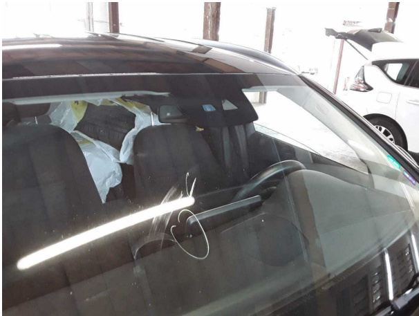
Beschädigung #9: Verglasung: Frontscheibe (Rissbildung) - Steinschlag - erneuern
