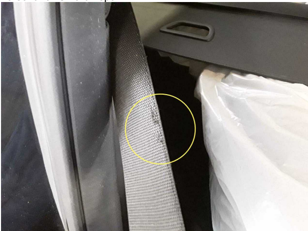
Beschädigung #4: Gurtsystem hinten: Sicherheitsgurt hinten rechts - porös / rissig - erneuern
