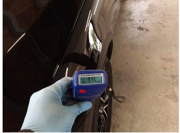
Nachlackierung 1: Kotflügel links, Kotflügel rechts, Motorhaube
