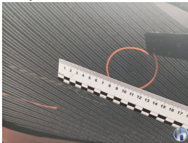
6. Tür Hinten - Rechts Delle - Sanft Instandsetzen
