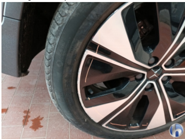
2. Felge Hinten - Rechts Beschädigt - Smart Repair
