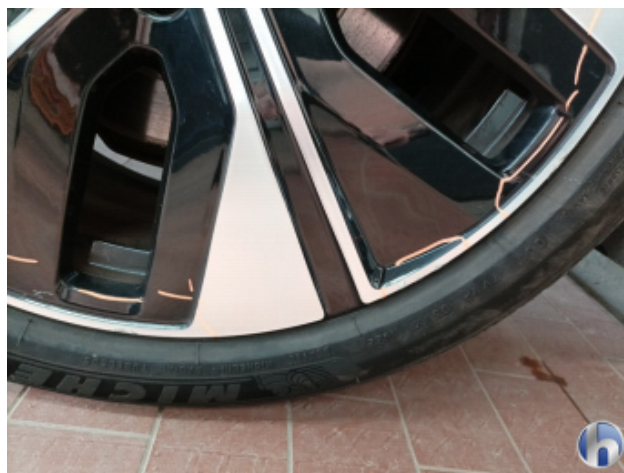
2. Felge Hinten - Rechts Beschädigt - Smart Repair
