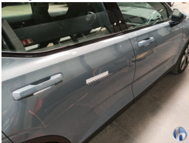
6. Tür Hinten - Rechts Delle - Sanft Instandsetzen
