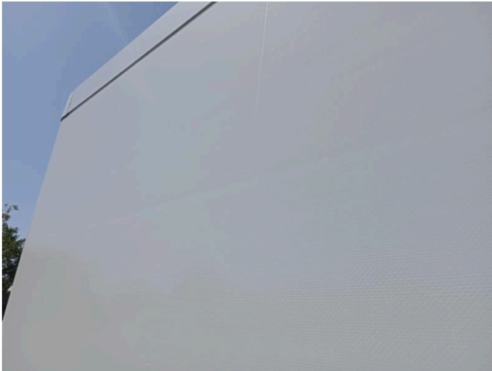
Bild: 33 Kühlkofferseitenwand links streifend verkratzt und leicht eingedrückt
