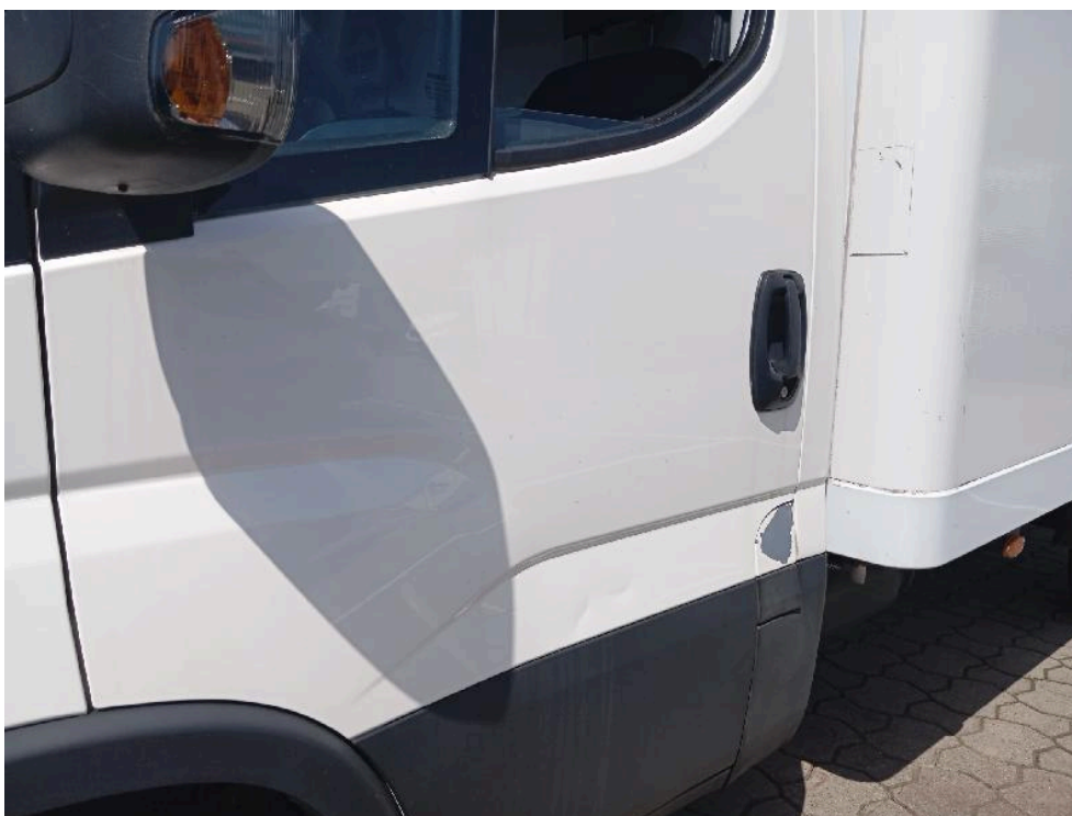
Bild: 27 Tür links deformiert
