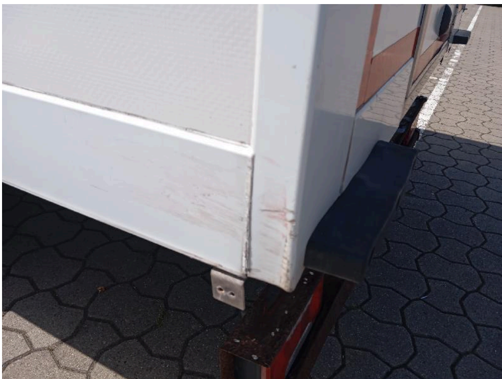
Bild: 34 Ecke Kühlkoffer links verformt
