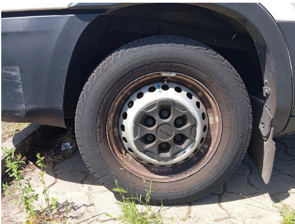
Bild: 25 Radkappe vorn links gebrochen/ Reifenseitenwand abgeschrammt
