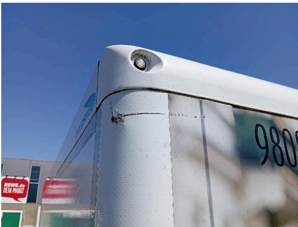
Bild: 45 Kofferecke oben rechts aufgerissen
