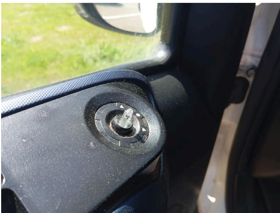
Bild: 20 Außenspiegelversteller links abgerissen
