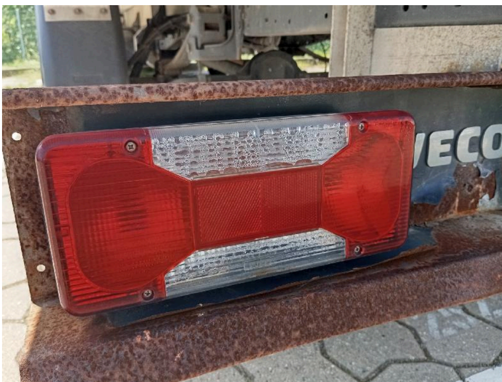
Bild: 46 Rücklicht links undicht
