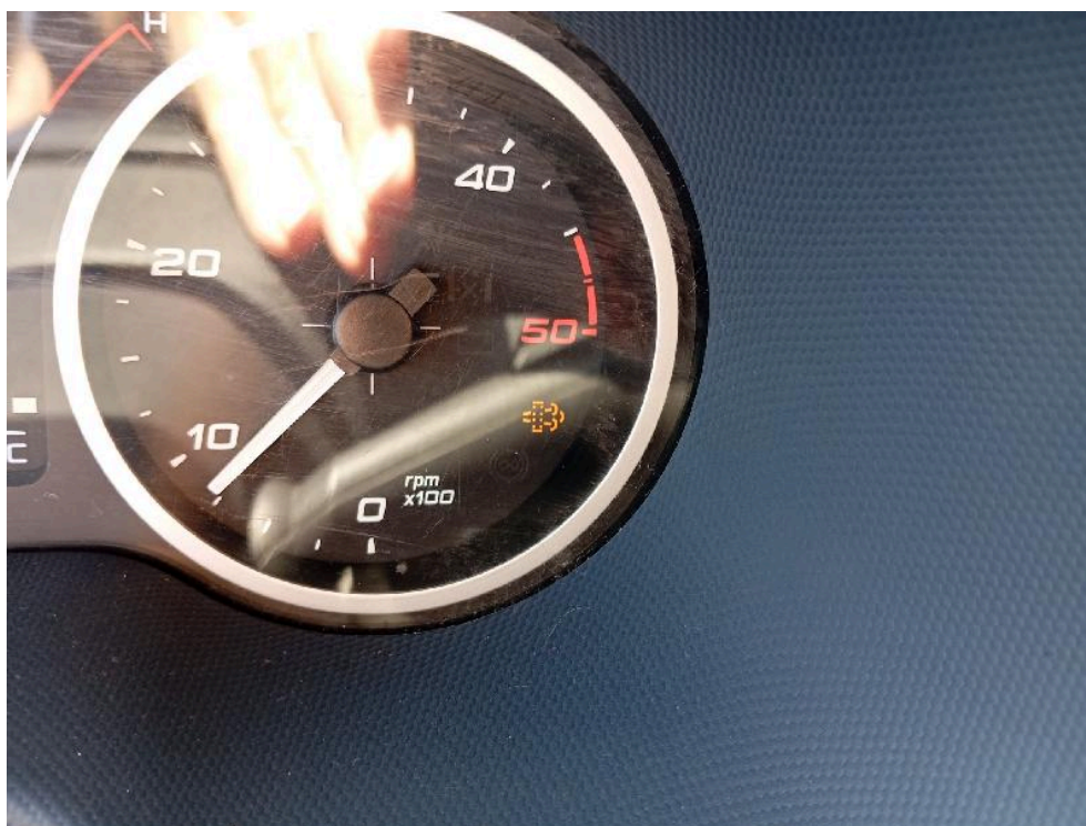
Bild: 16 Partikelfilter voll
