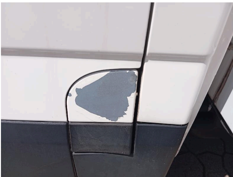
Bild: 26 Tankdeckel Lackabplatzungen
