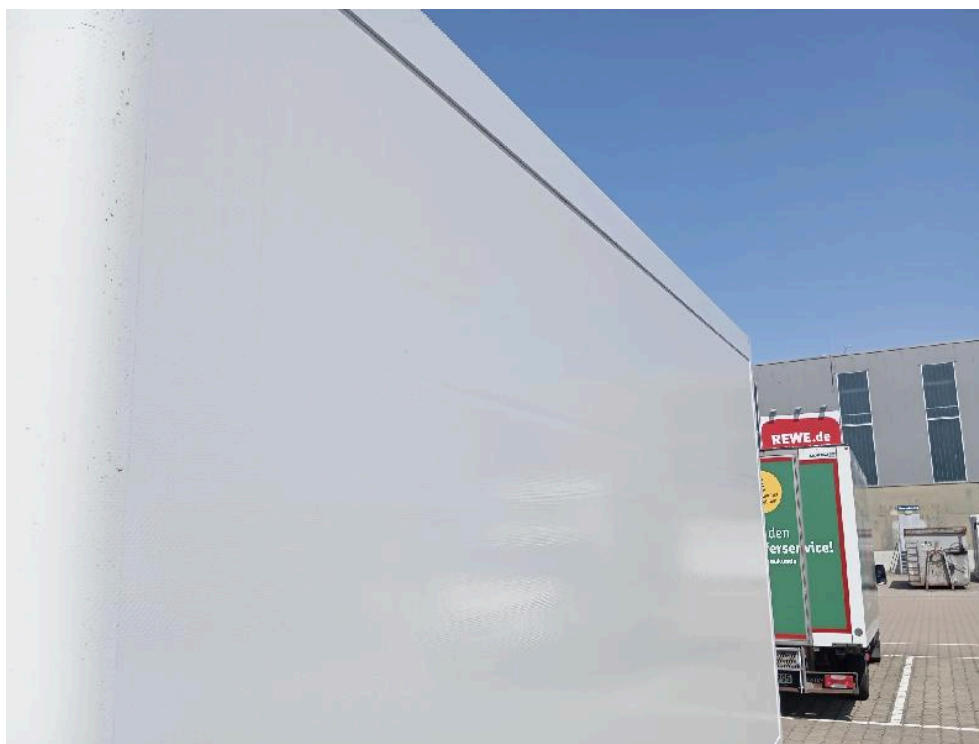
Bild: 31 Kühlkofferseitenwand links streifend verkratzt und leicht eingedrückt
