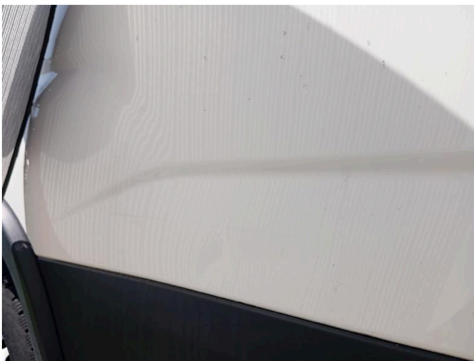
Bild: 28 Tür links deformiert
