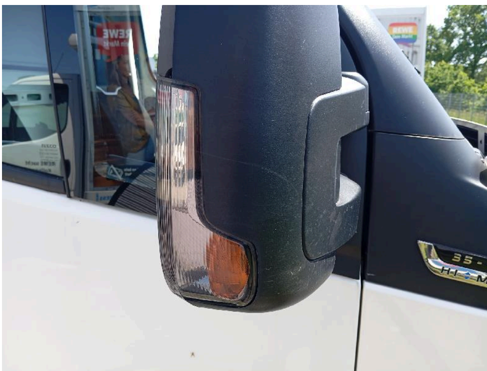
Bild: 40 Außenspiegelkappe rechts verkratzt/ Blinkerglas gebrochen
