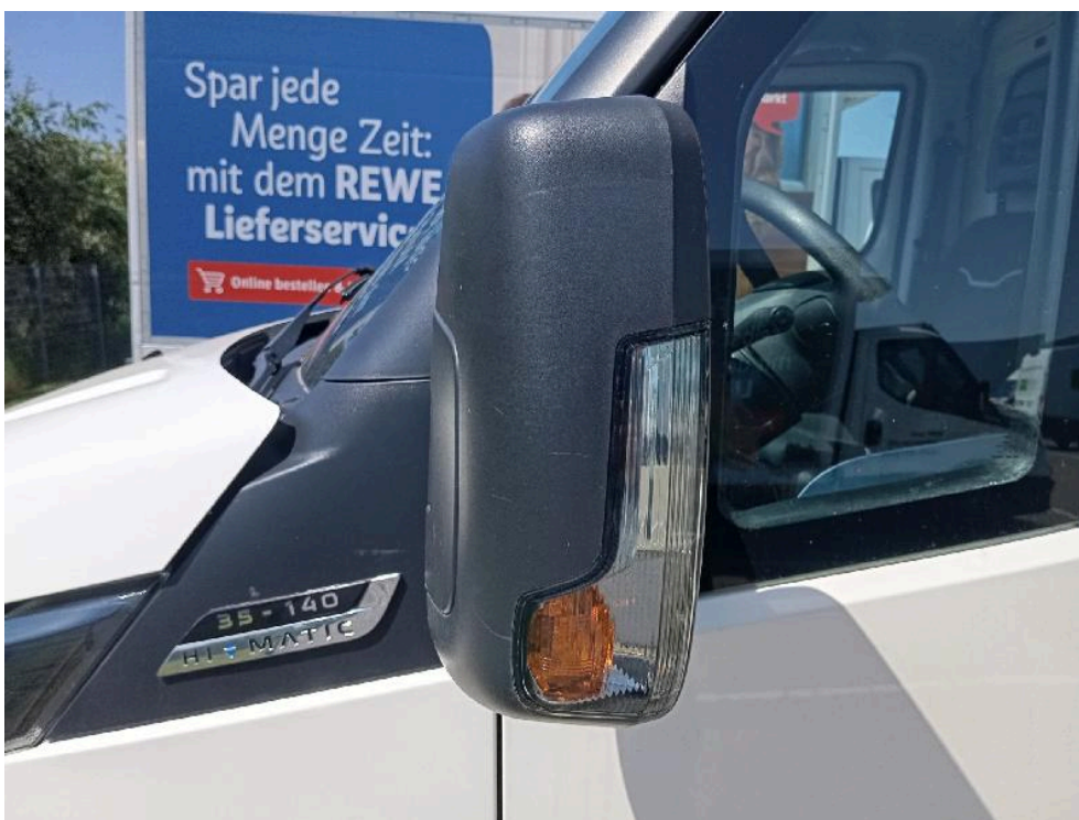
Bild: 44 Außenspiegelkappe links verkratzt/ Blinkerglas gebrochen
