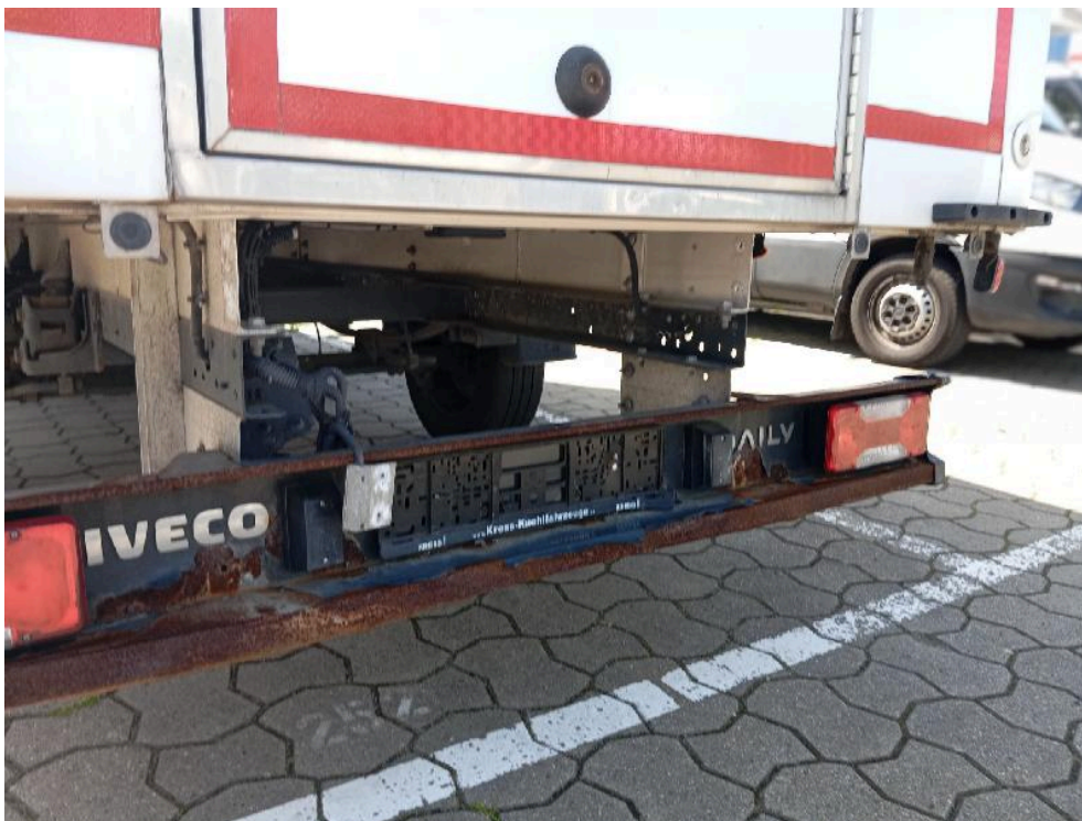
Bild: 35 Heckunterfahrschutz Korrosionsbehaftet/Heckauftritt fehlt
