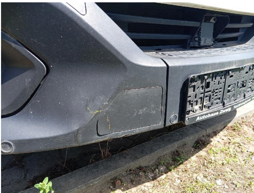
Bild: 23 Frontstoßfänger rechts deformiert
