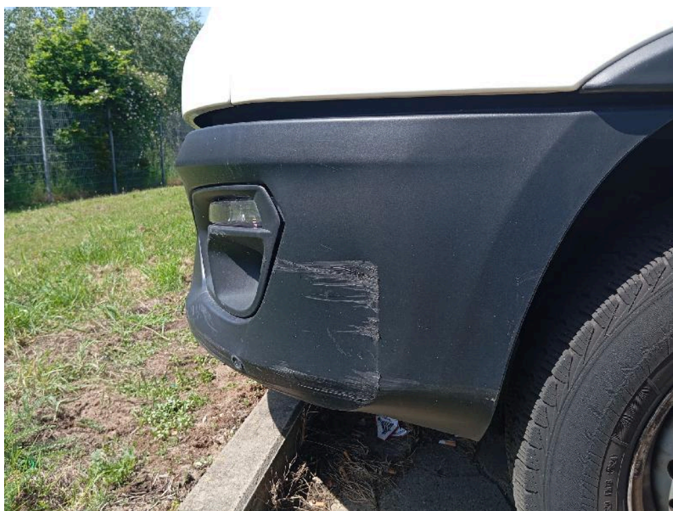
Bild: 22 Frontstoßfänger links abgeschrammt
