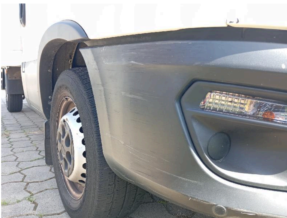
Bild: 24 Frontstoßfänger rechts verkratzt
