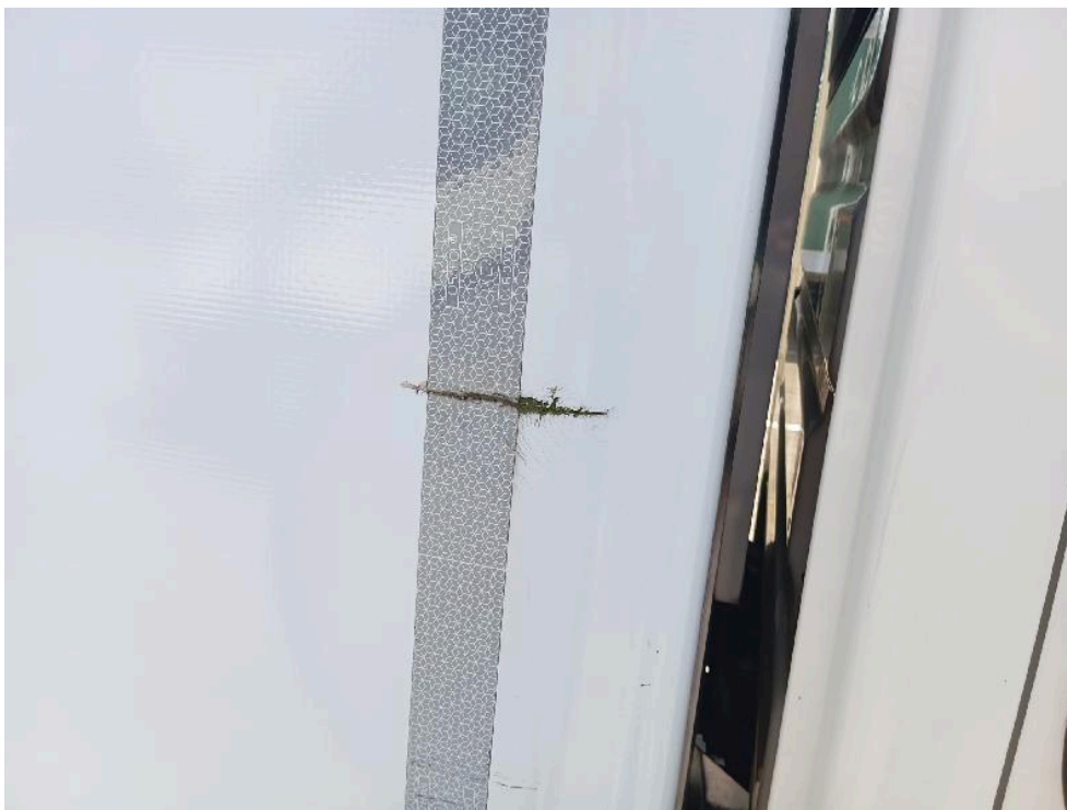
Bild: 39 Kühlkofferseitenwand rechts unten leicht eingedrückt und verkratzt
