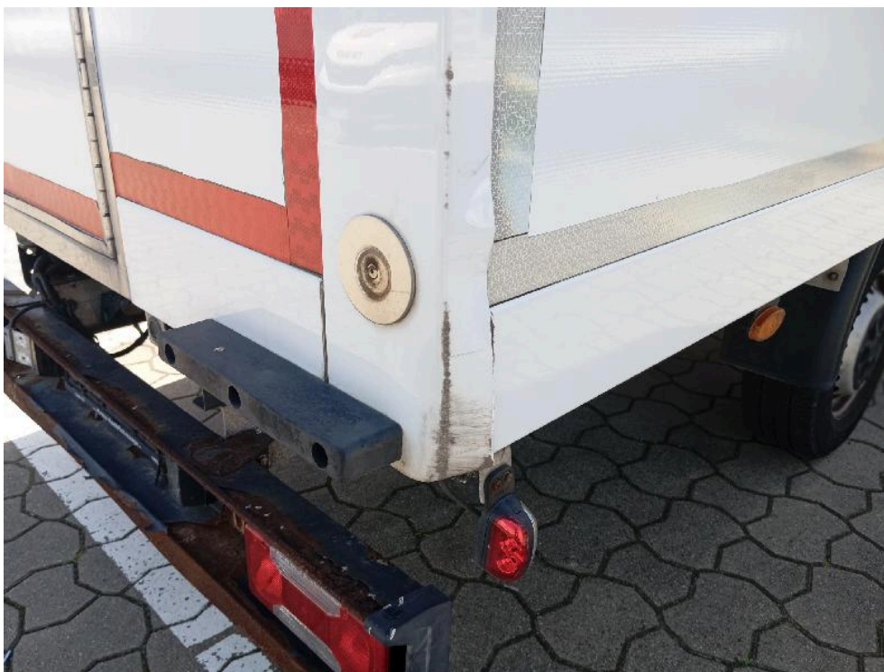
Bild: 36 Ecke Kühlkoffer rechts aufgestaucht
