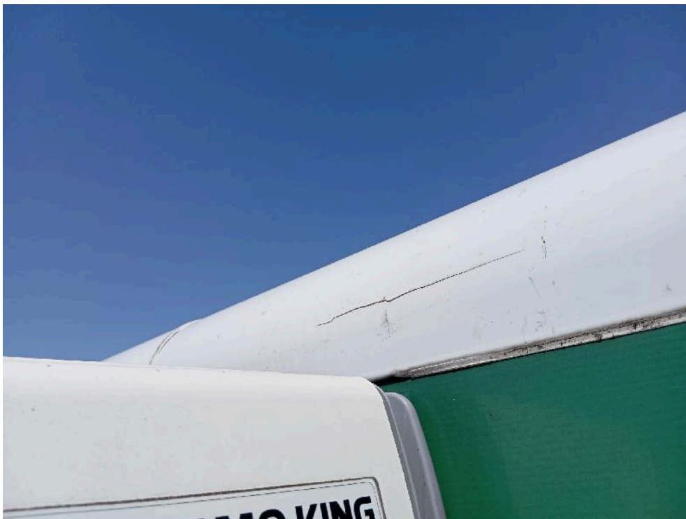
Bild: 30 Dachlauf Kühlkoffer Rissbildung
