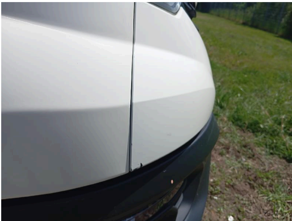
Bild: 43 Frontblende leicht angeschlagen
