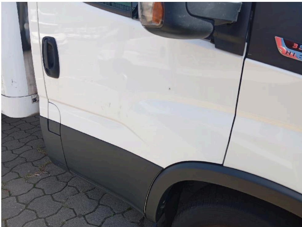
Bild: 42 Tür vorn rechts verformt und verkratzt
