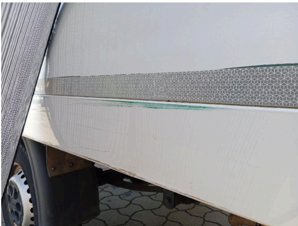
Bild: 38 Kühlkofferseitenwand rechts unten leicht eingedrückt und verkratzt
