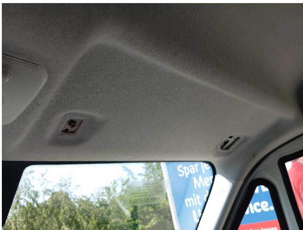
Bild: 18 Sonnenblende rechts abgerissen
