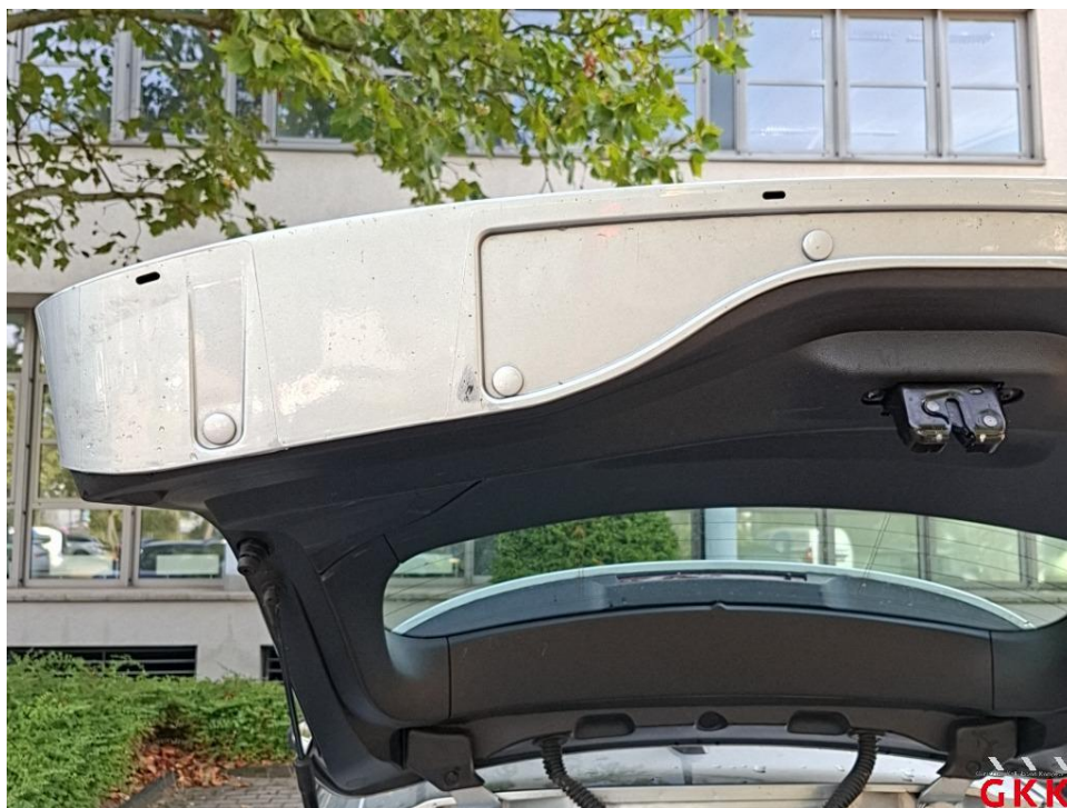
Bild 20. Heckklappe, unterhalb, verkratzt, Smartrepair
