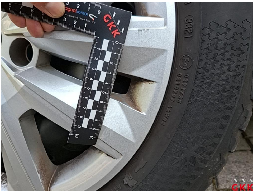
Bild 34. Radkappe(n), vorne rechts, verkratzt, ersetzen
