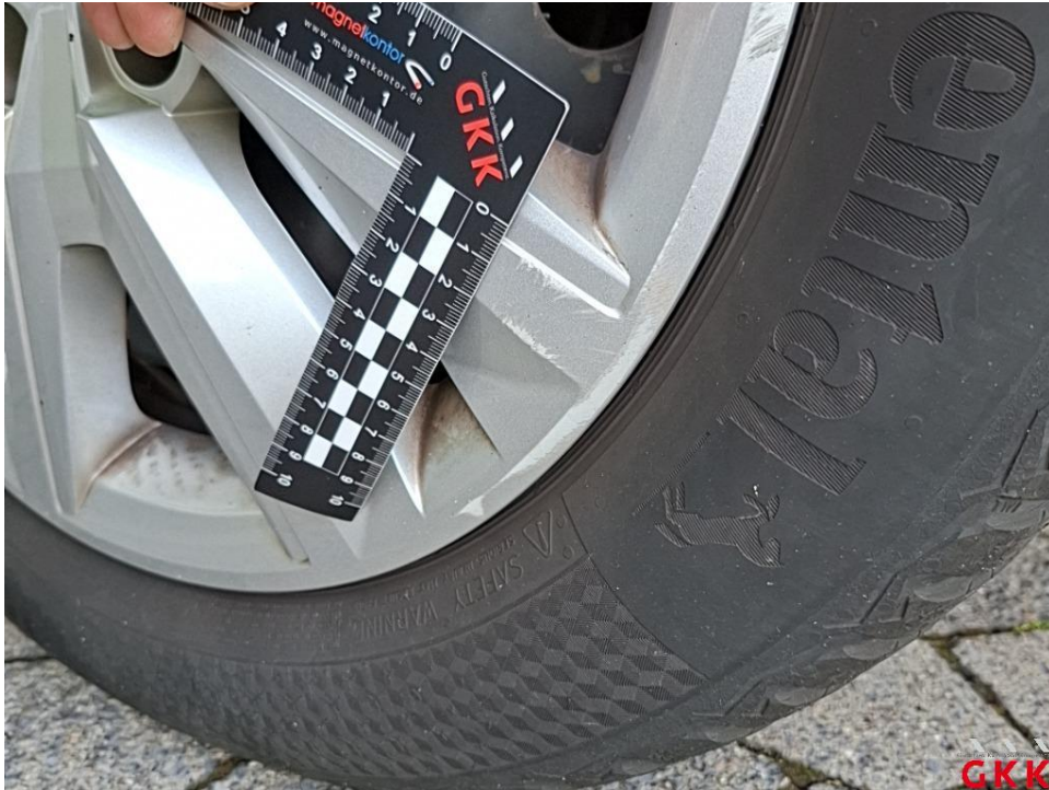
Bild 17. Radkappe(n), hinten links, verkratzt, ersetzen
