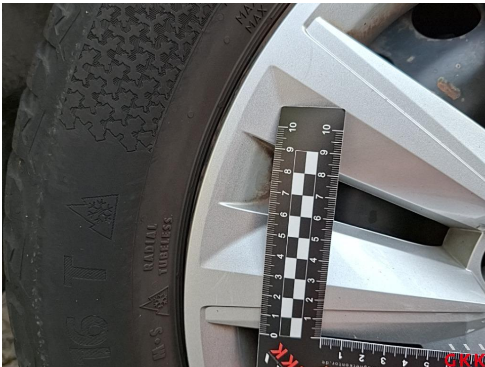
Bild 24. Radkappe(n), hinten rechts, verkratzt, ersetzen
