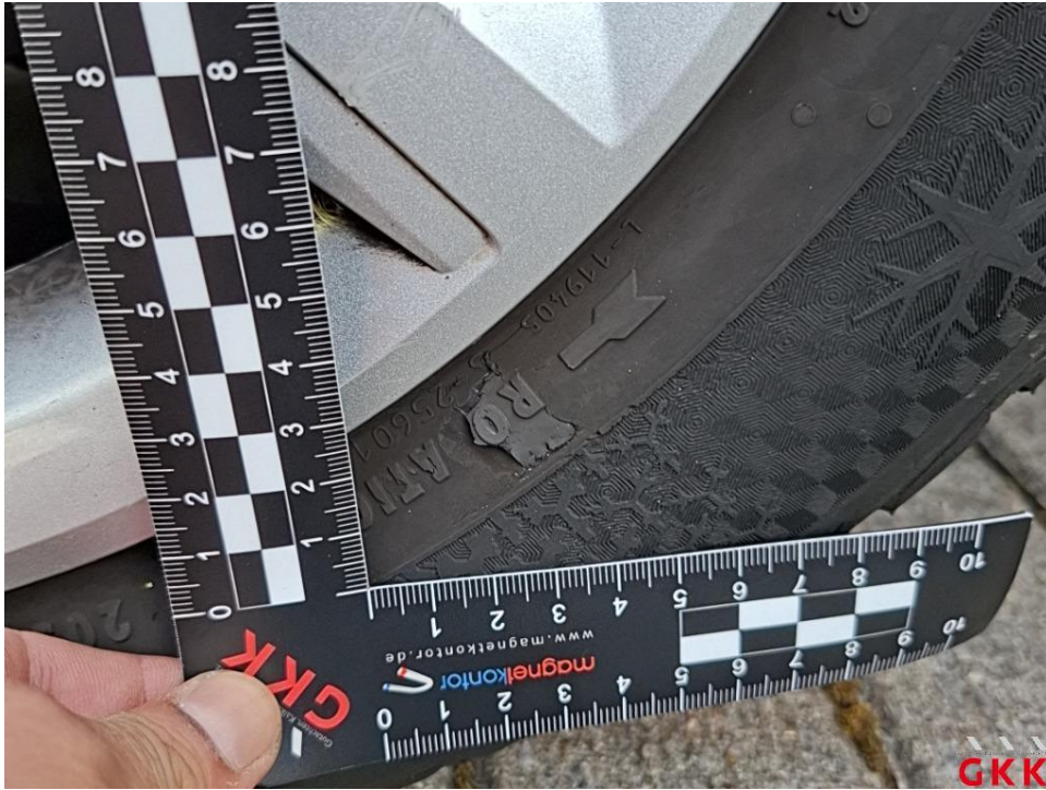
Bild 37. Reifen, vorne rechts, beschädigt, ersetzen
