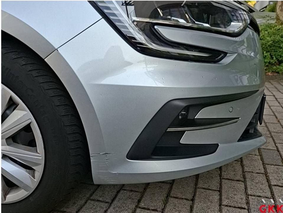
Bild 29. Stoßfänger vorne, Verkleidung -lackiert-, verkratzt, ersetzen
