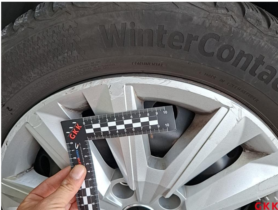
Bild 14. Radkappe(n), vorne links, verkratzt, ersetzen
