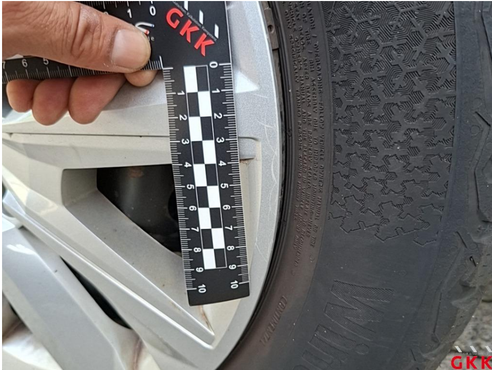
Bild 23. Radkappe(n), hinten rechts, verkratzt, ersetzen
