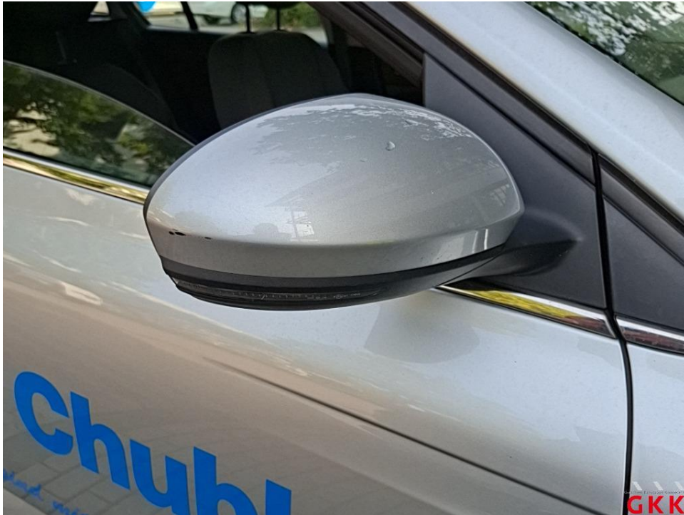
Bild 27. Spiegelgehäuse rechts, Kappe -lackiert-, verkratzt, lackieren
