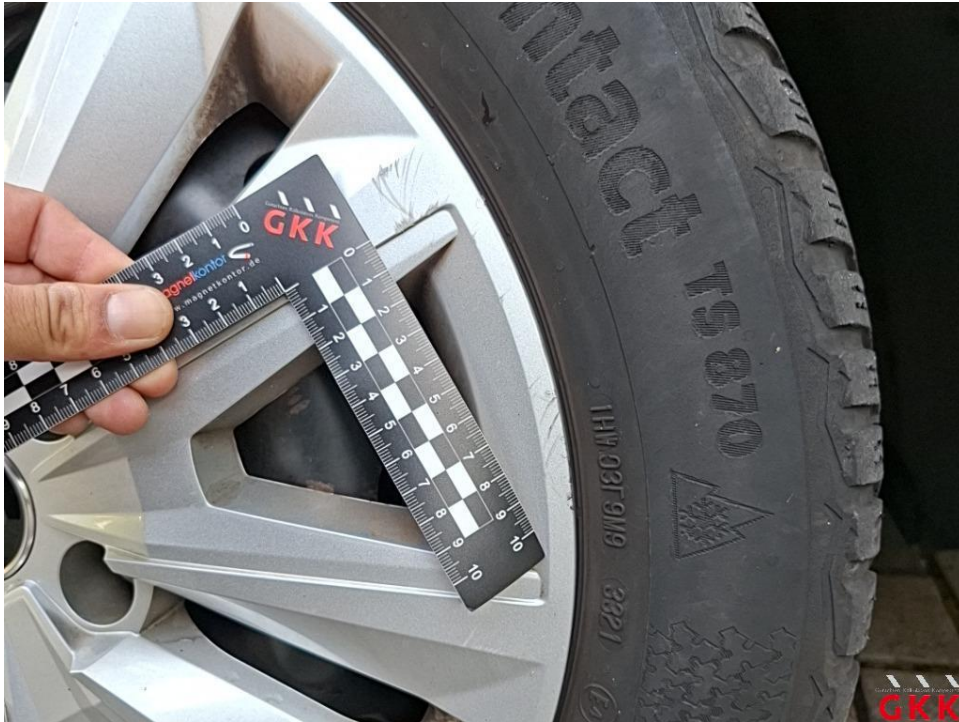
Bild 35. Radkappe(n), vorne rechts, verkratzt, ersetzen
