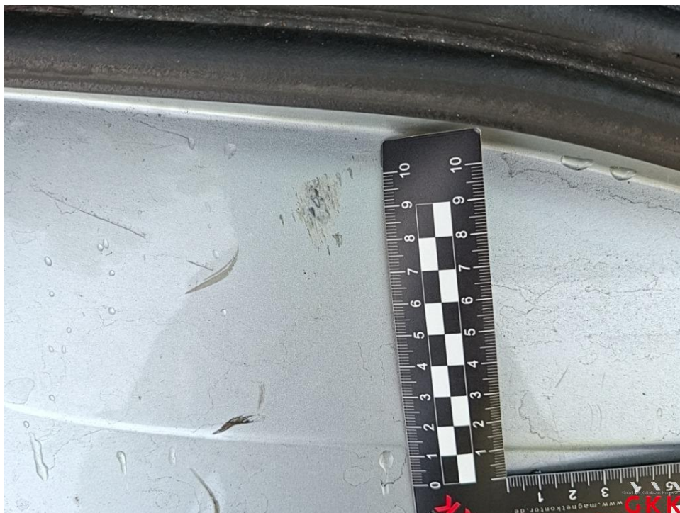
Bild 19. Stoßfänger hinten, Verkleidung -lackiert-, verkratzt, Smartrepair
