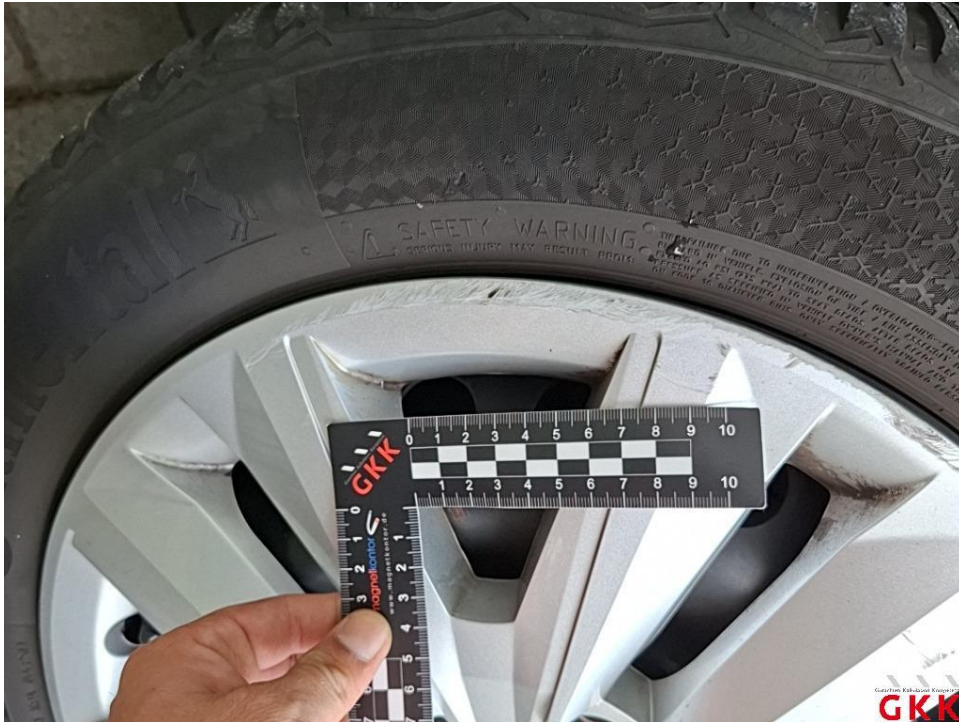
Bild 15. Radkappe(n), vorne links, verkratzt, ersetzen
