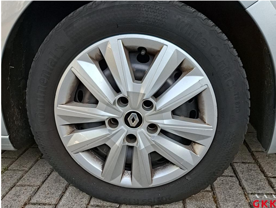
Bild 33. Radkappe(n), vorne rechts, verkratzt, ersetzen
