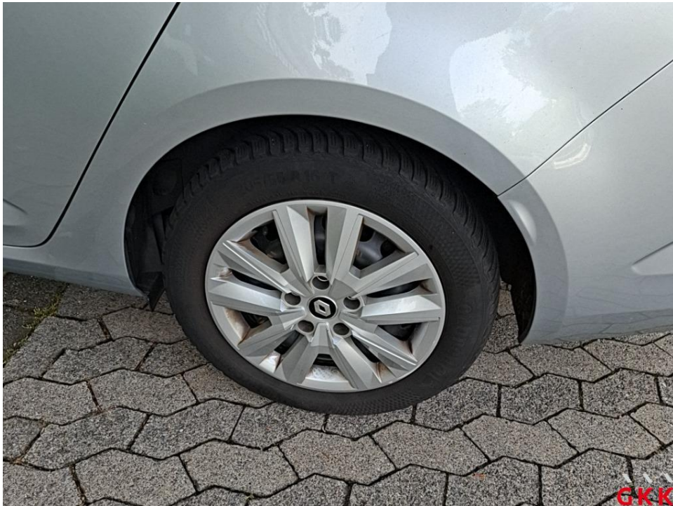
Bild 16. Radkappe(n), hinten links, verkratzt, ersetzen
