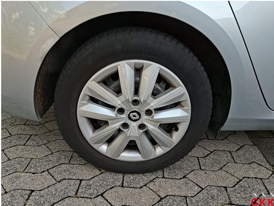
Bild 22. Radkappe(n), hinten rechts, verkratzt, ersetzen
