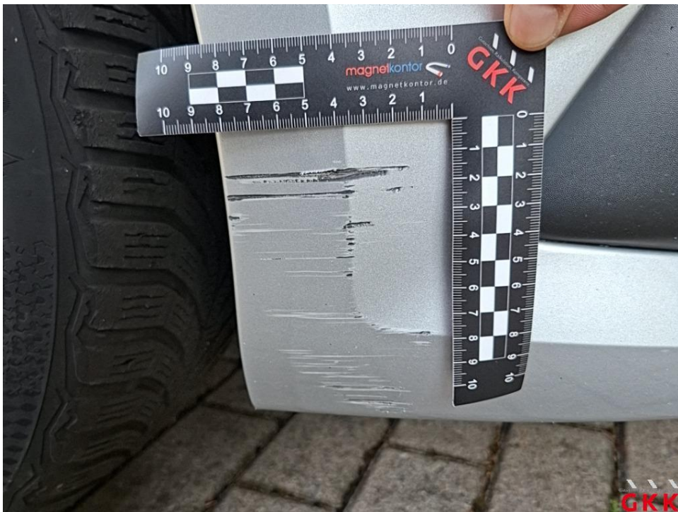
Bild 30. Stoßfänger vorne, Verkleidung -lackiert-, verkratzt, ersetzen
