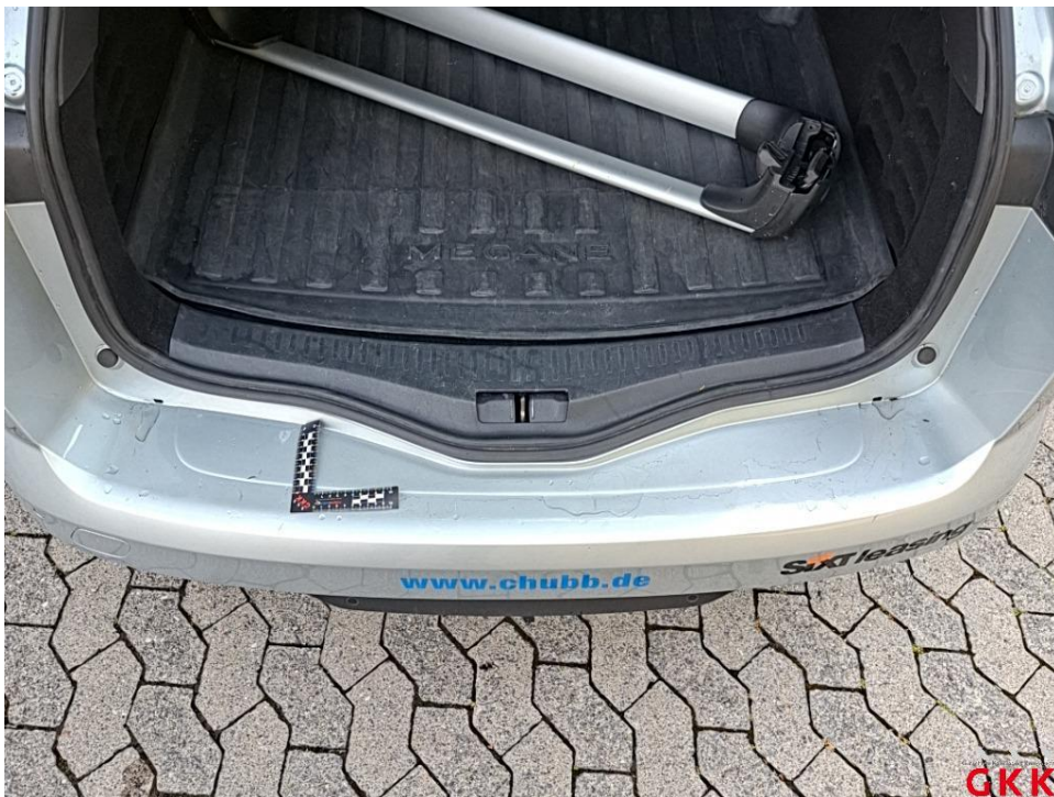
Bild 18. Stoßfänger hinten, Verkleidung -lackiert-, verkratzt, Smartrepair
