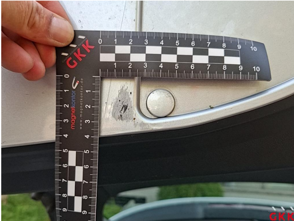
Bild 21. Heckklappe, unterhalb, verkratzt, Smartrepair
