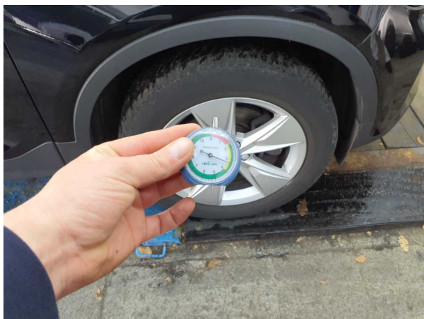
Beschädigung #3: Rad/Reifen: Reifen vorn - verschlissen - erneuern
