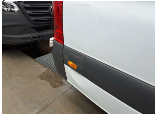
Beschädigung #4: Seitenwand rechts: Schutzleiste - beschädigt - erneuern
