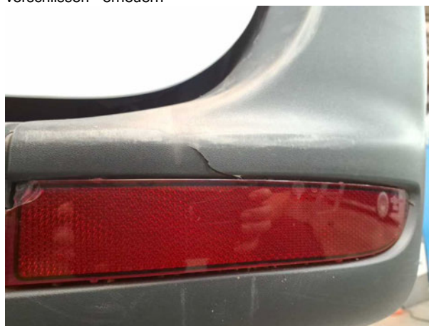
Beschädigung #15: Stossfänger hinten: Stossfänger hinten rechts (Mehrkosten möglich) - gebrochen / gerissen - erneuern
