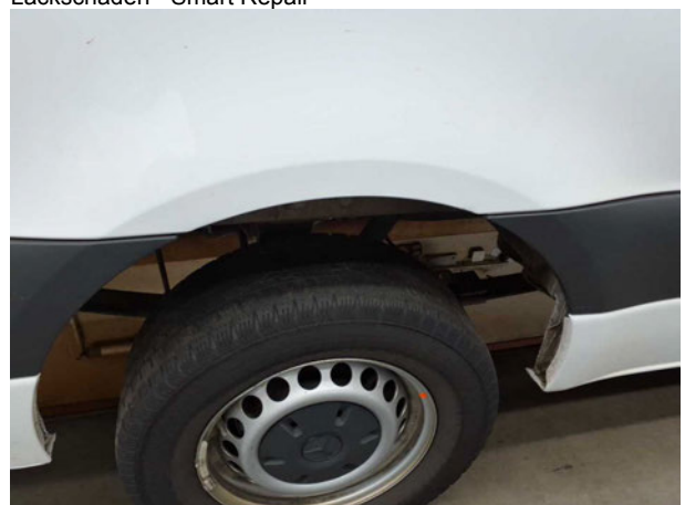
Beschädigung #13: Festpreis: Reifen 235/65 R16C (HR) - verschlissen - erneuern
