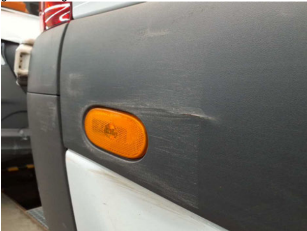
Beschädigung #4: Seitenwand rechts: Schutzleiste - beschädigt - erneuern
