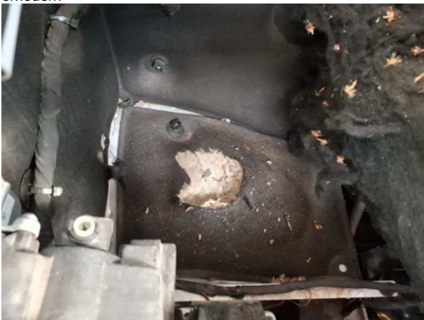
Beschädigung #5: Fahrerhaus: Dämmmatte - Marderschaden - erneuern
