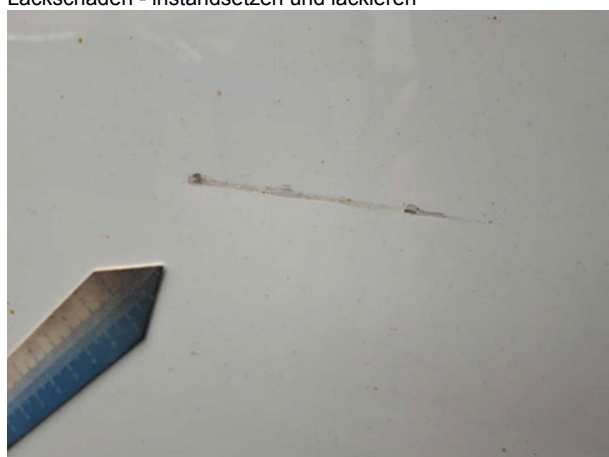
Beschädigung #24: Seitenwand rechts: Seitenwand - Delle / Lackschaden - instandsetzen/lackieren (S1)
