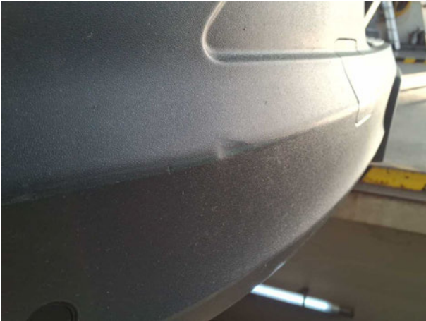
Beschädigung #6: Stossfänger vorn: Stossfänger mit Parktronic - beschädigt - Smart Repair
