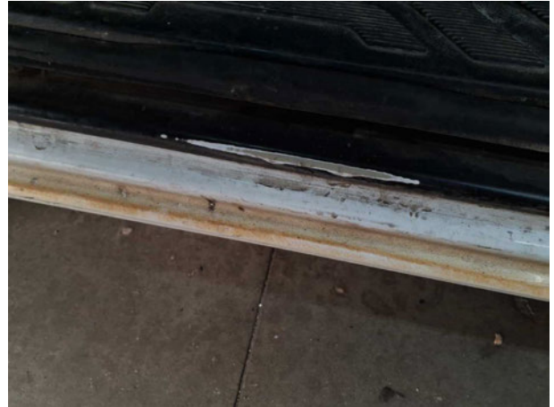
Beschädigung #17: Schweller links: Einstieg - verkratzt / versch... - lackieren
