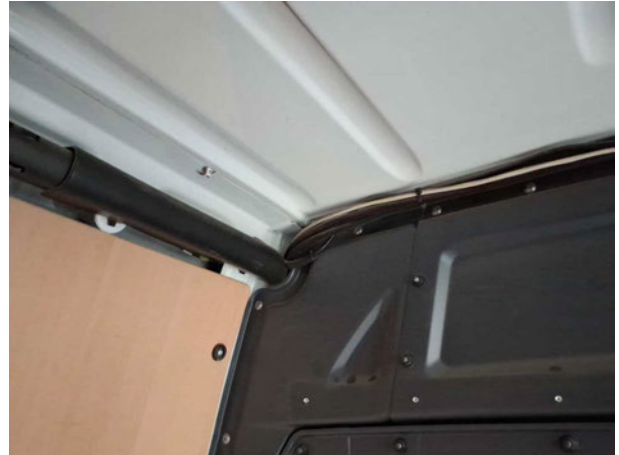
Beschädigung #11: elektrisches System: Kabelstrang - entspricht nicht den Herstellervorgaben - de-/montieren
