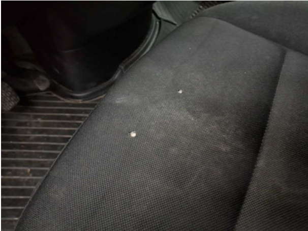
Beschädigung #18: Sitz vorn: Sitzbezug links - Brandloch - erneuern
