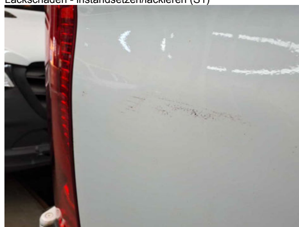
Beschädigung #24: Seitenwand rechts: Seitenwand - Delle / Lackschaden - instandsetzen/lackieren (S1)
