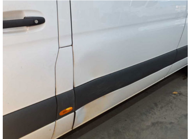
Beschädigung #22: Seitenwand links: Seitenwand (Vorne oben) - verformt - instandsetzen und lackieren
