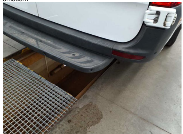
Beschädigung #19: Stossfänger hinten: Verkl. Stossfänger Auftritt mit Parktronic - verformt - erneuern
