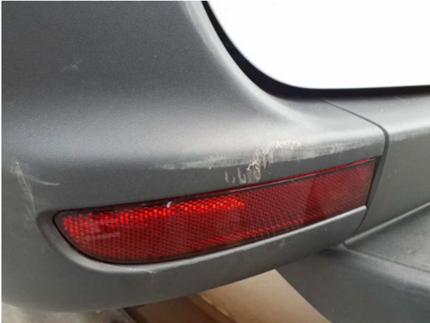
Beschädigung #16: Stossfänger hinten: Stossfänger hinten links - verkratzt / verschürft - erneuern
