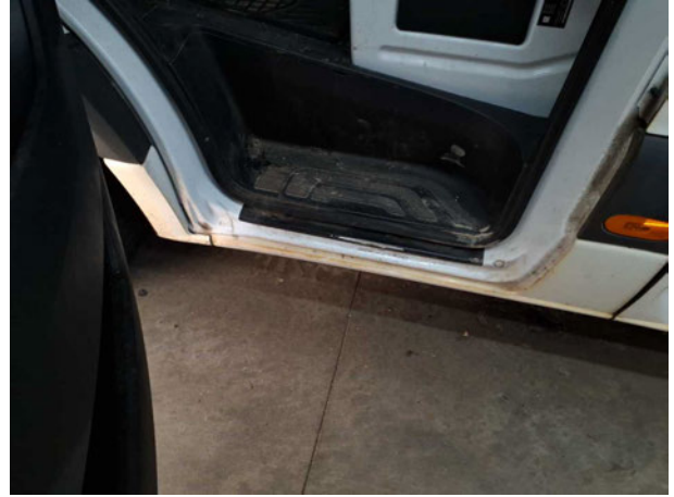
Beschädigung #3: Tür vorn links: Türdichtung - gebrochen / gerissen - erneuern
