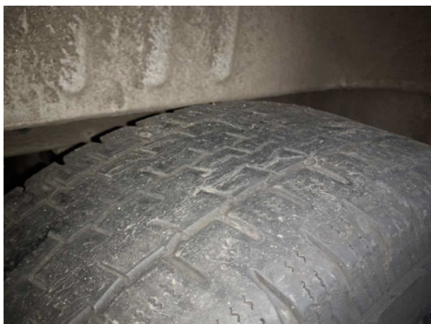
Beschädigung #13: Festpreis: Reifen 235/65 R16C (HR) - verschlissen - erneuern
