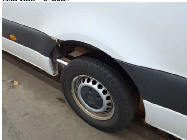
Beschädigung #14: Festpreis: Reifen 235/65 R16C (HL) - verschliss... - erneuern
