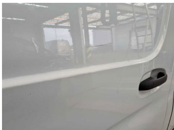
Beschädigung #23: Schiebetür rechts: Schiebetür - Delle / Lackschaden - instandsetzen und lackieren
