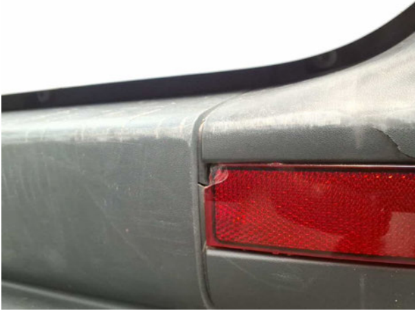
Beschädigung #2: Stossfänger hinten: Rückstrahler rechts - gebrochen / gerissen - erneuern
