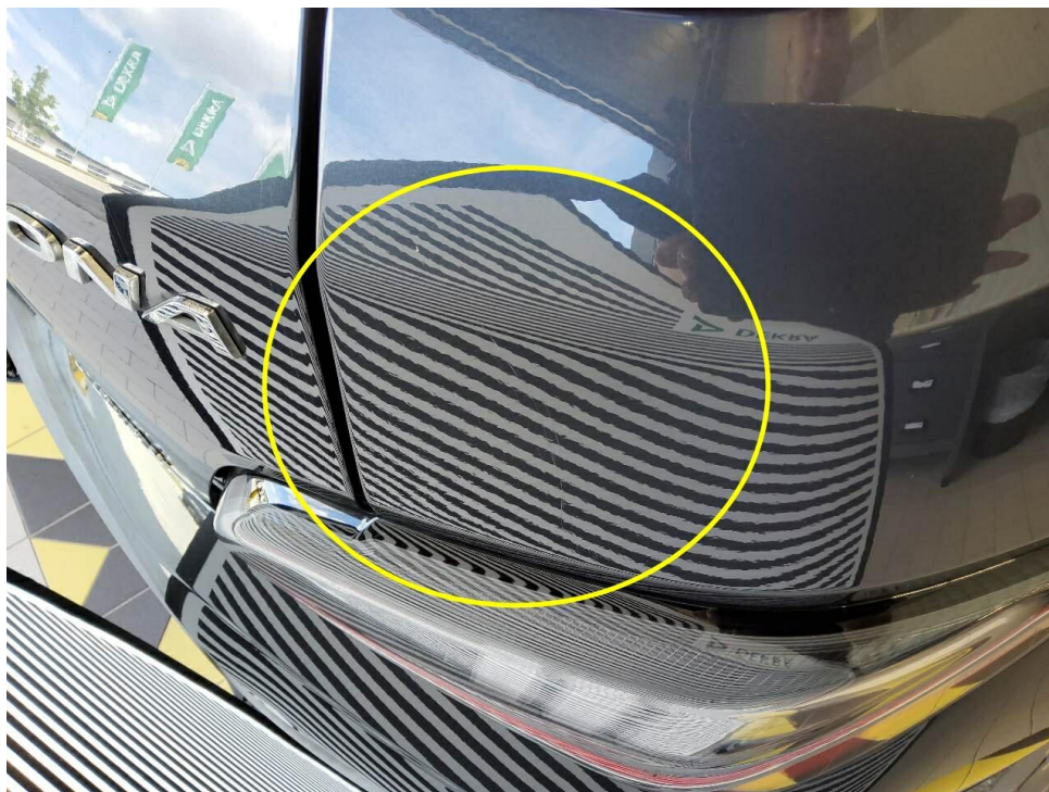
Bild 9 : Seitenwand hinten rechts, verkratzt
