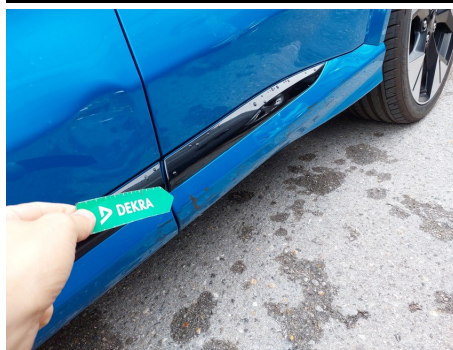
Moldura de puerta / Trasero Izquierdo / Abolladura
