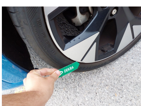
Llanta / Delantero Izquierdo / Abolladura
