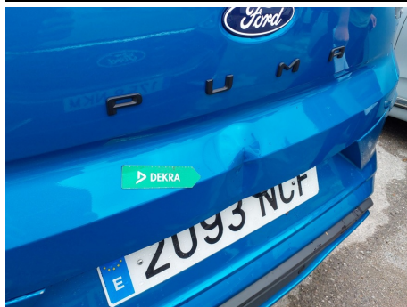
Portón trasero / puerta del maletero / - / Abolladura
