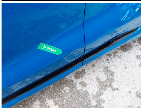
Puerta / Delantero Izquierdo / Abolladura
