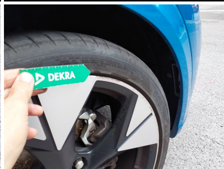
Neumático / Delantero Derecho / Desgarro
