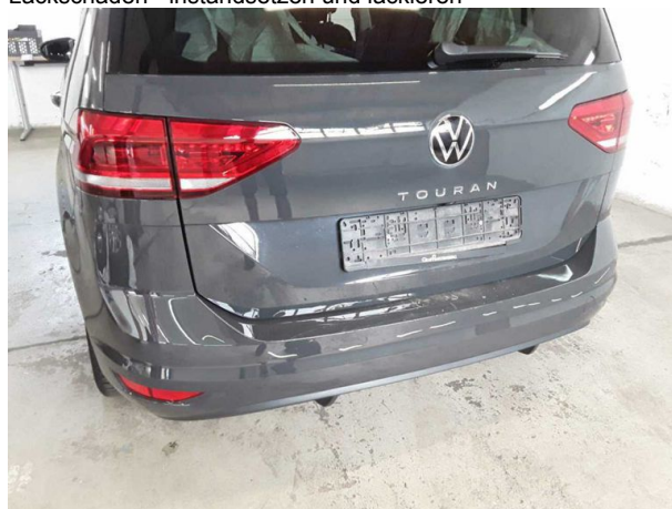
Beschädigung #11: Stossfänger hinten: Stossfänger hinten - verformt - erneuern
