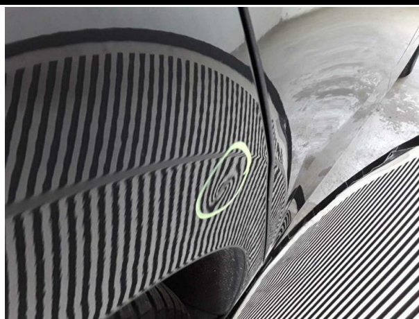
Beschädigung #6: Seitenwand rechts: Seitenwand - Delle(n) - sanft instandsetzen
