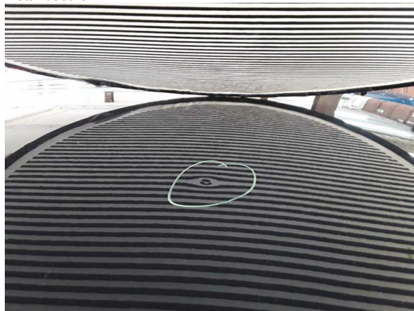
Beschädigung #7: Fahrzeugdach: Dach - Delle(n) - sanft instandsetzen
