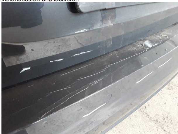
Beschädigung #11: Stossfänger hinten: Stossfänger hinten - verformt - erneuern
