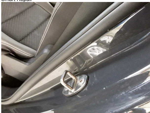
Beschädigung #5: Seitenwand links: Einstieg - Delle(n) - sanft instandsetzen
