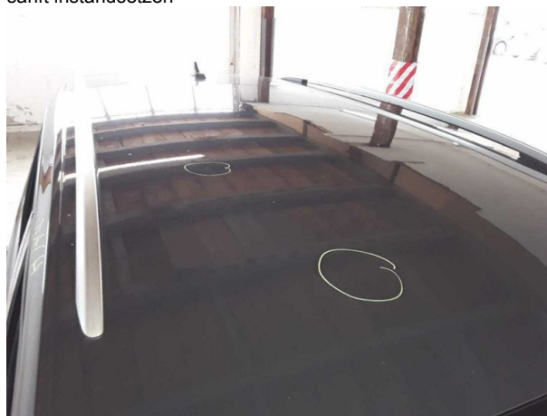
Beschädigung #7: Fahrzeugdach: Dach - Delle(n) - sanft instandsetzen
