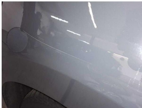
Beschädigung #2: Seitenwand links: Seitenwand - Kratzer - auslegen / polieren
