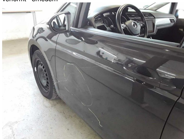
Beschädigung #12: Tür vorn links: Tür - verformt - erneuern
