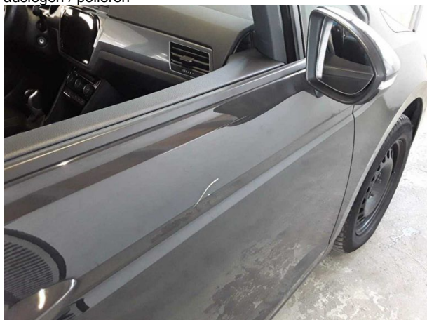
Beschädigung #4: Tür vorn rechts: Tür - verkratzt / verschürft - Smart Repair
