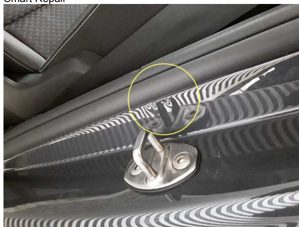
Beschädigung #5: Seitenwand links: Einstieg - Delle(n) - sanft instandsetzen
