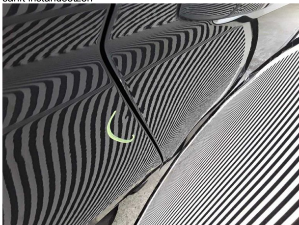
Beschädigung #6: Seitenwand rechts: Seitenwand - Delle(n) - sanft instandsetzen
