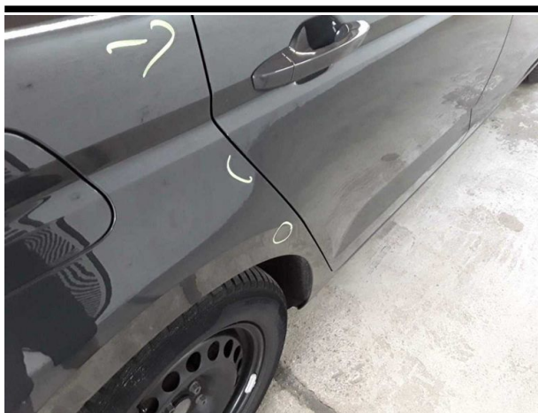
Beschädigung #6: Seitenwand rechts: Seitenwand - Delle(n) - sanft instandsetzen
