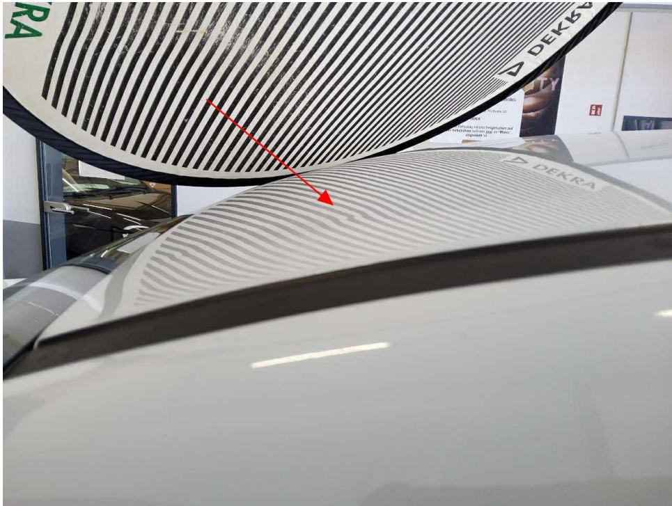
Bild 11 : Dach, mehrfach eingedellt
