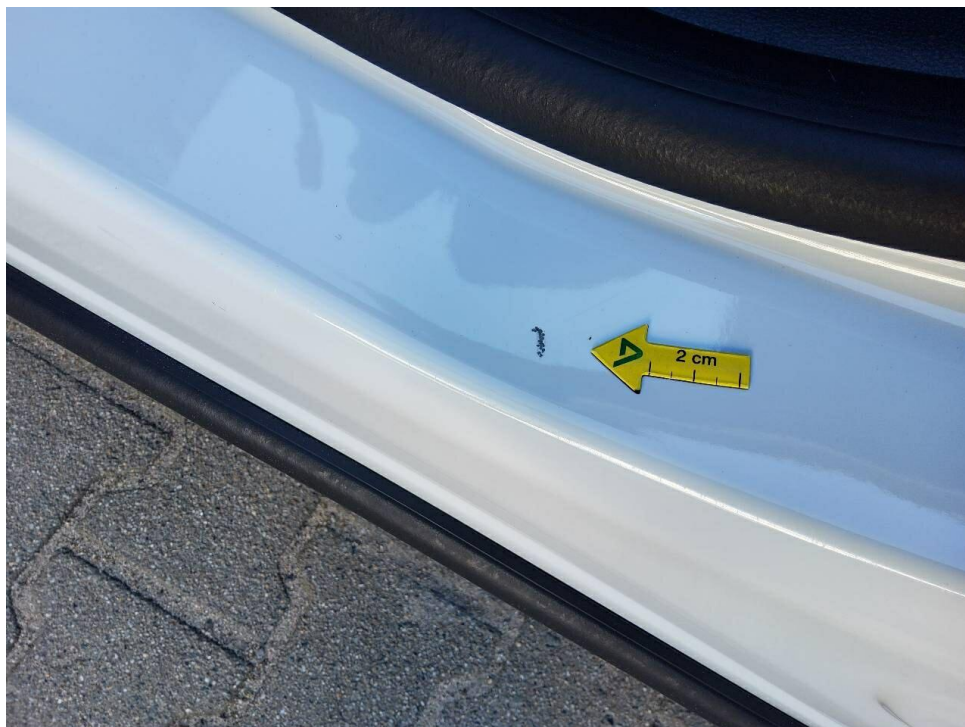
Bild 10 : Einstieg vorne links, Lackierung zerkratzt
