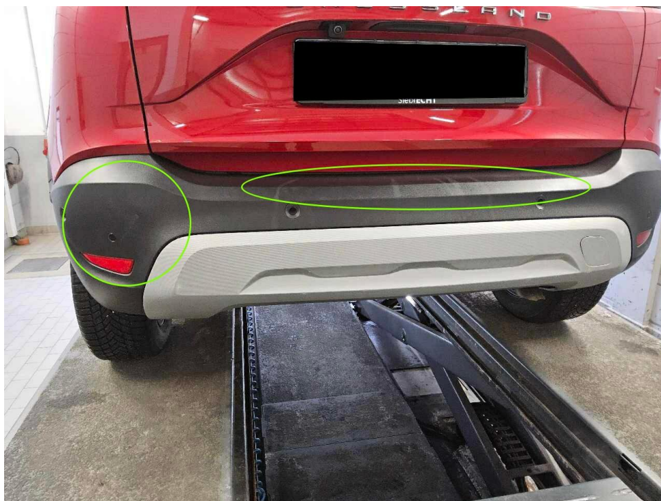
Bild 19 : Stoßfängerverkleidung hinten verschrammt
