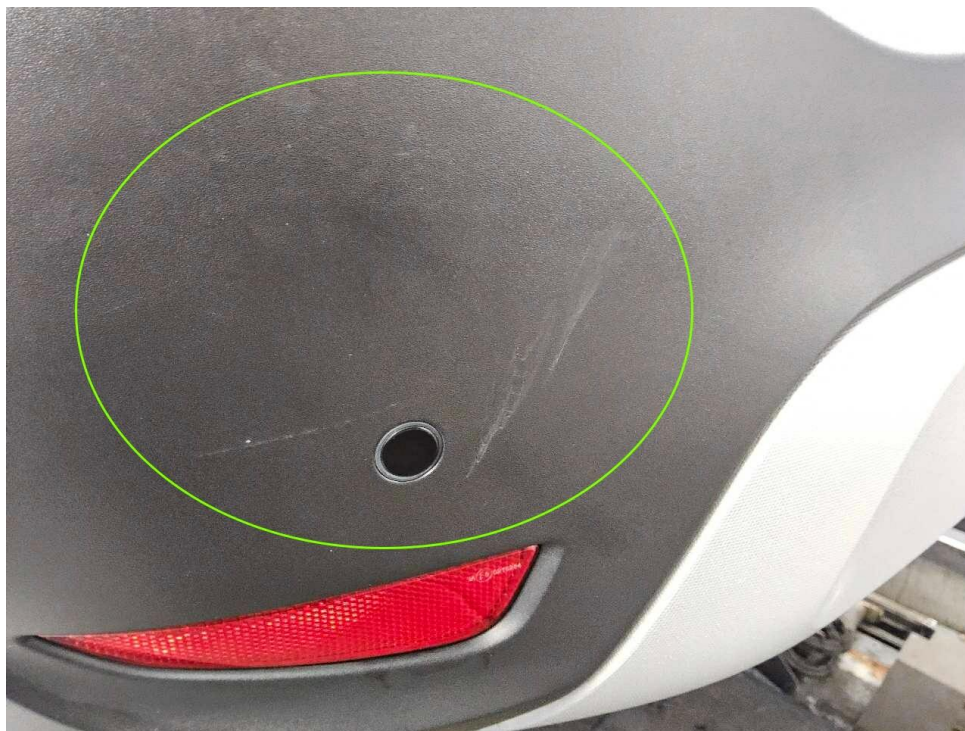
Bild 20 : Stoßfängerverkleidung hinten verschrammt
