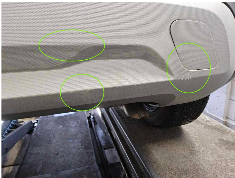
Bild 22 : Diffusor hinten verschrammt
