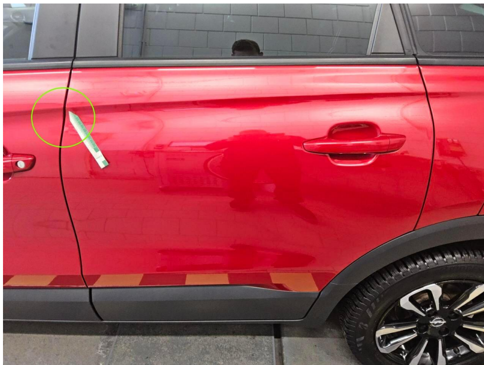
Bild 15 : Tür hinten links Türkante, Lackabplatzer, smart repair
