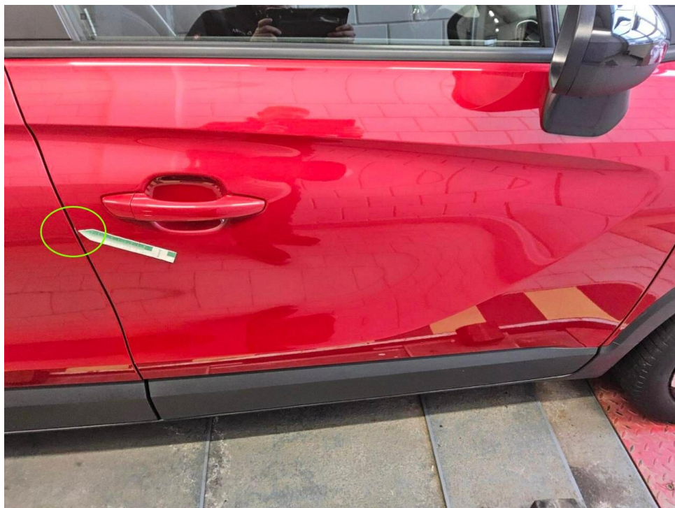
Bild 26 : Tür vorne rechts Türkante, Lackabplatzer, smart repair
