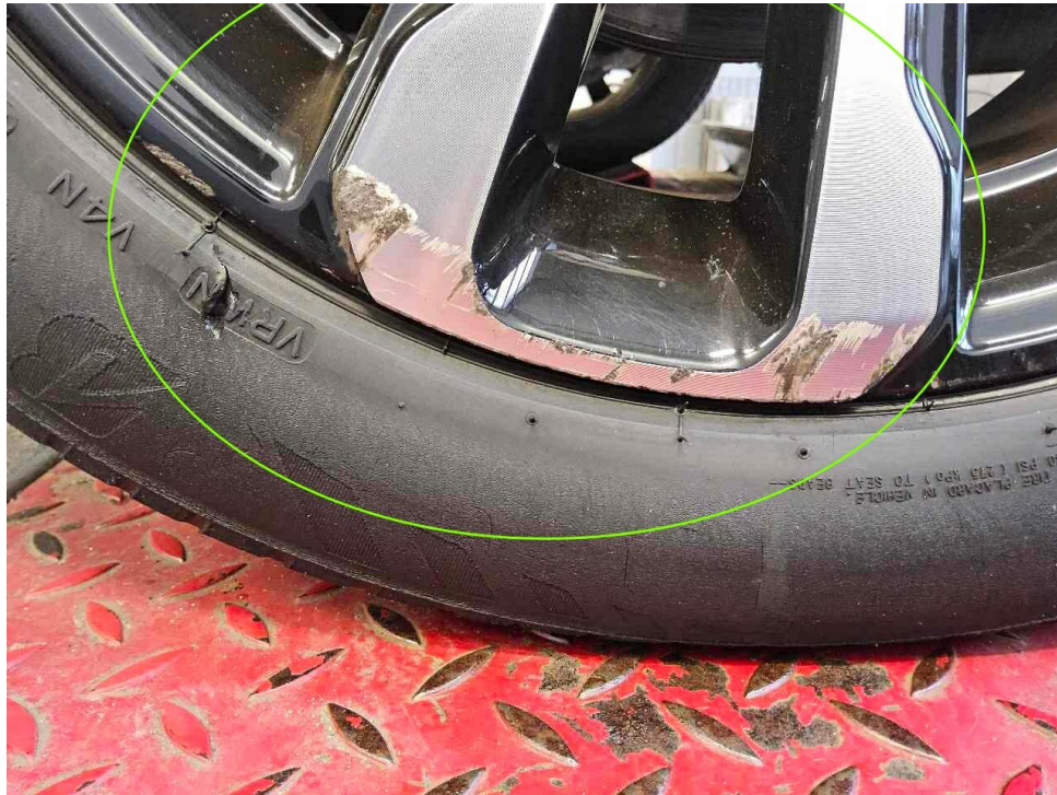
Bild 31 : Alufelge glanzgedreht vorne rechts verschrammt mit Materialabtrag
