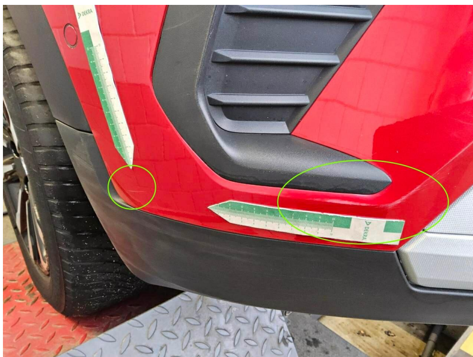
Bild 14 : Stoßfänger vorne Lackierung, verschrammt, smart repair
