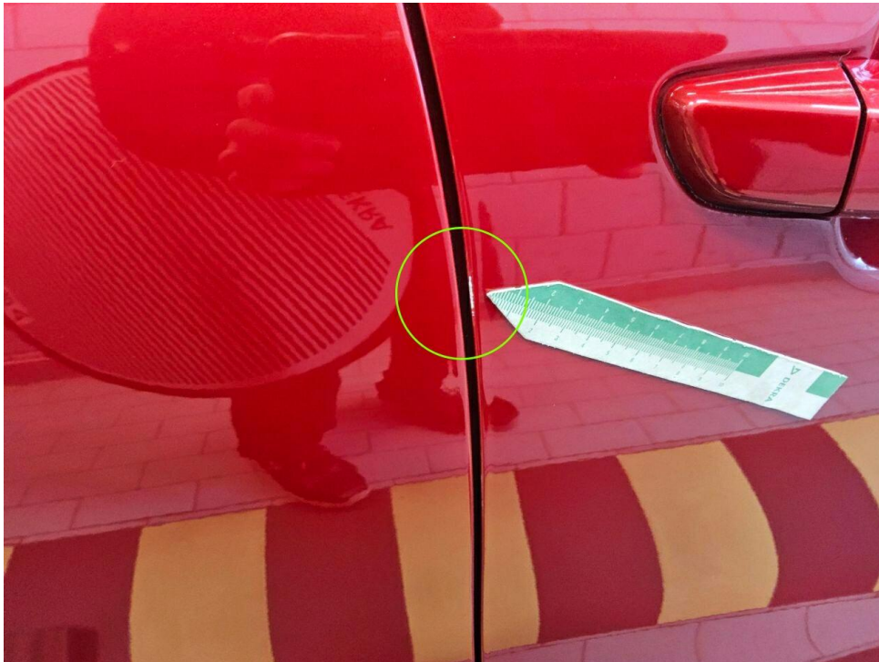
Bild 27 : Tür vorne rechts Türkante, Lackabplatzer, smart repair
