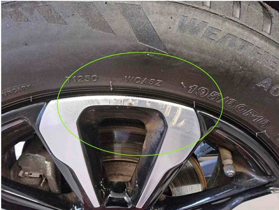
Bild 33 : Alufelge glanzgedreht vorne links verschrammt mit Materialabtrag
