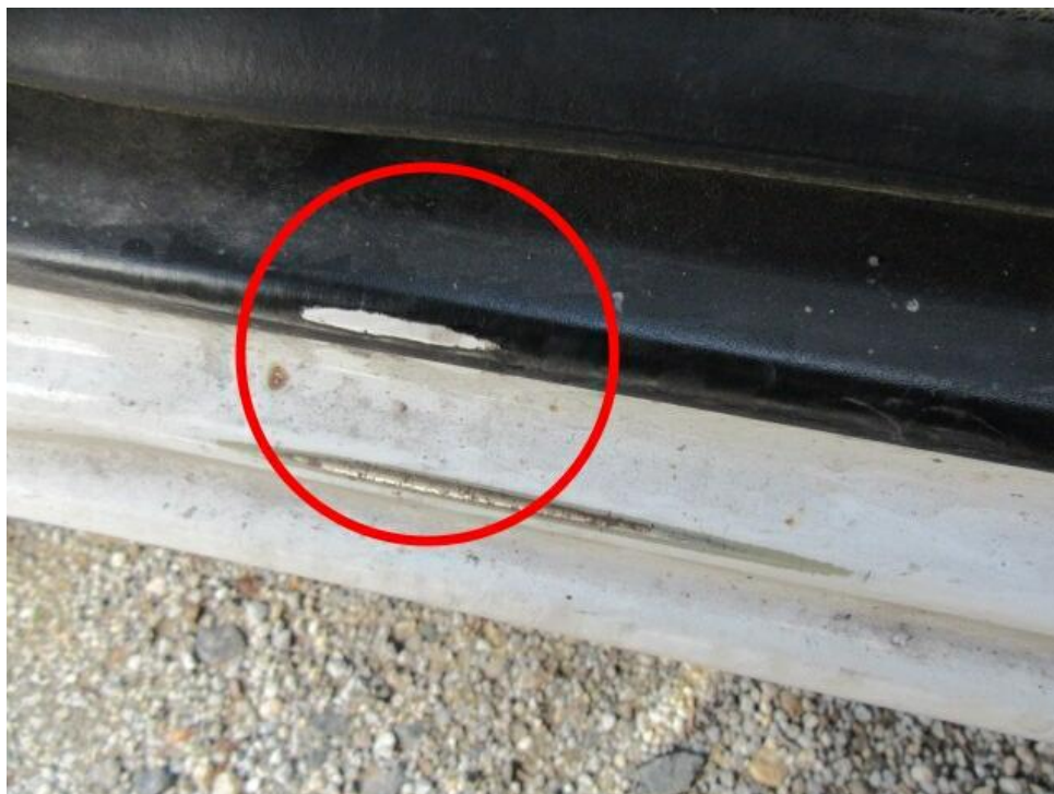
Bild 14 : Einstieg vorne links Lackabtragungen Folie Einstieg vorne links schadhaft
