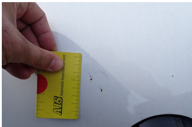
Gebrauchsspur 2: Motor: Motorabdeckung - Steinschlag - kein Abzug
