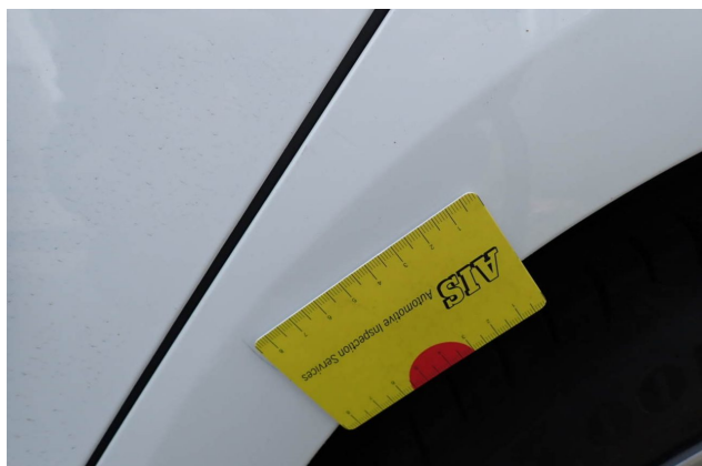
Beschädigung 6: Seitenwand links: Radhausverbreiterung - Delle(n) - Smart Repair
