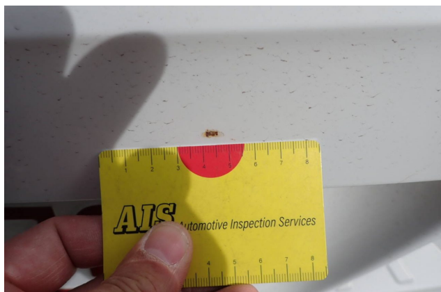
Gebrauchsspur 1: Heckklappe/-tür: Heckklappe - Kratzer - kein Abzug
