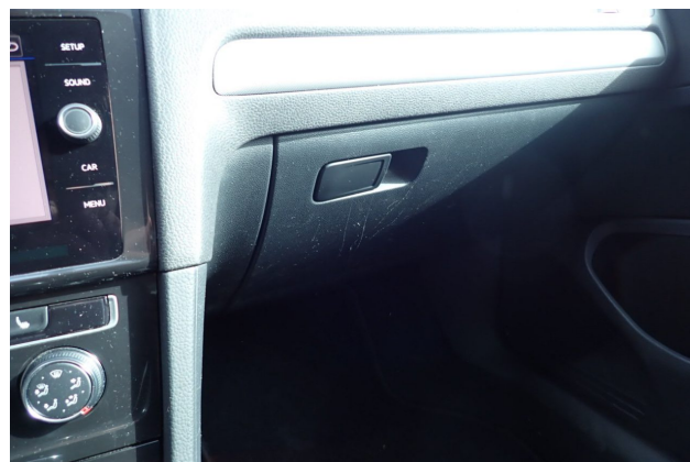
Beschädigung 4: Instrumententafel: Handschuhfach - verkratzt / verschürft - Smart Repair
