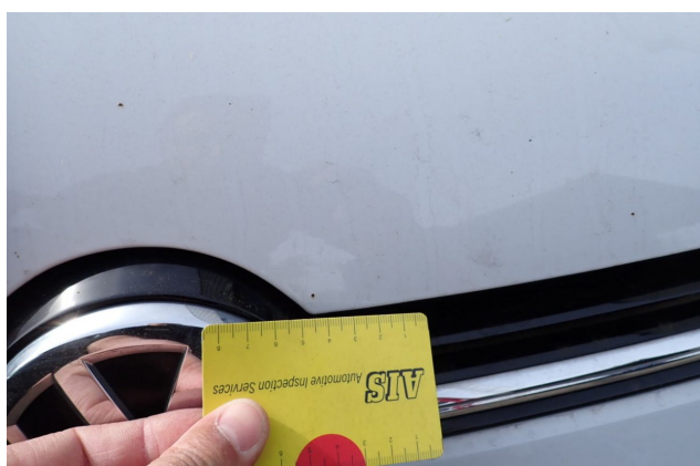
Gebrauchsspur 2: Motor: Motorabdeckung - Steinschlag - kein Abzug
