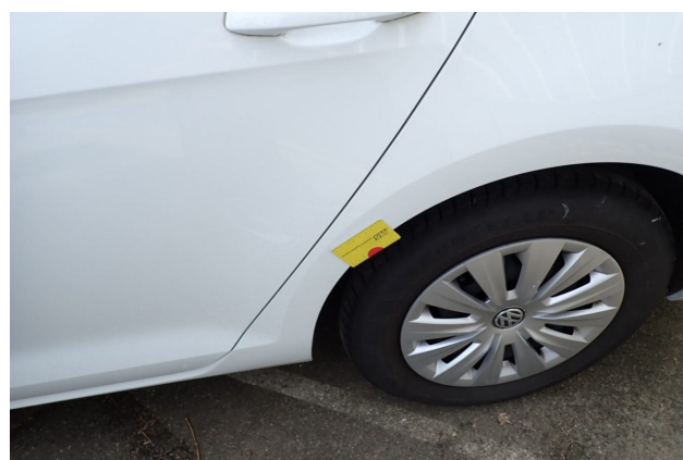
Beschädigung 6: Seitenwand links: Radhausverbreiterung - Delle(n) - Smart Repair
