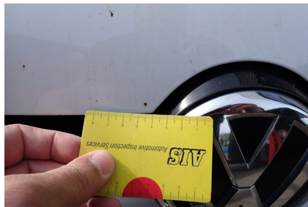
Gebrauchsspur 2: Motor: Motorabdeckung - Steinschlag - kein Abzug
