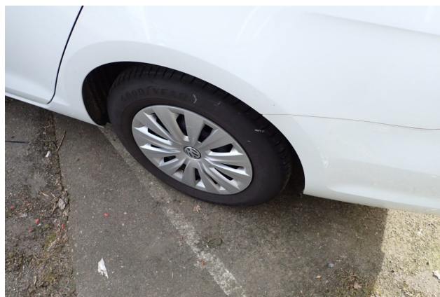
Beschädigung 1: Rad/Reifen: Radblende hinten links - verkratzt / verschürft - erneuern
