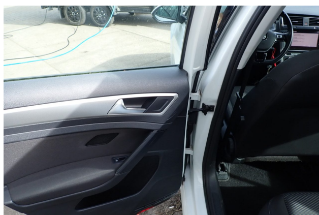
Beschädigung 3: Verkleidungen/Abdeckungen: Türverkleidung hinten links - verkratzt / verschürft - Smart Repair
