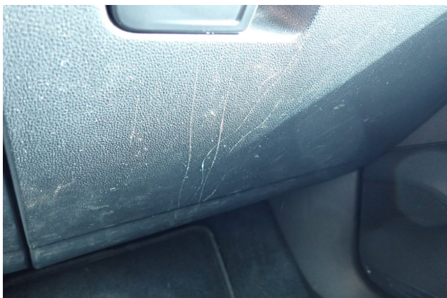
Beschädigung 4: Instrumententafel: Handschuhfach - verkratzt / verschürft - Smart Repair
