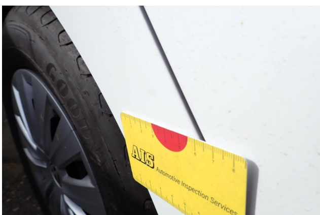
Beschädigung 5: Kotflügel rechts: Radhausverbreiterung - Delle / Lackschaden - Smart Repair
