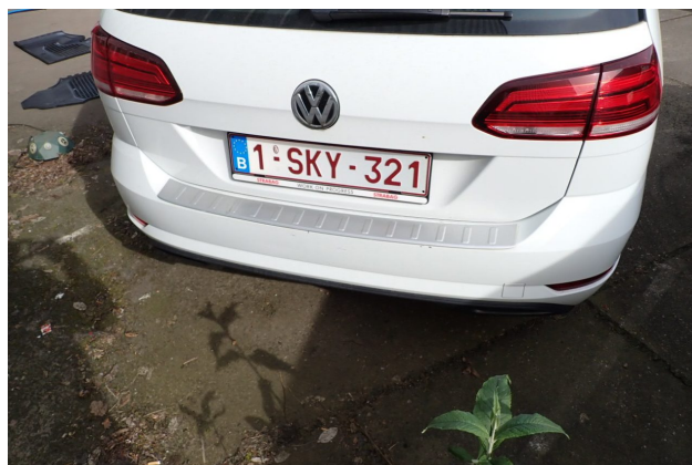
Beschädigung 7: Stossfänger hinten: Stossfänger hinten - verkratzt / verschürft - lackieren
