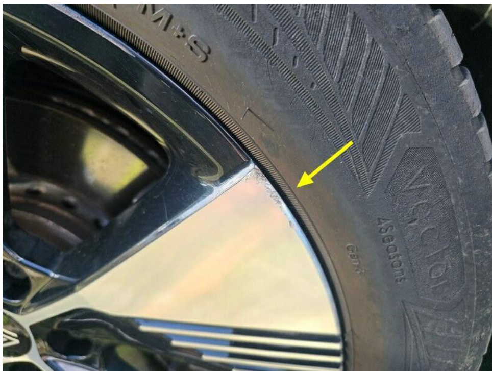
Bild 25 : Felge vorne rechts, beschädigt
