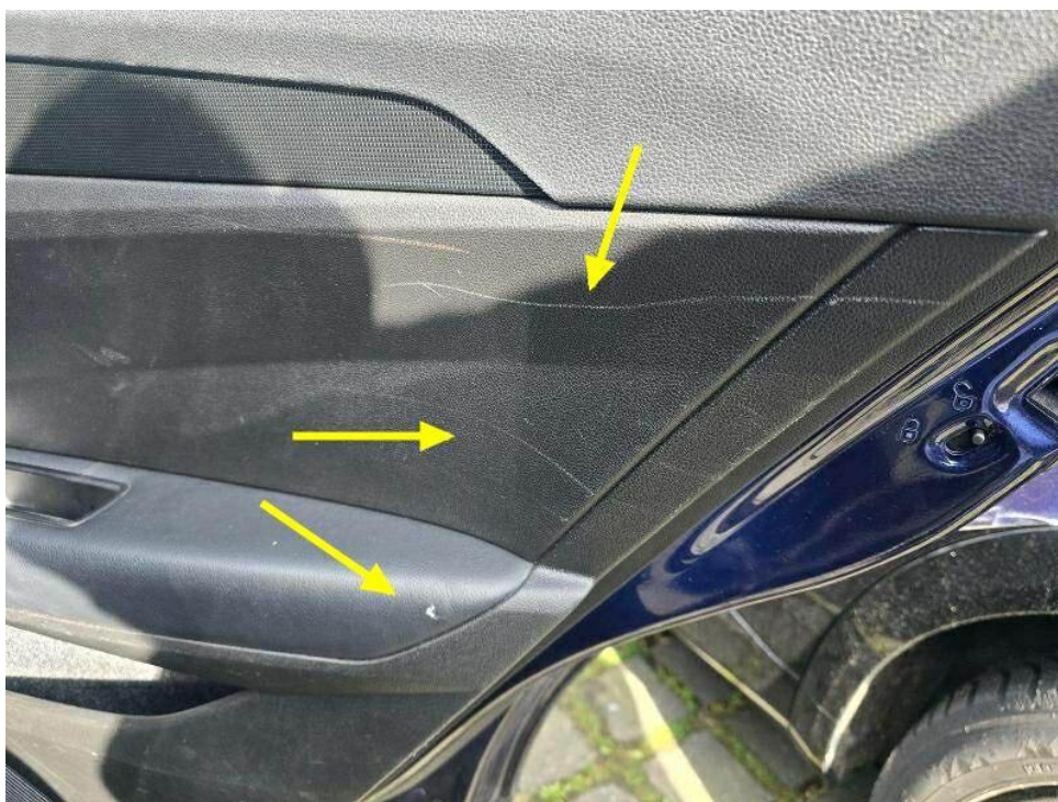
Bild 18 : Türverkleidung hinten rechts, beschädigt
