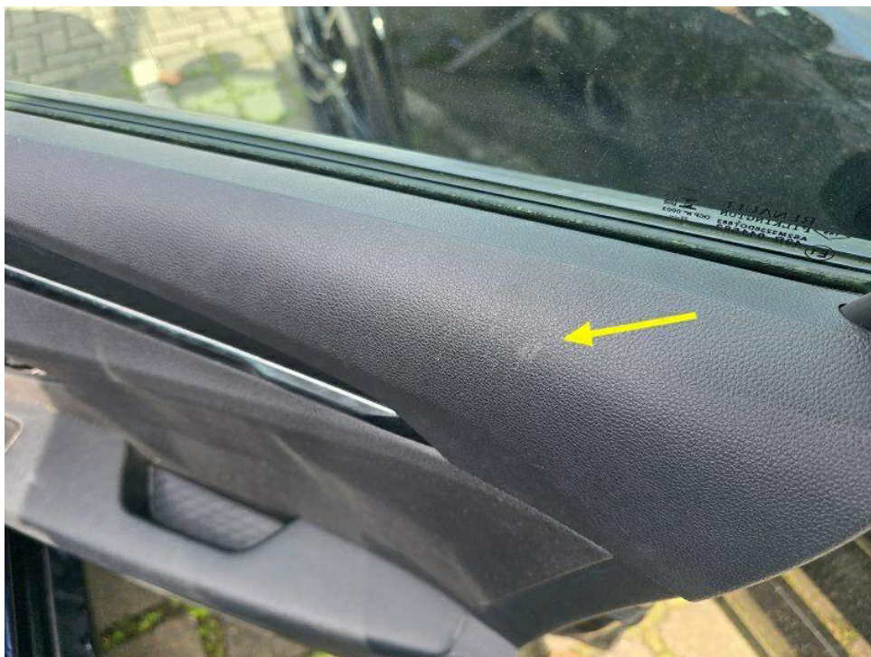
Bild 21 : Verkleidung Tür vorne rechts, zerkratzt, smart repair
