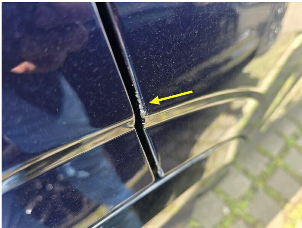
Bild 22 : Tür hinten rechts Türkante, zerkratzt, smart repair
