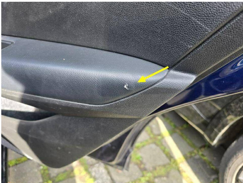
Bild 19 : Türverkleidung hinten rechts, beschädigt
