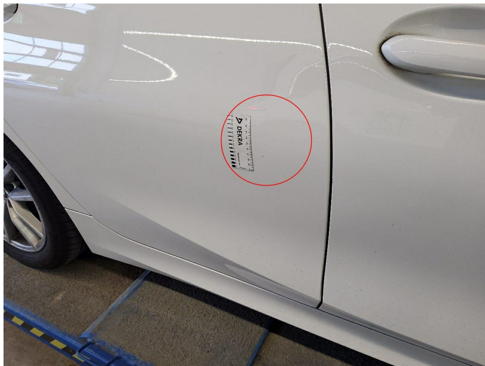
Bild 19 : Tür hinten rechts, eingedellt
