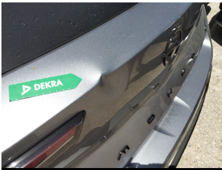
Portón trasero / puerta del maletero / - / Abolladura
