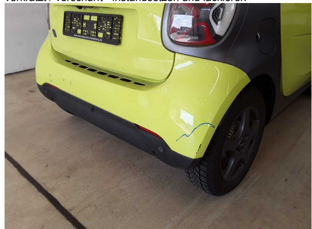
Beschädigung #5: Stoßfänger hinten: Stoßfänger hinten - verkratzt / verschürft - instandsetzen und lackieren
