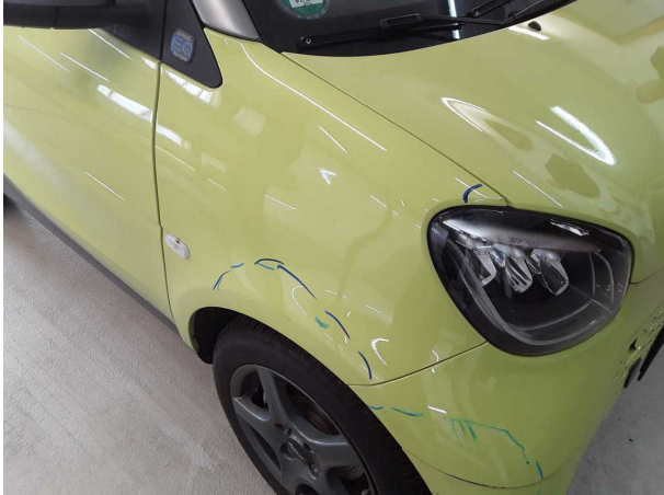
Beschädigung #3: Kotflügel rechts: Kotflügel rechts - verkratzt / verschürft - instandsetzen und lackieren
