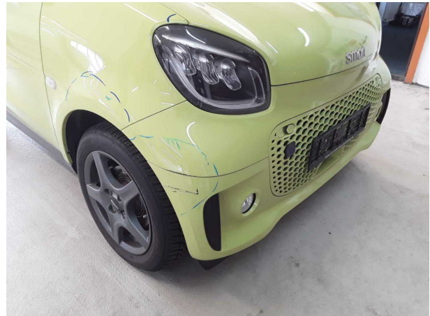
Beschädigung #4: Stoßfänger vorn: Stoßfänger vorn - verkratzt / verschürft - instandsetzen und lackieren
