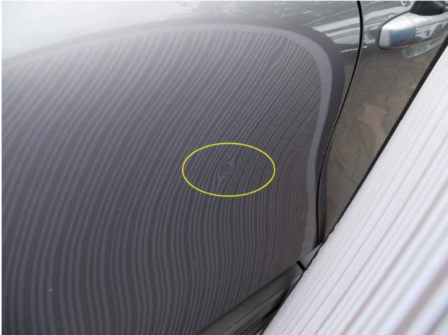
Bild 26 Tür HR Delle.
