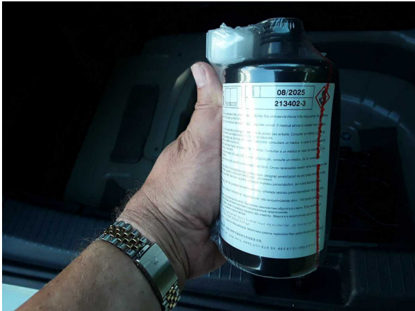
Beschädigung #1: Ausrüstung: Tirefit Füllmittel - abgelaufen - erneuern
