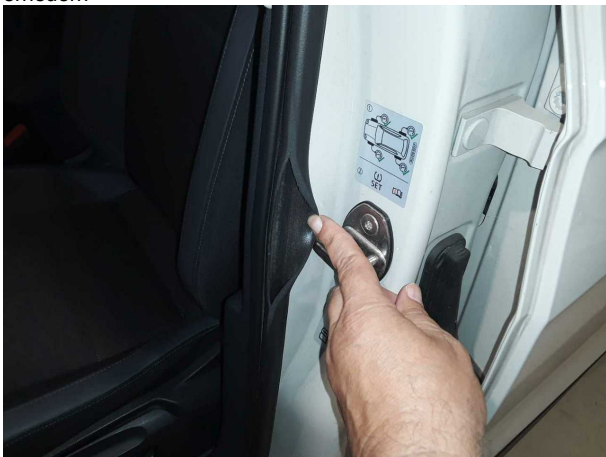
Beschädigung #2: Karosserie: Türdichtung vorn links - gebrochen / gerissen - erneuern
