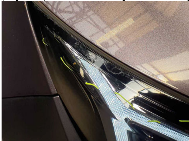
Beschädigung #2: Scheinwerfer: Scheinwerfer rechts (Materialmangel) - abweichend Auslieferungszustand - kein Abzug
