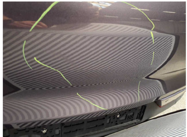
Beschädigung #12: Heckklappe/-tür: Heckklappe (Schleifspuren) - verkratzt / verschürft - lackieren
