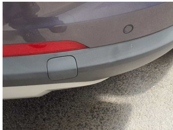
Beschädigung #1: Stossfänger hinten: Stossfänger hinten (unlackiert) (Ausgeblichen) - abweichend Auslieferungszustand -
