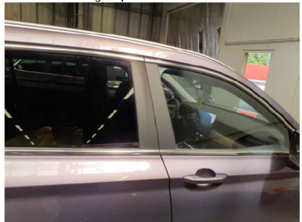
Beschädigung #8: Verkleidungen/Abdeckungen: Zierleiste / Dekorleiste (Tür hinten rechts) - Abrieb - erneuern
