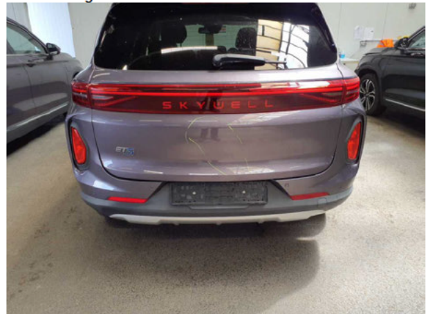
Beschädigung #12: Heckklappe/-tür: Heckklappe (Schleifspuren) - verkratzt / verschürft - lackieren
