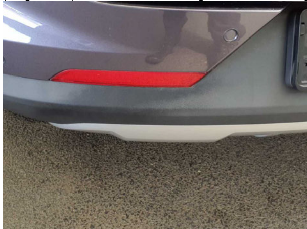
Beschädigung #1: Stossfänger hinten: Stossfänger hinten (unlackiert) (Ausgeblichen) - abweichend Auslieferungszustand - kein Abzug
