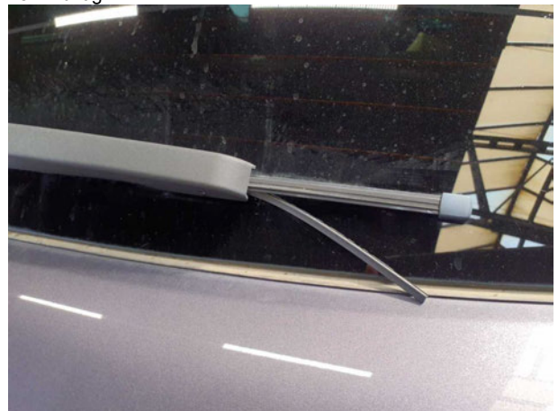
Beschädigung #5: Scheibenreinigung: Scheibenwischerblatt hinten - gebrochen / gerissen - erneuern
