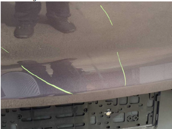
Beschädigung #12: Heckklappe/-tür: Heckklappe (Schleifspuren) - verkratzt / verschürft - lackieren
