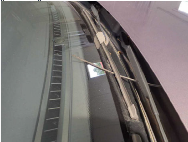
Beschädigung #6: Scheibenreinigung: Scheibenwischerblätter vorn - gebrochen / gerissen - erneuern
