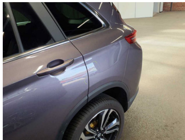
Beschädigung #9: Seitenwand links: Seitenwand - Delle(n) - sanft instandsetzen
