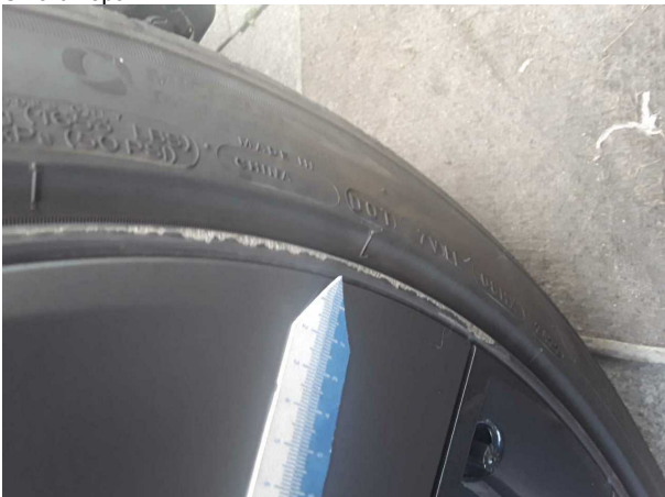
Beschädigung #2: Rad/Reifen: Leichtmetallfelge hinten rechts - Kratzer - erneuern
