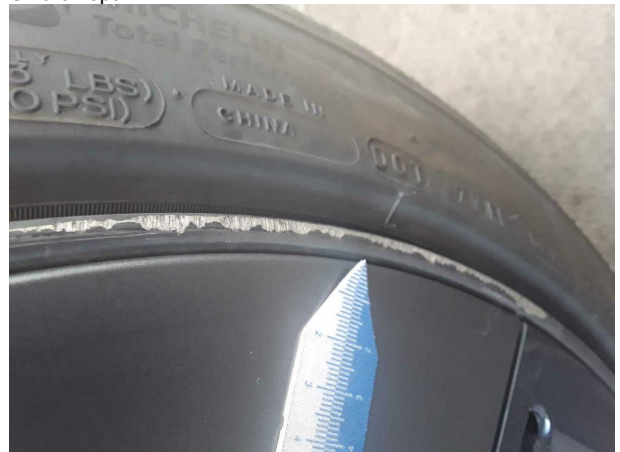
Beschädigung #2: Rad/Reifen: Leichtmetallfelge hinten rechts - Kratzer - erneuern
