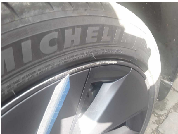
Beschädigung #4: Rad/Reifen: Leichtmetallfelge vorn links - Kratzer - erneuern
