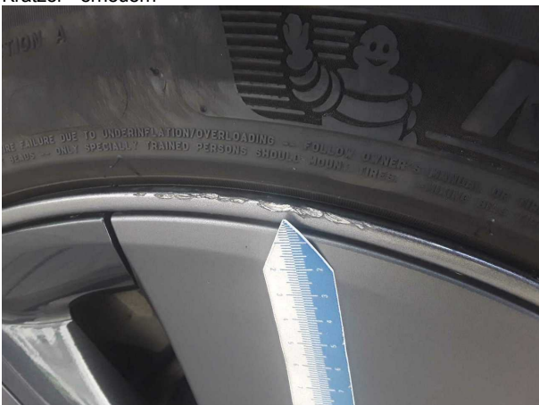
Beschädigung #3: Rad/Reifen: Leichtmetallfelge hinten links - Kratzer - erneuern
