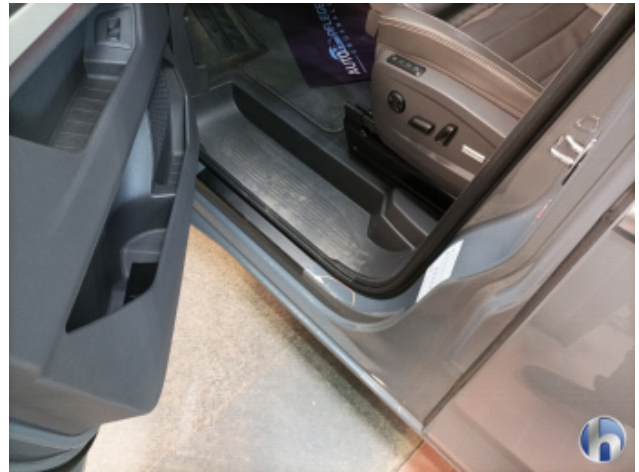
3. Türeinstieg Vorne - Links Kratzer - Smart Repair
