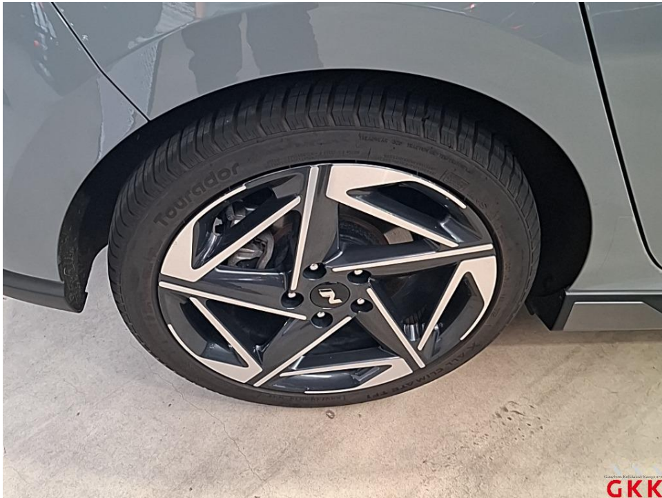
Bild 39. LM-Rad, hinten rechts, Materialabtrag, ersetzen
