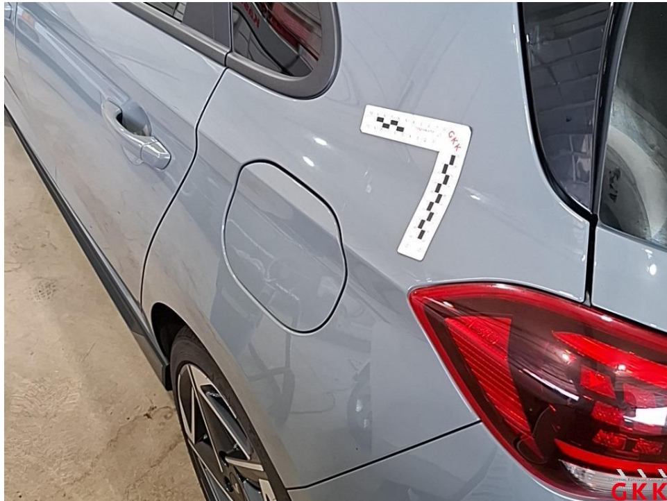
Bild 24. Seitenwand links, beschädigt, instand setzen - lackieren
