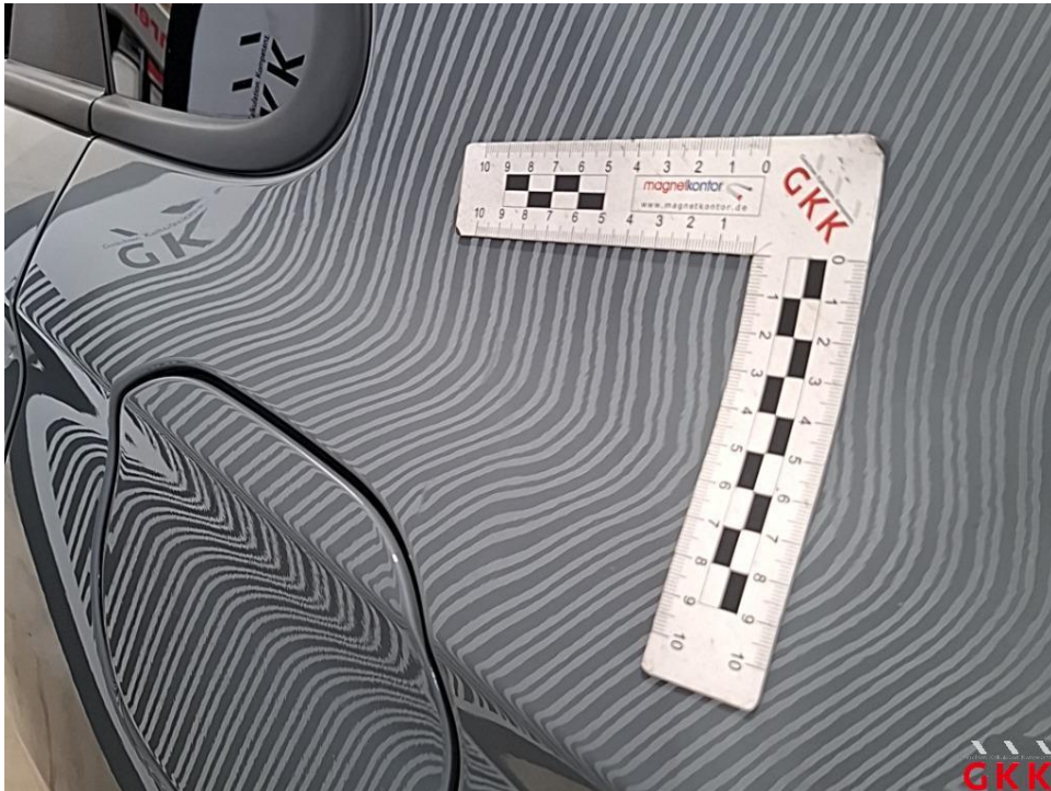
Bild 25. Seitenwand links, beschädigt, instand setzen - lackieren
