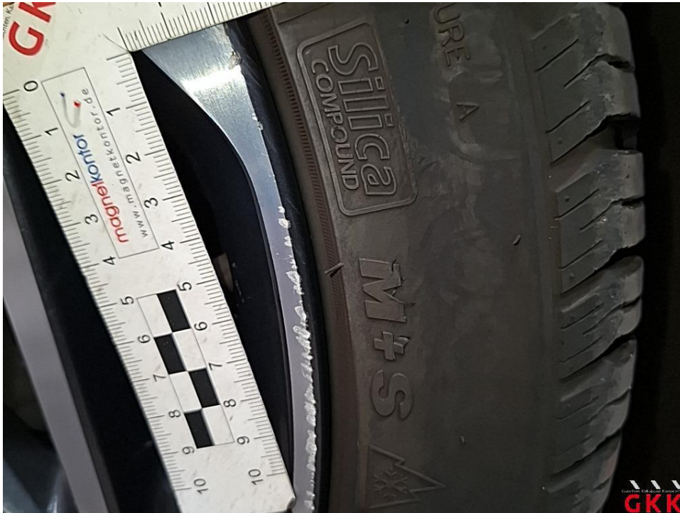
Bild 17. LM-Rad, vorne rechts, Materialabtrag, ersetzen
