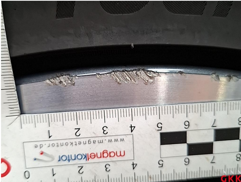
Bild 16. LM-Rad, vorne rechts, Materialabtrag, ersetzen
