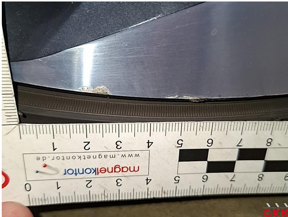
Bild 38. LM-Rad, hinten links, Materialabtrag, ersetzen
