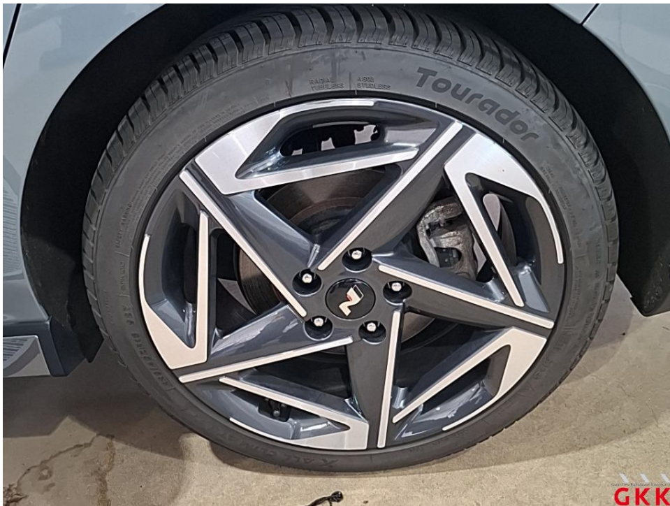
Bild 36. LM-Rad, hinten links, Materialabtrag, ersetzen
