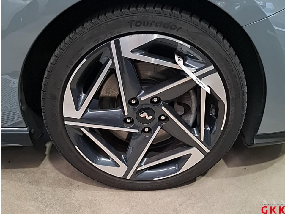
Bild 15. LM-Rad, vorne rechts, Materialabtrag, ersetzen
