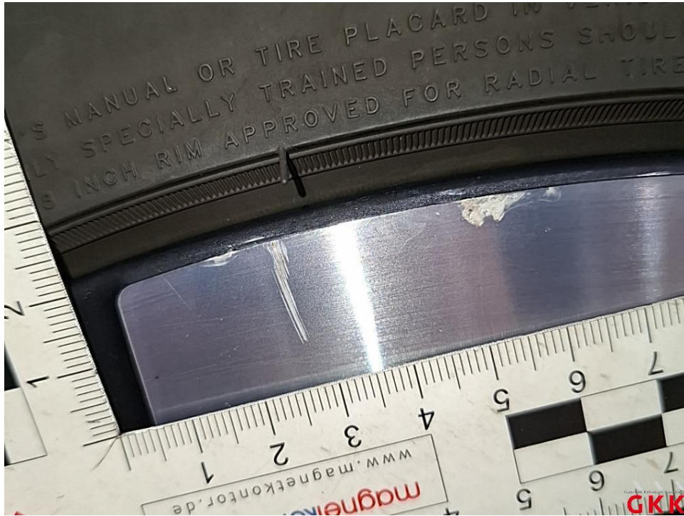
Bild 37. LM-Rad, hinten links, Materialabtrag, ersetzen
