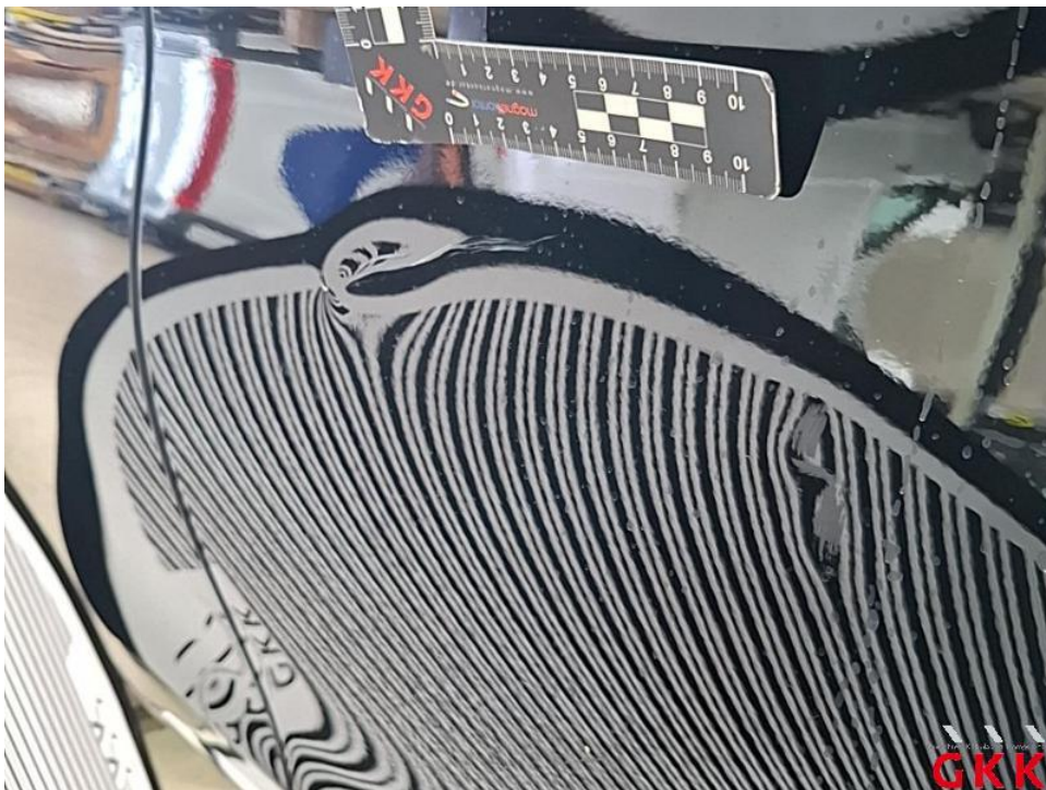
Bild 26. Tür vorne links, beschädigt, ersetzen
