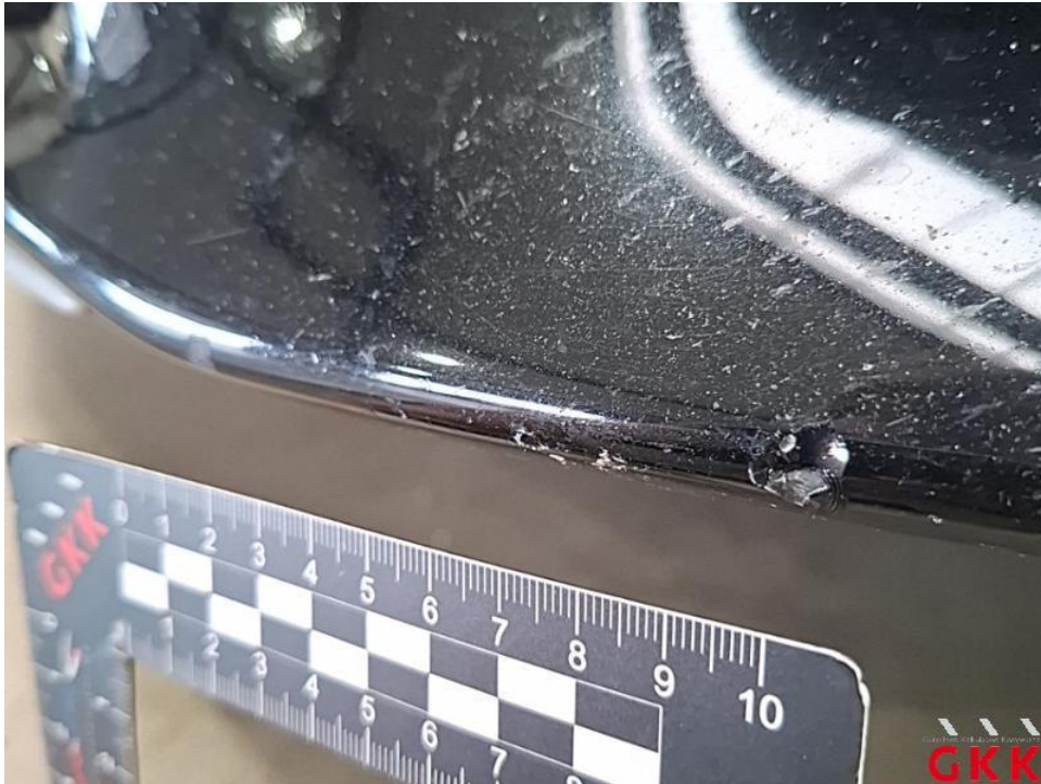
Bild 21. Stoßfänger vorne, Verkleidung -lackiert-, beschädigt, instand setzen - lackieren
