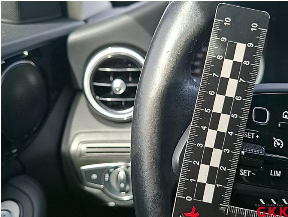
Bild 76. Lenkrad, Leder, beschädigt, ersetzen
