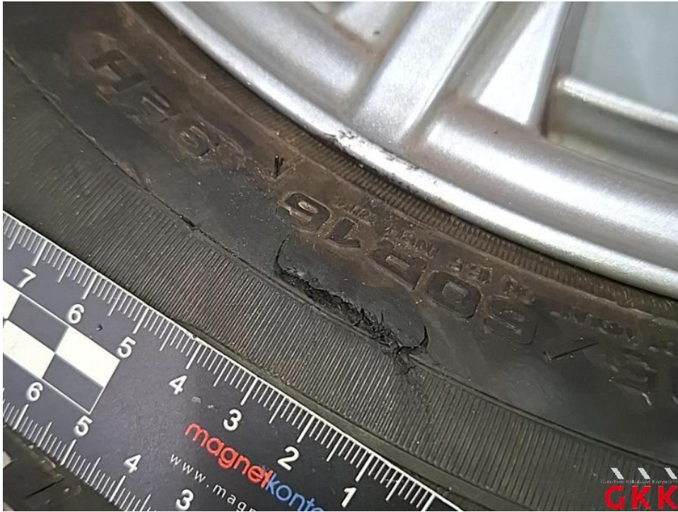
Bild 37. Reifen, 1 x beiliegend, beschädigt, ersetzen
