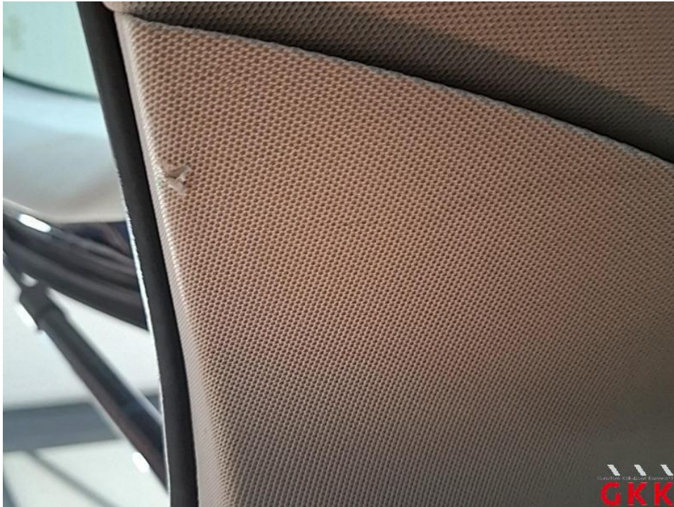
Bild 47. D- Säule links, Innenverkleidung, beschädigt, ersetzen
