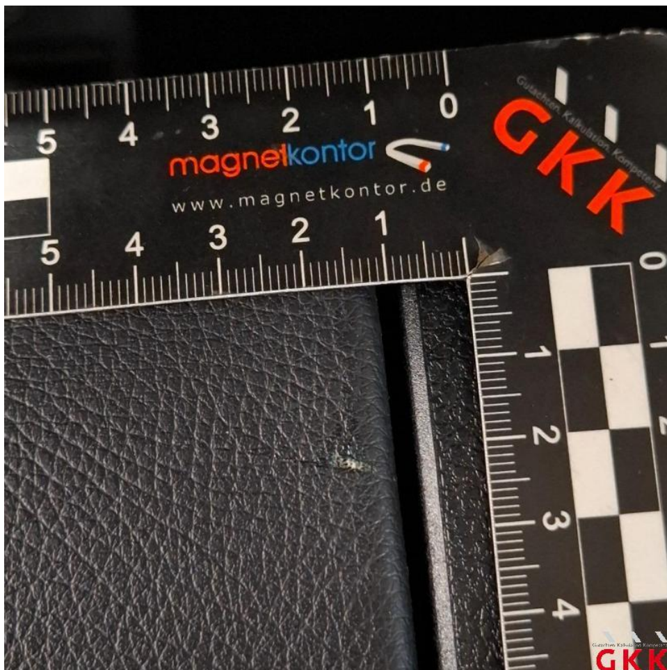
Bild 74. Mittelkonsole, Abdeckung, beschädigt, ersetzen
