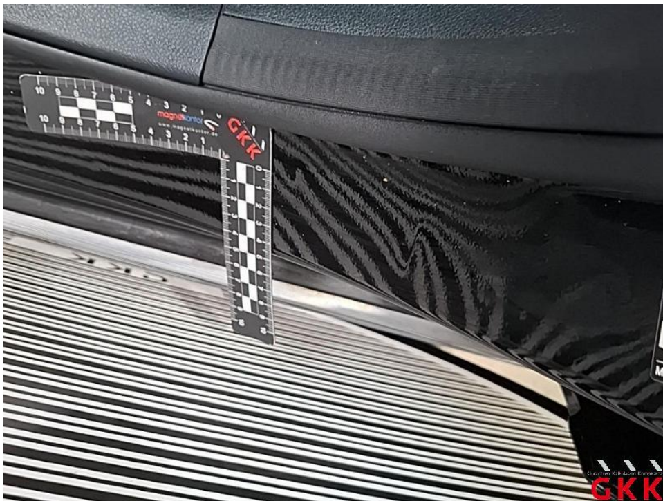
Bild 28. Tür vorne links, Einstieg, beschädigt, instand setzen - lackieren
