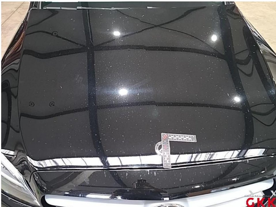
Bild 16. Motorhaube, beschädigt, instand setzen - lackieren
