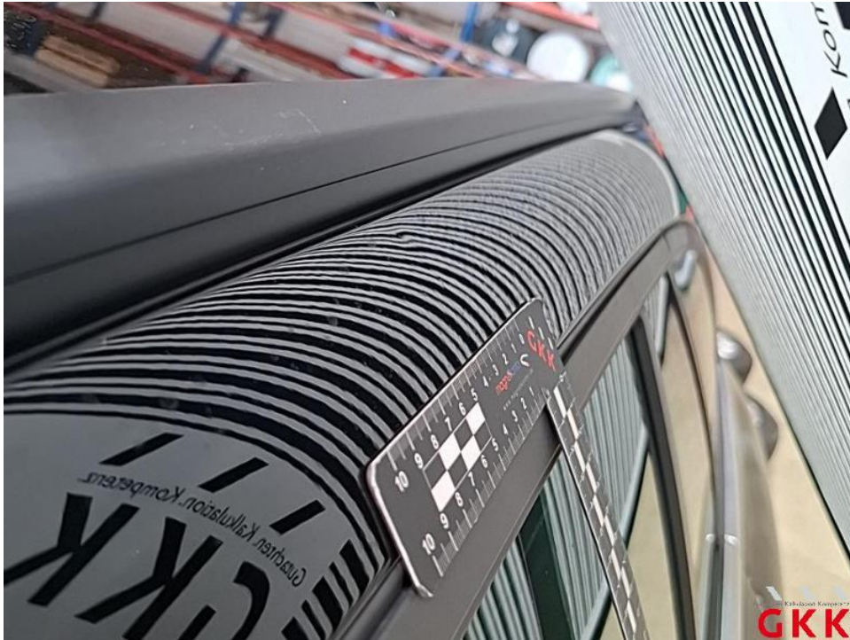
Bild 69. Dachholm links, 4 bis 10 Dellen / Bauteil, Smartrepair
