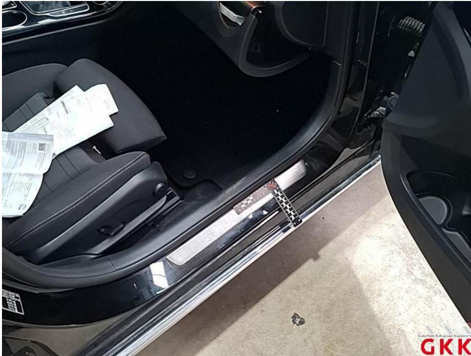
Bild 61. Tür vorne rechts, Einstieg, beschädigt, instand setzen - lackieren
