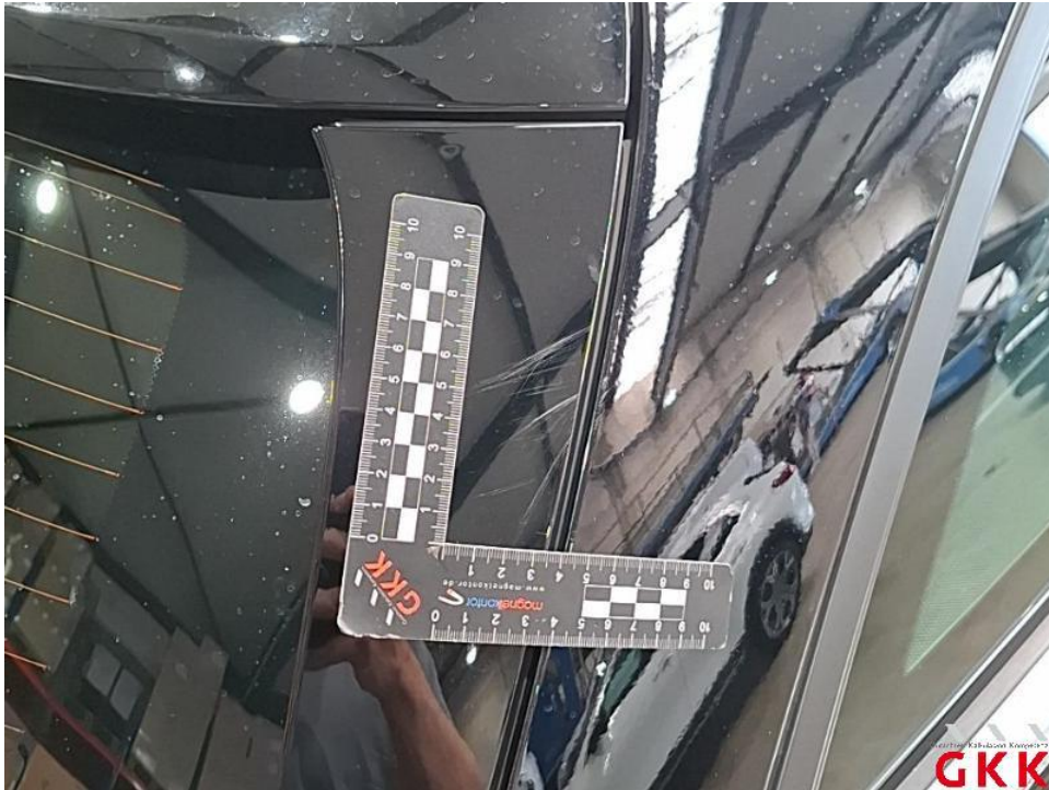
Bild 51. Heckklappe Blende rechts, verkratzt, lackieren
