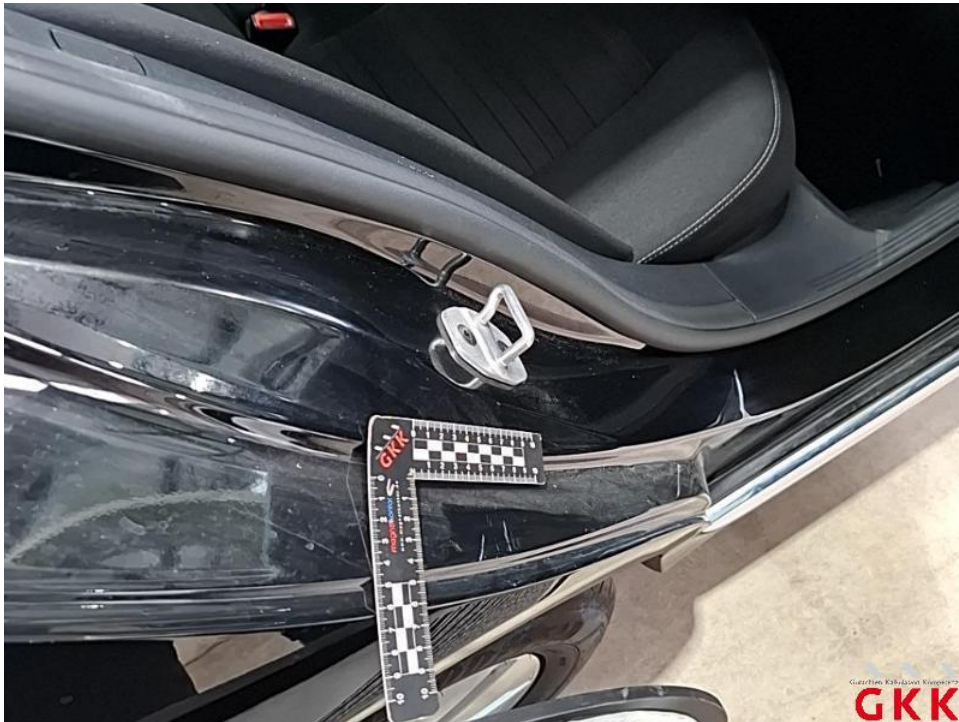
Bild 54. Tür hinten rechts, Einstieg, verkratzt, Smartrepair
