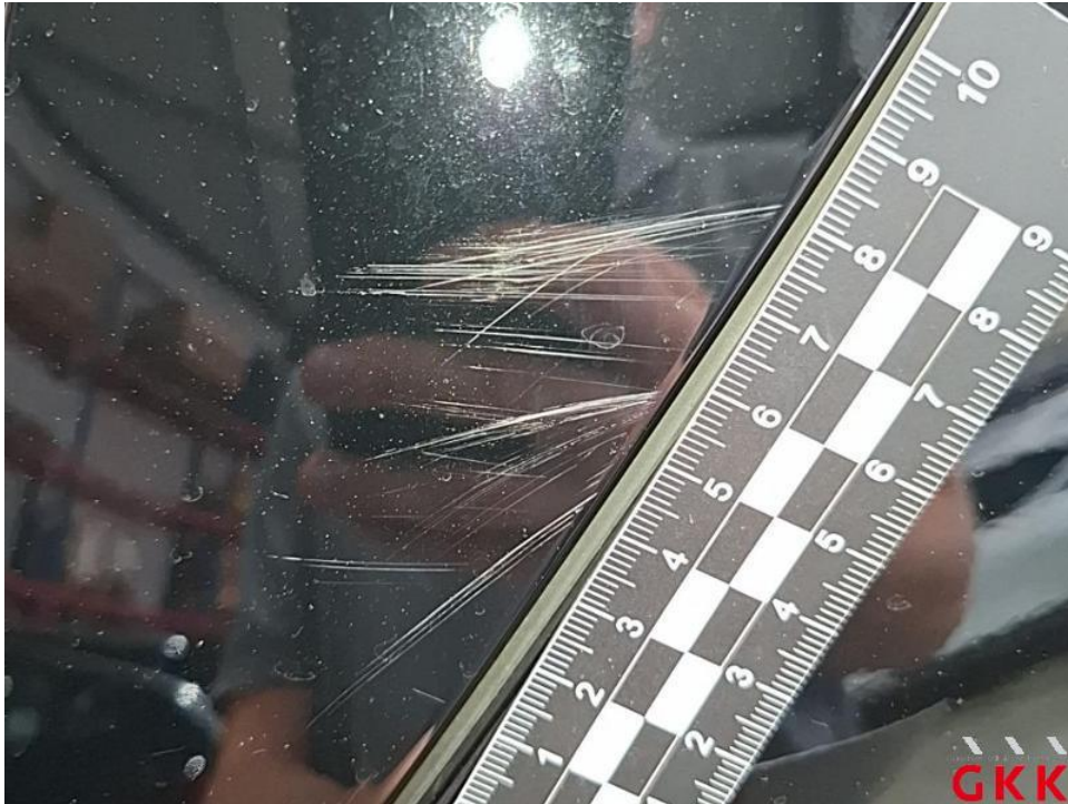
Bild 53. Heckklappe Blende rechts, verkratzt, lackieren
