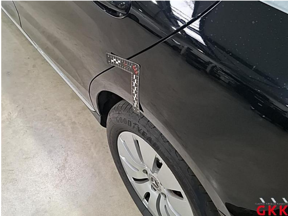
Bild 33. Seitenwand links, bis 3 Dellen / Bauteil, Smartrepair
