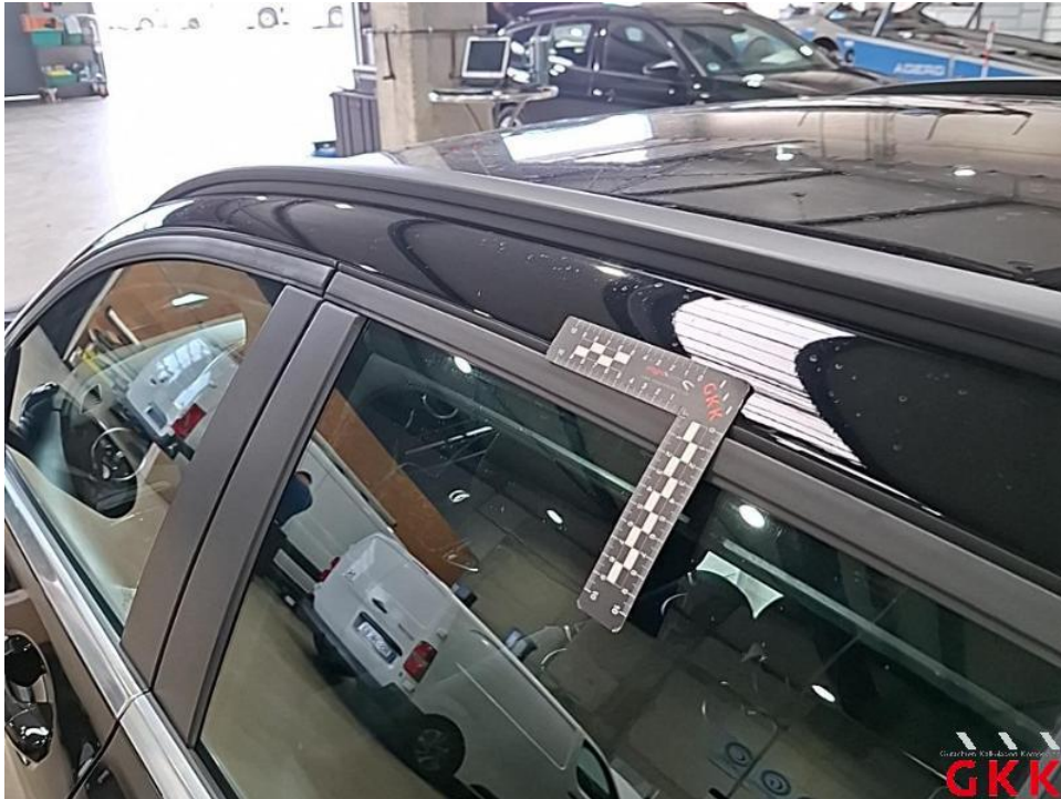
Bild 67. Dachholm links, 4 bis 10 Dellen / Bauteil, Smartrepair
