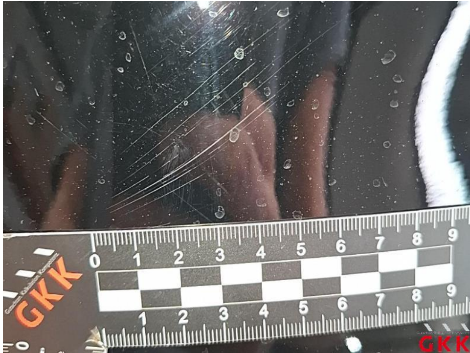
Bild 49. Seitenwand rechts, verkratzt, Smartrepair
