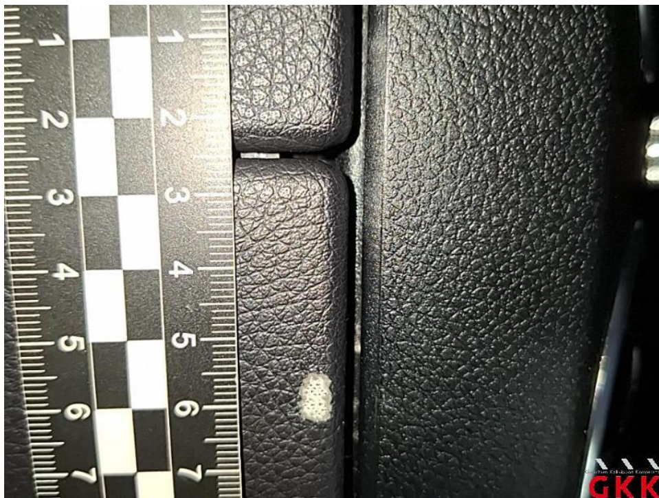
Bild 73. Mittelkonsole, Abdeckung, beschädigt, ersetzen
