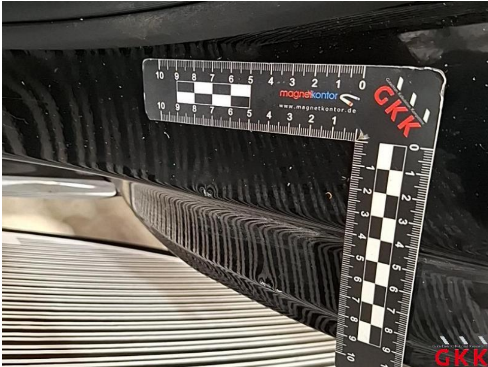
Bild 31. Tür hinten links, Einstieg, beschädigt, instand setzen - lackieren
