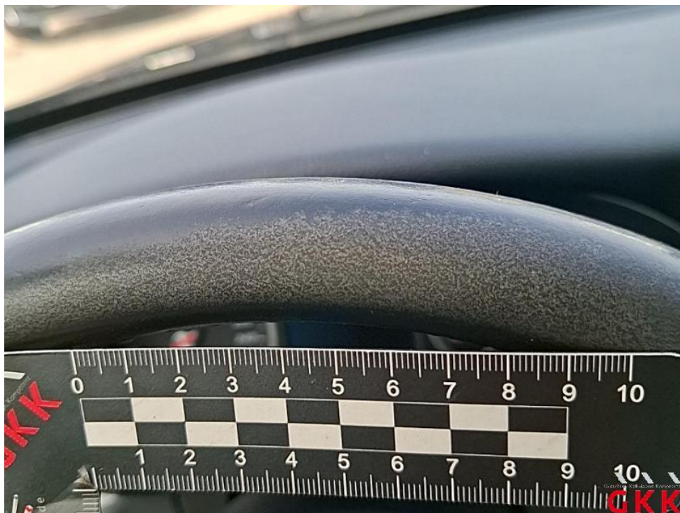
Bild 77. Lenkrad, Leder, beschädigt, ersetzen
