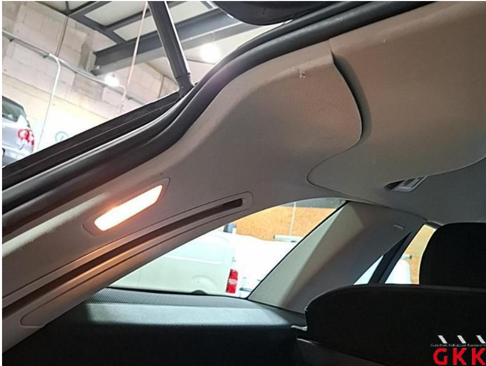
Bild 45. D- Säule links, Innenverkleidung, beschädigt, ersetzen
