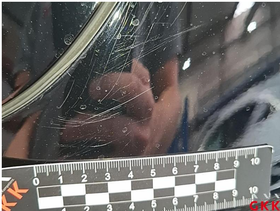
Bild 50. Seitenwand rechts, verkratzt, Smartrepair
