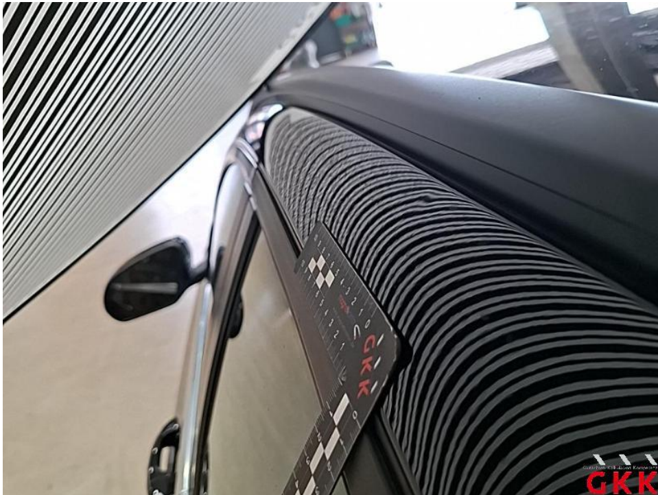
Bild 68. Dachholm links, 4 bis 10 Dellen / Bauteil, Smartrepair
