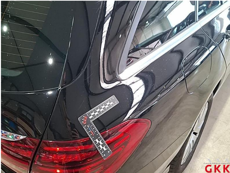
Bild 48. Seitenwand rechts, verkratzt, Smartrepair
