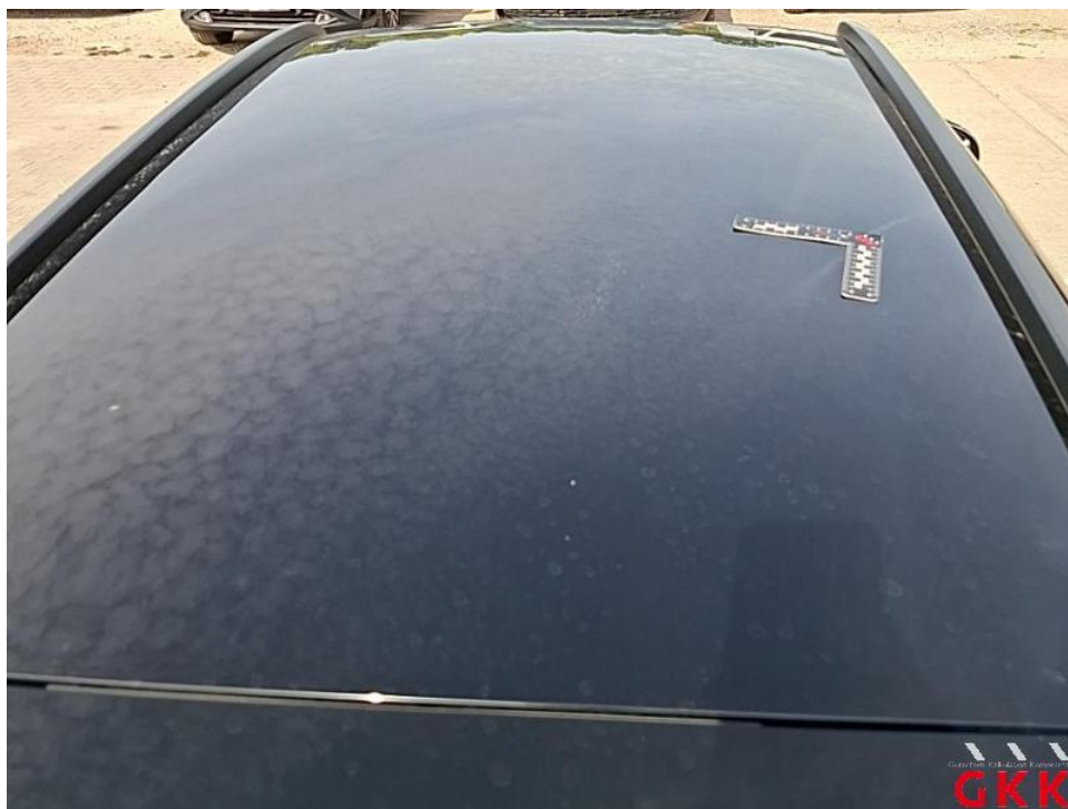
Bild 78. Dach, beschädigt, instand setzen - lackieren
