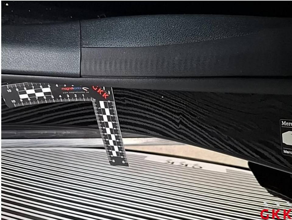
Bild 29. Tür vorne links, Einstieg, beschädigt, instand setzen - lackieren
