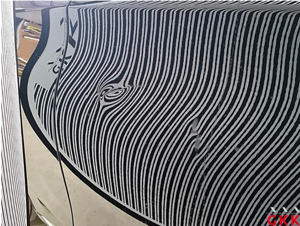
Bild 25. Tür vorne links, beschädigt, ersetzen
