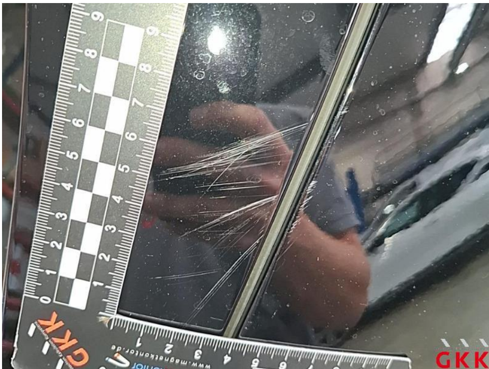
Bild 52. Heckklappe Blende rechts, verkratzt, lackieren
