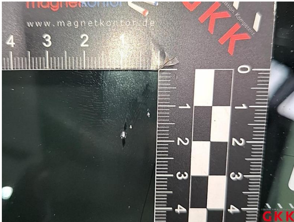
Bild 23. Frontscheibe, mit Regensensor und Frontkamera, Steinschlag im Sichtfeld, ersetzen
