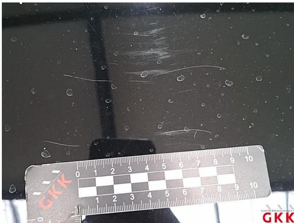
Bild 18. Motorhaube, beschädigt, instand setzen - lackieren
