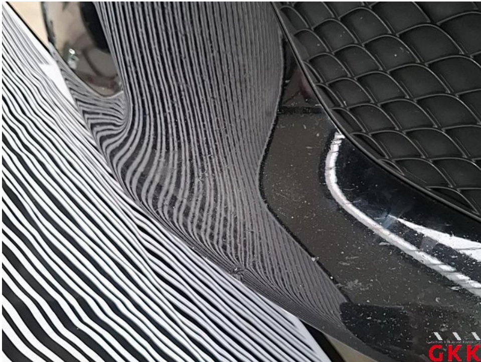
Bild 20. Stoßfänger vorne, Verkleidung -lackiert-, beschädigt, instand setzen - lackieren
