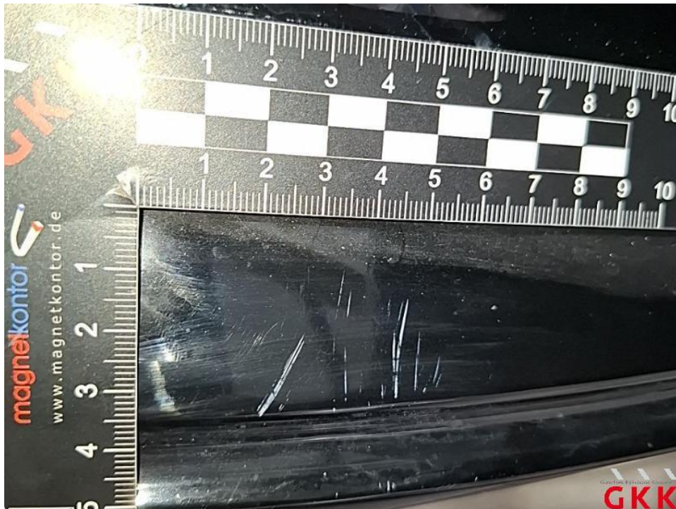
Bild 55. Tür hinten rechts, Einstieg, verkratzt, Smartrepair
