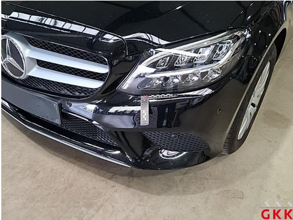
Bild 19. Stoßfänger vorne, Verkleidung -lackiert-, beschädigt, instand setzen - lackieren
