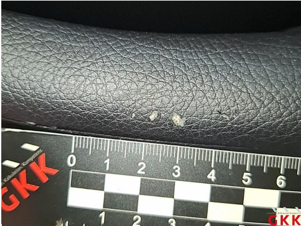
Bild 57. Tür hinten rechts, Innenverkleidung -Abdeckung-, beschädigt, ersetzen
