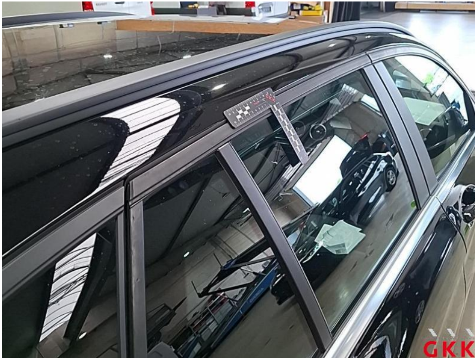
Bild 64. Dachholm rechts, 4 bis 10 Dellen / Bauteil, Smartrepair
