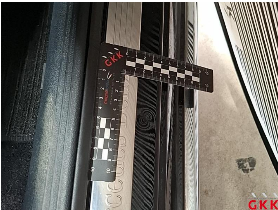
Bild 62. Tür vorne rechts, Einstieg, beschädigt, instand setzen - lackieren
