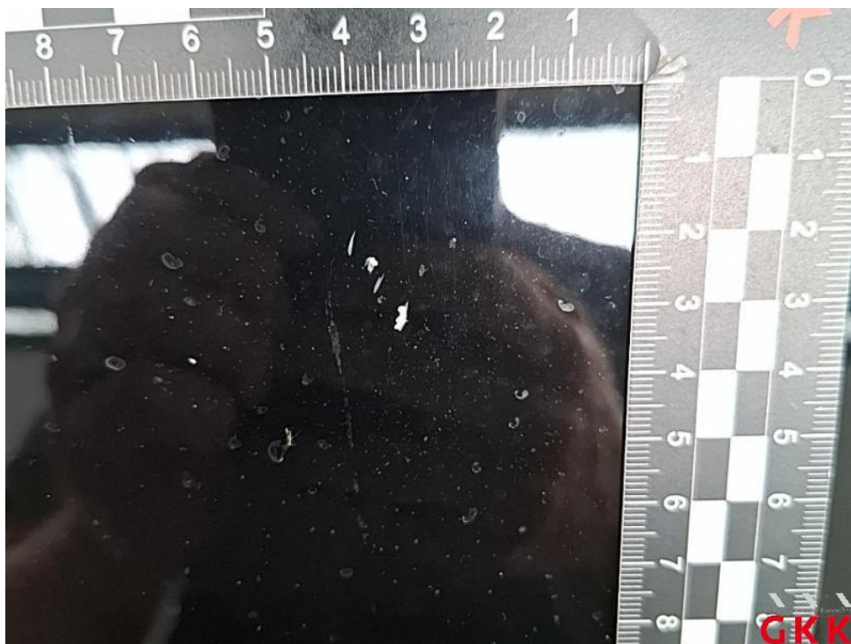
Bild 17. Motorhaube, beschädigt, instand setzen - lackieren
