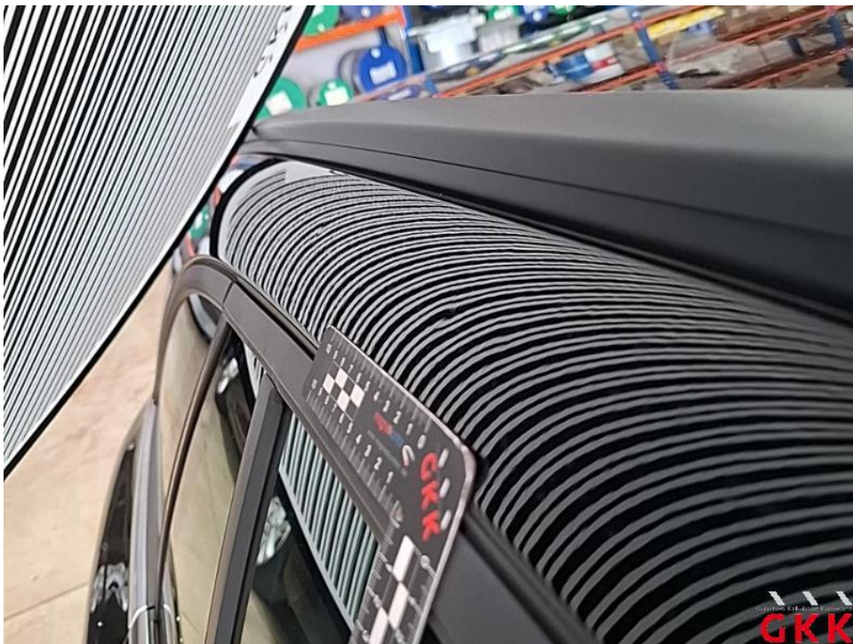
Bild 66. Dachholm rechts, 4 bis 10 Dellen / Bauteil, Smartrepair
