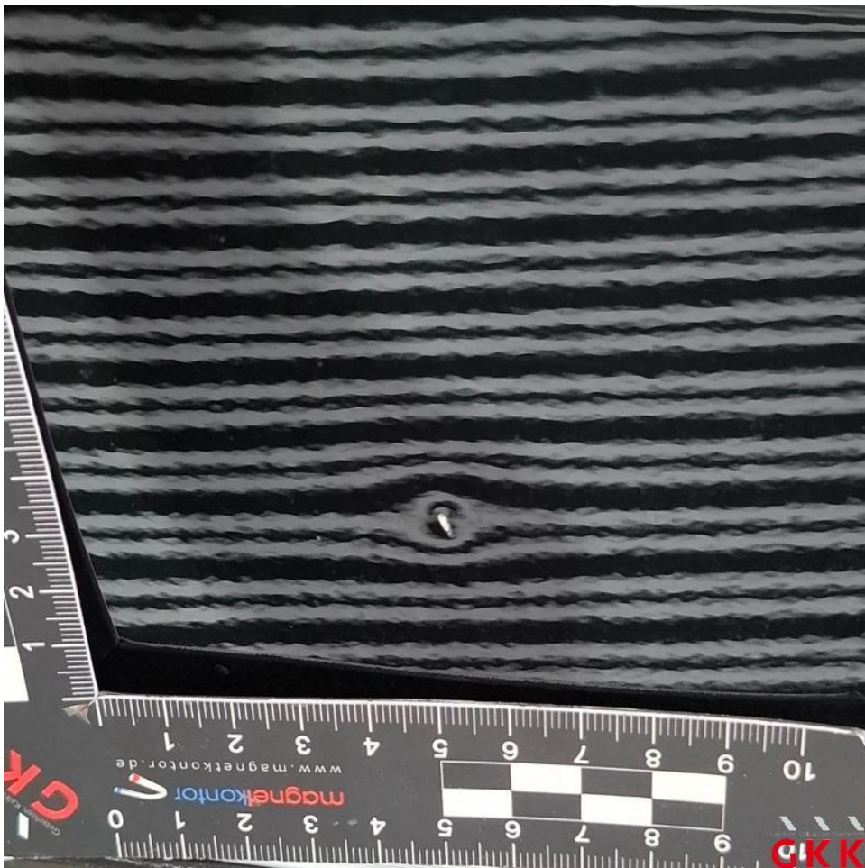
Bild 60. Tür hinten rechts, bis 3 Dellen / Bauteil, Smartrepair
