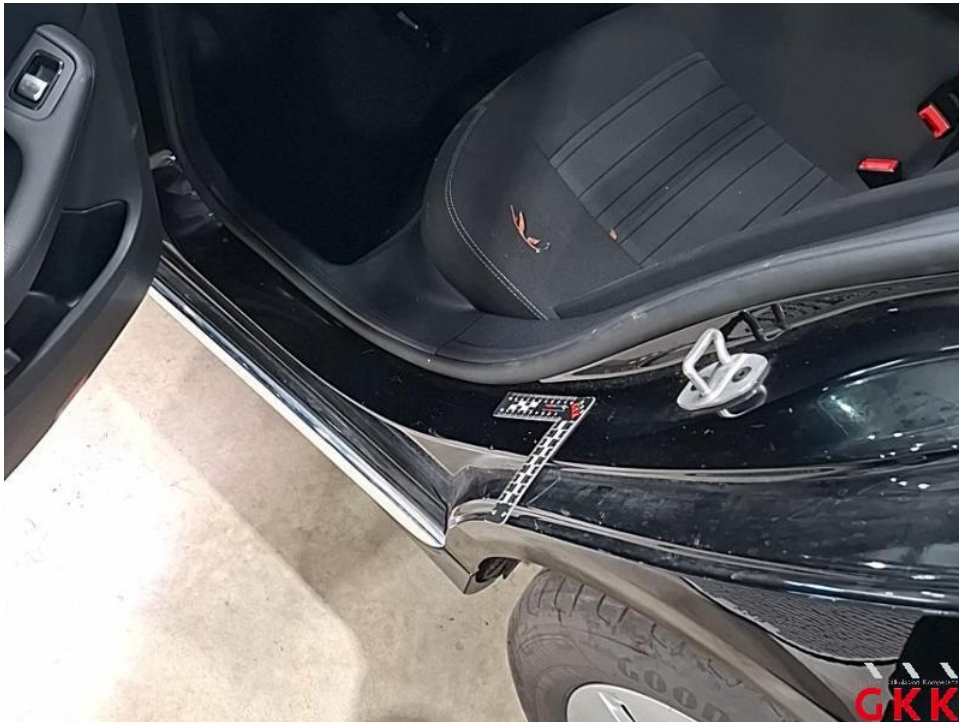
Bild 30. Tür hinten links, Einstieg, beschädigt, instand setzen - lackieren
