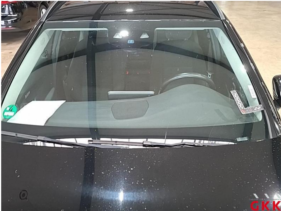
Bild 22. Frontscheibe, mit Regensensor und Frontkamera, Steinschlag im Sichtfeld, ersetzen
