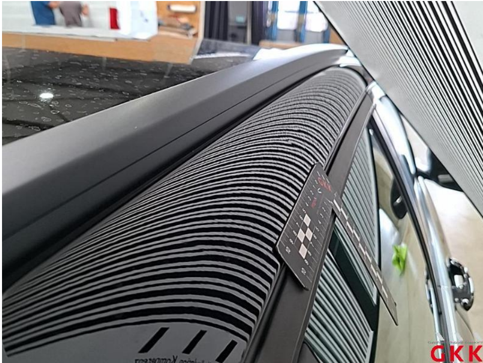
Bild 65. Dachholm rechts, 4 bis 10 Dellen / Bauteil, Smartrepair
