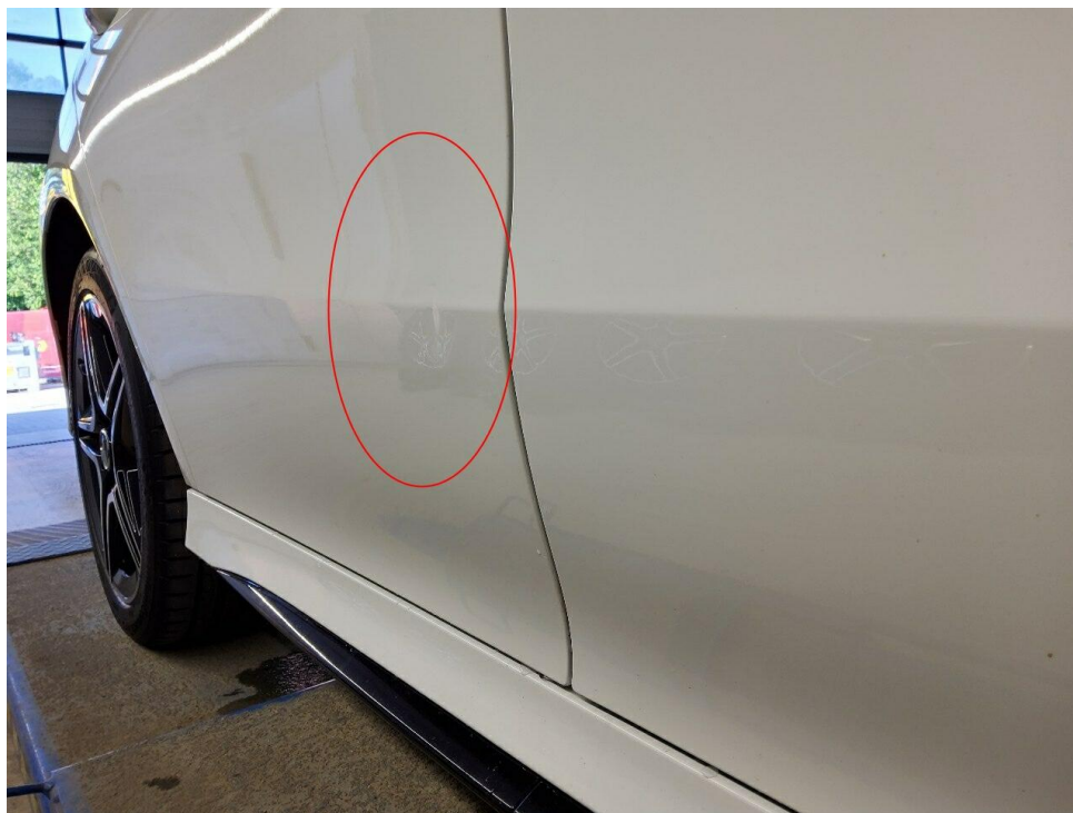
Bild 20 : Tür hinten rechts, eingedellt, verschrammt
