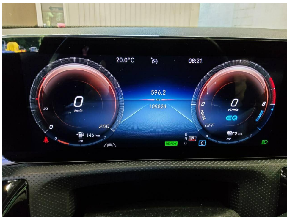
Bild 6 : Kombiinstrument (betriebsbereit) mit Km-Stand
