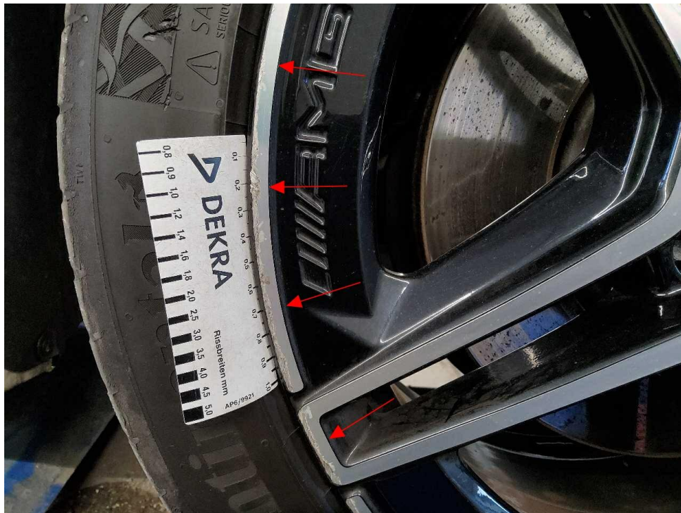
Bild 31 : LM-Felge vorne rechts (Sommer), glanzgedreht, verschrammt
