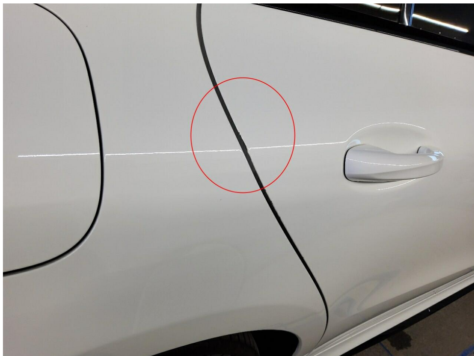
Bild 22 : Tür hinten rechts, eingedellt, verschrammt
