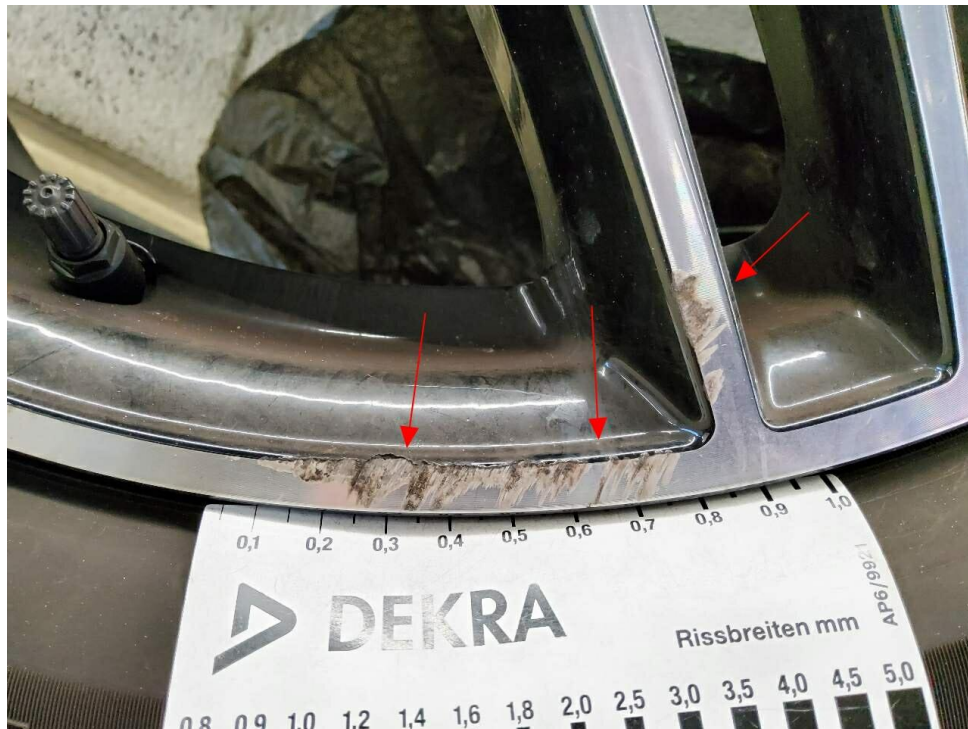
Bild 35 : LM-Felge vorne links (Winter), glanzgedreht, verschrammt
