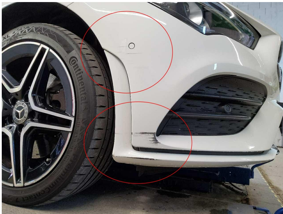
Bild 17 : Schaden Stoßfänger vorne rechts
