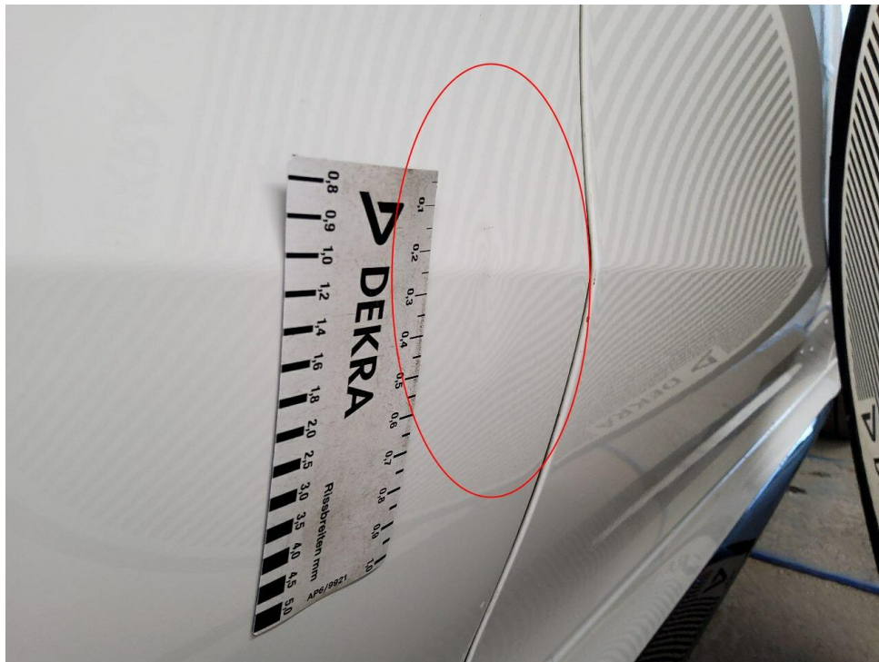
Bild 21 : Tür hinten rechts, eingedellt, verschrammt
