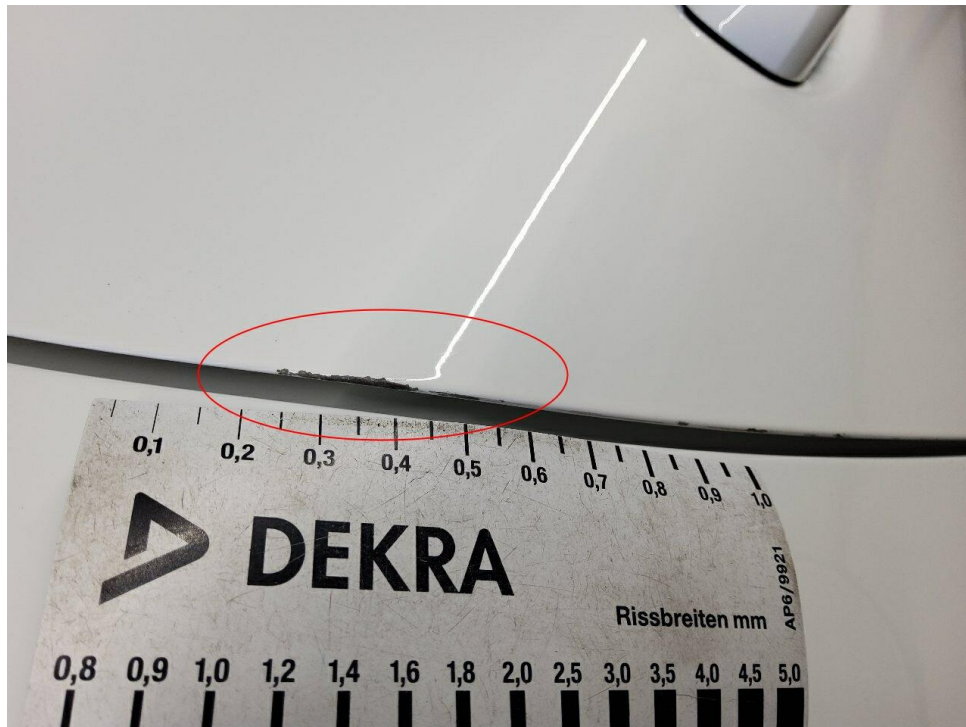
Bild 23 : Tür hinten rechts, eingedellt, verschrammt
