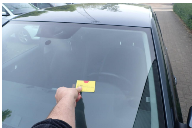
Beschädigung 4: Verglasung: Frontscheibe - Steinschlag - erneuern
