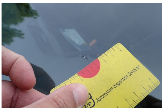
Beschädigung 4: Verglasung: Frontscheibe - Steinschlag - erneuern
