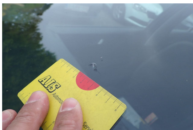
Beschädigung 4: Verglasung: Frontscheibe - Steinschlag - erneuern
