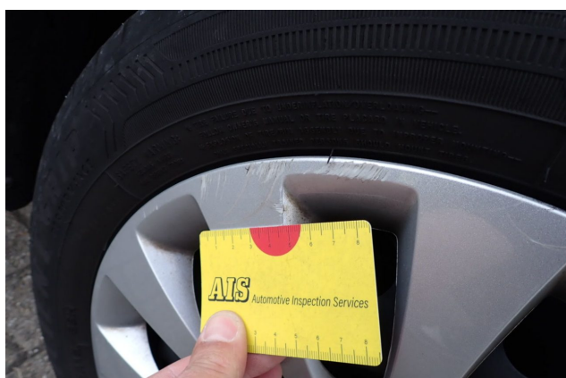
Beschädigung 2: Rad/Reifen: Radblende vorn rechts - verkratzt / verschürft - erneuern
