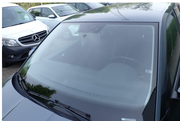
Beschädigung 4: Verglasung: Frontscheibe - Steinschlag - erneuern
